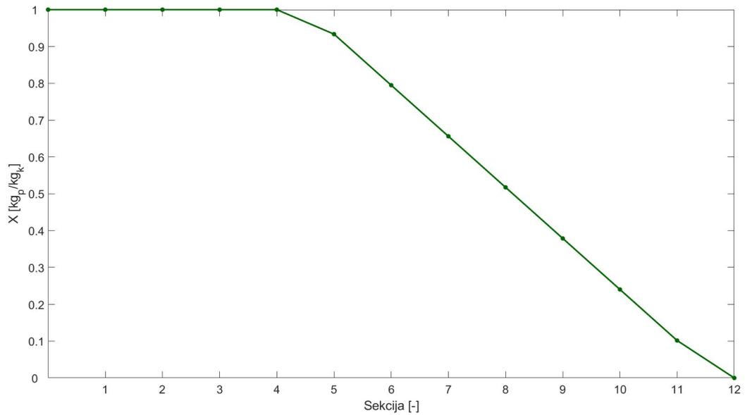
Slika 3.17: Udio pare po sekcijama kondenzatora
