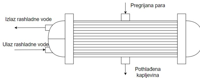
Slika 2.9: Shema kondenzatora s cijevima u plaštu
