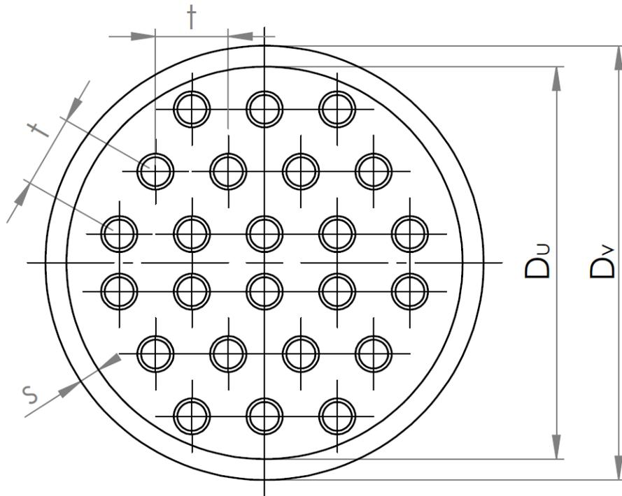
Slika 2.10: Raspored cijevi kondenzatora
