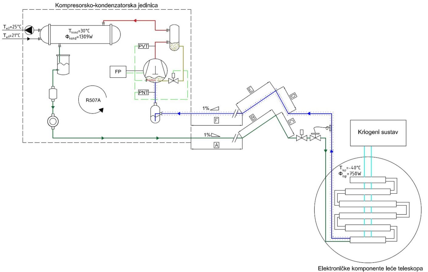
Slika 2.3: Shema sustava s prikazanim dionicama cjevovoda
