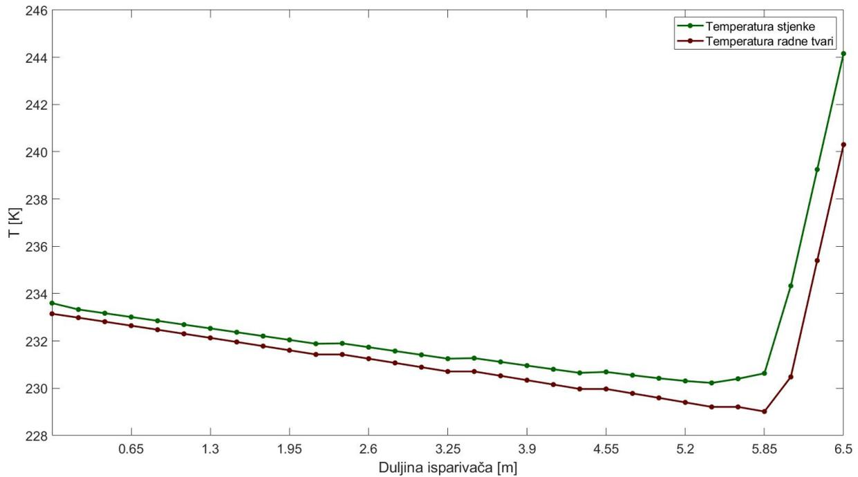
Slika 3.11: Temperature stjenke i radne tvari po duljini isparivača
