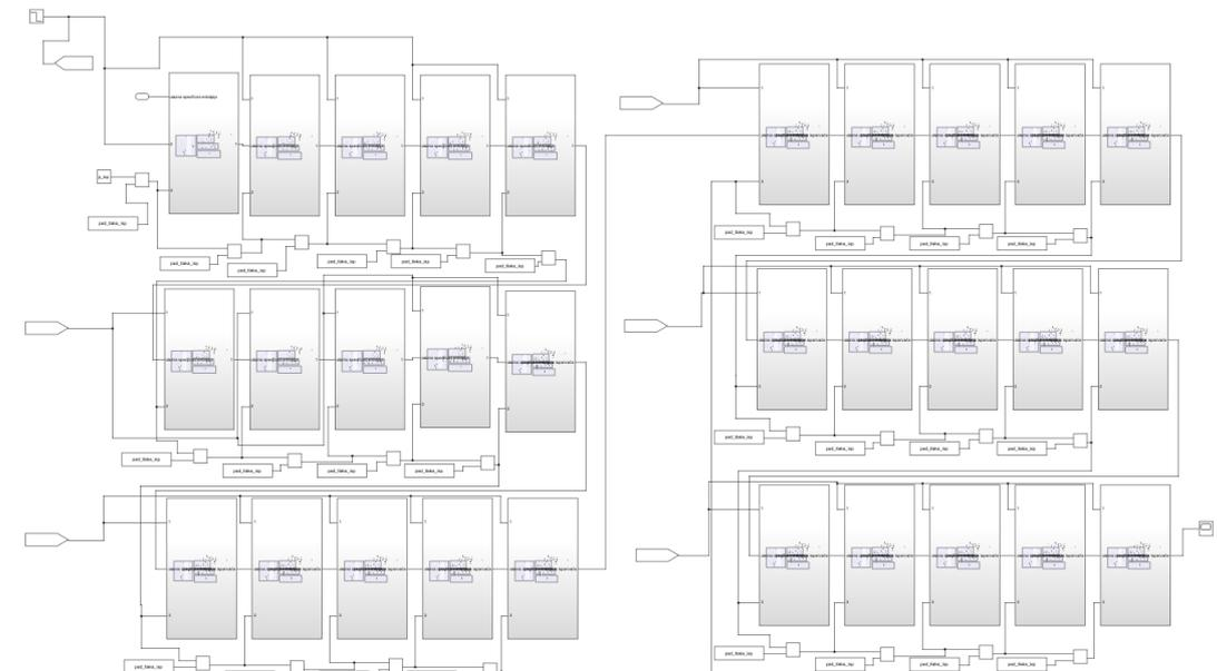
Slika 3.3: Shema isparivača podjeljenog na 30 sekcija
