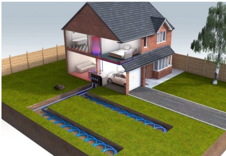
Slika 7. Horizontalno polaganje izmjenjivača topline [9]
