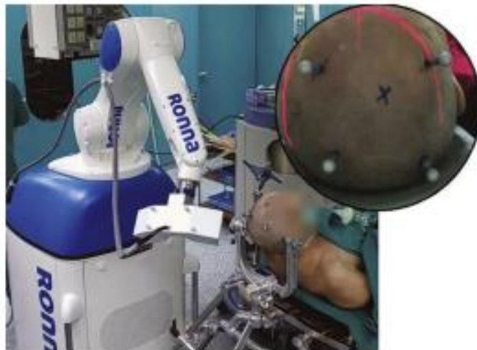
Slika 4. Automatska lokalizacija pacijenta stereovizijskim sustavom RONNAstereo [4]
