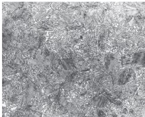
**Slika 12. Mikrostruktura C105U visokougljičnog čelika [12]**
