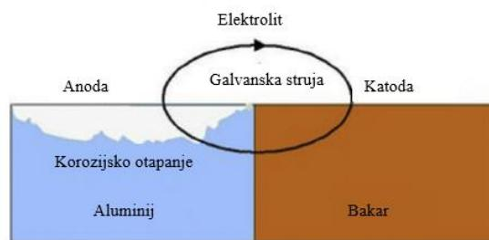
**Slika 4. Shematski prikaz galvanske korozije na primjeru aluminija i bakra [6]**
