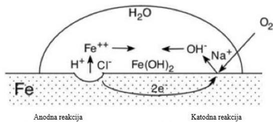
Slika 2. Shematski prikaz anodne i katodne reakcije [3]
