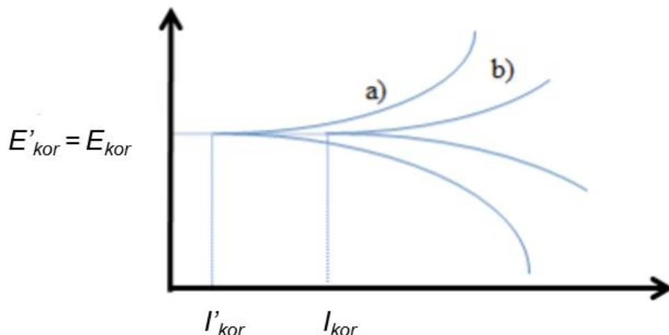
Slika 17. Dijagram kvazi-potenciodinamičke polarizacije a) s primjenom mješovitog inhibitora i
