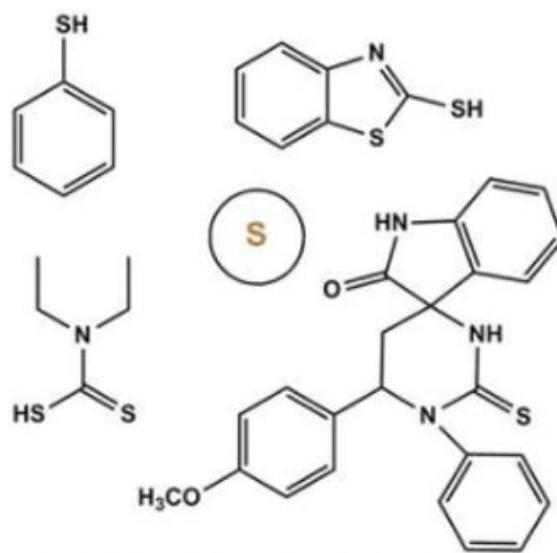
Slika 21. Molekule organskih inhibitora korozije koje sadrže sumpor [26]
