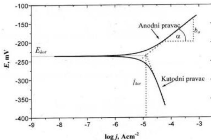
Slika 25. Određivanje gustoće korozijske struje Tafelovom ekstrapolacijom [38]
