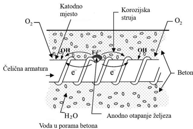
**Slika 14. Shematski prikaz korozije čelične armature u betonu [21]**
