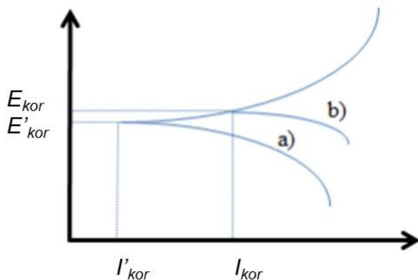
Slika 16. Dijagram kvazi-potenciodinamičke polarizacije a) s primjenom katodnog inhibitora i
