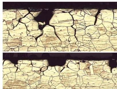
**Slika 7. Propagacija korozije duž kristalnih zrna [8]**
