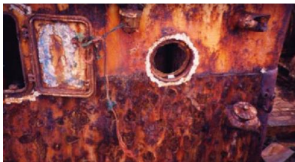
Slika 3. Opća korozija dijela broda [5]
