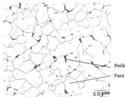
**Slika 10. Mikrostruktura niskougljičnog čelika C10E [12]**
