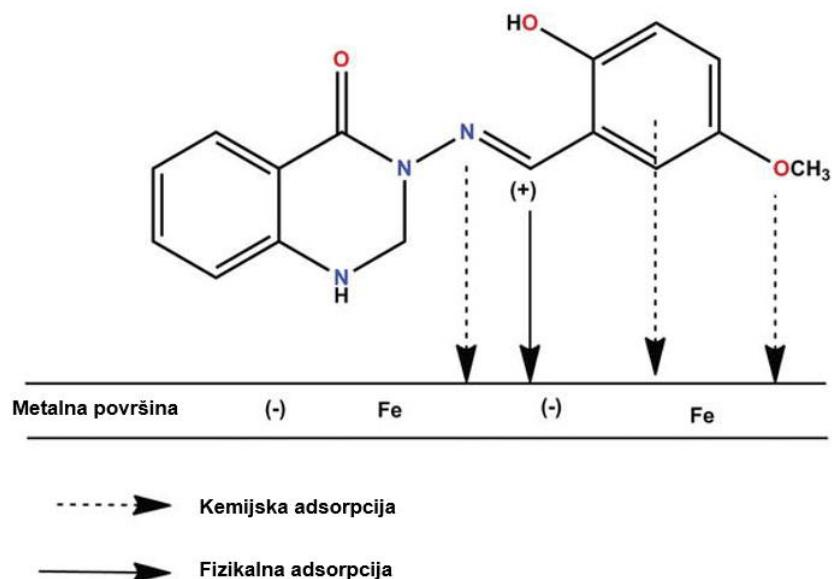
Slika 18. Adsorpcija organske molekule inhibitora na metalnoj površini [26]
