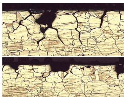
Slika 7. Propagacija korozije duž kristalnih zrna [8]
