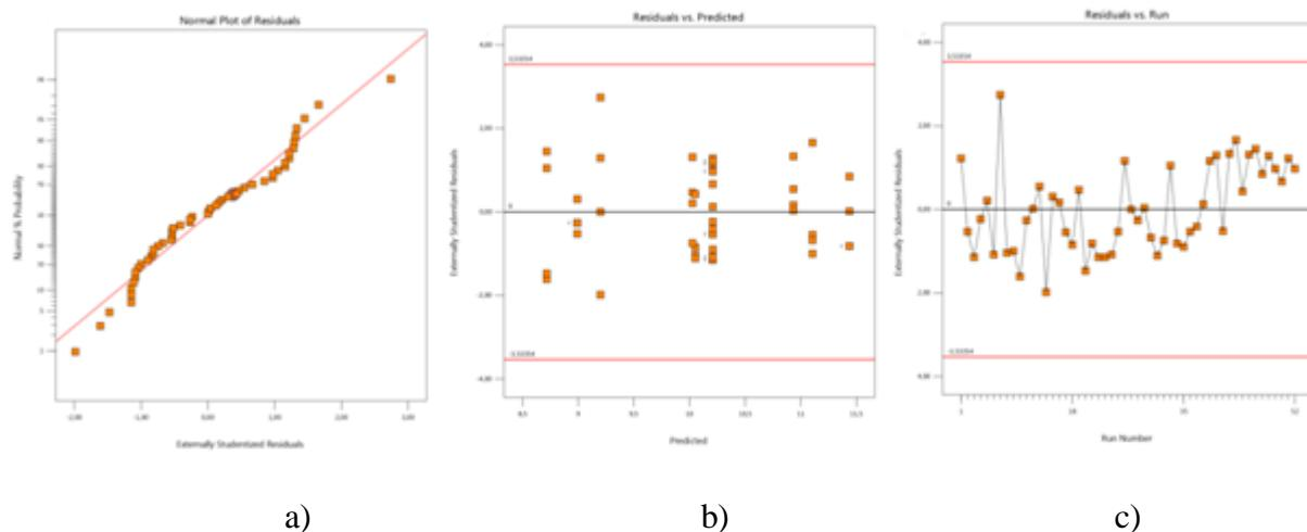
**Slika 45.** a) Normalizirani papir vjerojatnosti ostataka, b) Slučajno rasipanje ostataka u odnosu na modelom izračunate vrijednosti, c) Slučajno rasipanje ostataka u odnosu na redoslijed izvođenja pokusa
