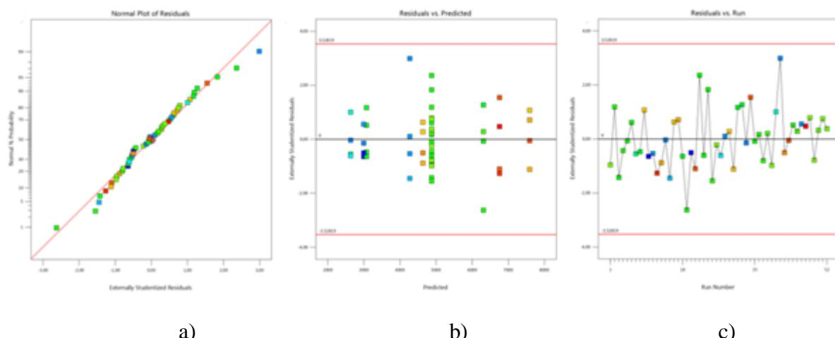
**Slika 42.** a) Normalizirani papir vjerojatnosti ostataka, b) Slučajno rasipanje ostataka u odnosu na modelom izračunate vrijednosti, c) Slučajno rasipanje ostataka u odnosu na redoslijed izvođenja pokusa
