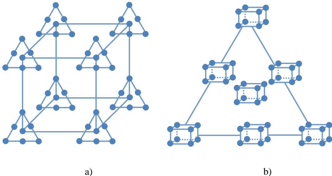
**Slika 19.** a) Elementarni model s težištem na svakoj točki faktorskog plana pokusa  $2^3$ , b)  $2^3$  faktorski plan pokusa na svakoj točki elementarnog modela s težištem [3]
