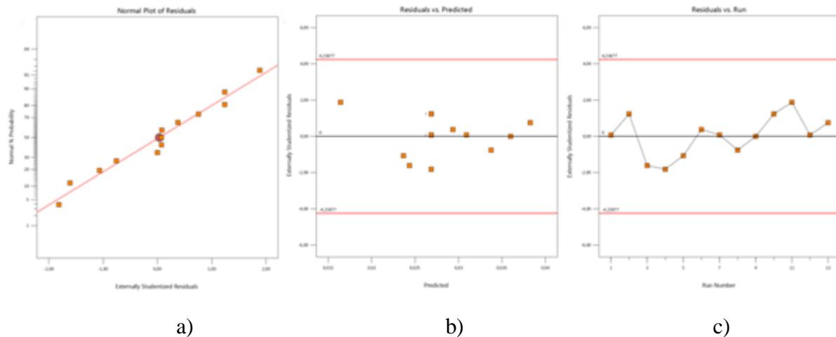
**Slika 35.** a) Normaliziranim papirom vjerojatnosti ostataka, b) Slučajno rasipanje ostataka u odnosu na modelom izračunate vrijednosti, c) Slučajno rasipanje ostataka u odnosu na redoslijed izvođenja pokusa
