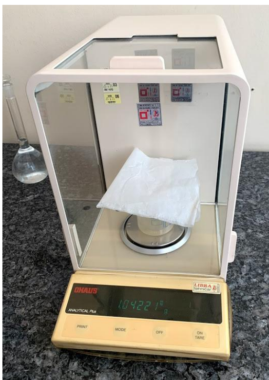
Slika 12. Mjerenje mase polietilenske podloge na analitičkoj vagi
