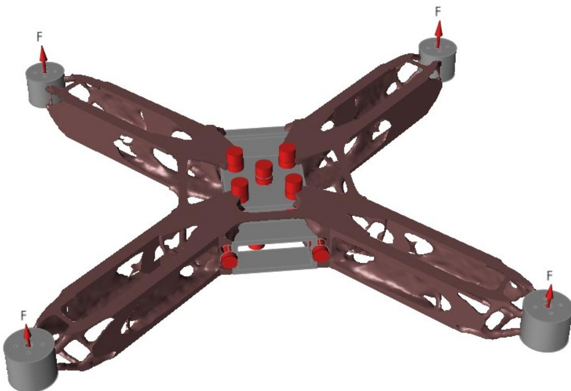
Slika 52. Topološki optimirana jednodijelna konstrukcija drona
