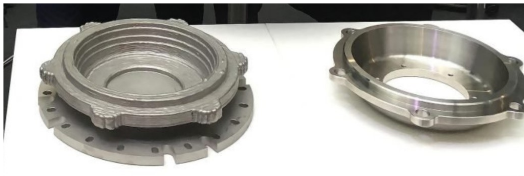
Slika 19. Dodatno proizvedeni poklopac ležaja u kotačima za lokomotivu klase 294, proizveden na sustavu Gefertec arc605 [38]
