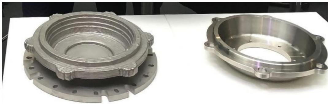
Slika 19. Dodatno proizvedeni poklopac ležaja u kotačima za lokomotivu klase 294, proizведен na sustavu Gefertec arc605 [38]
