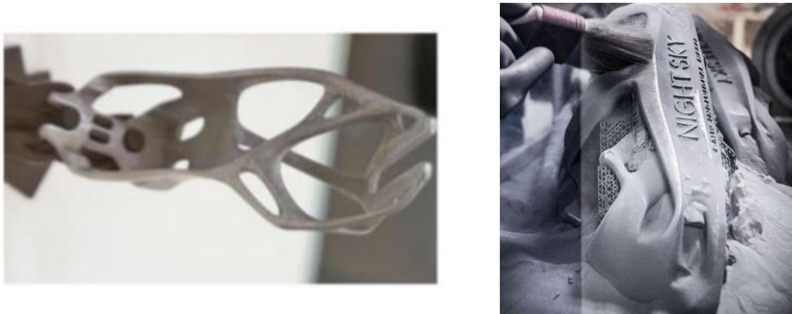
**Slika 22. Aditivno proizveden nosač krova na modelu i8 [45] i kociona čeljust na modelu M850i [46]**
