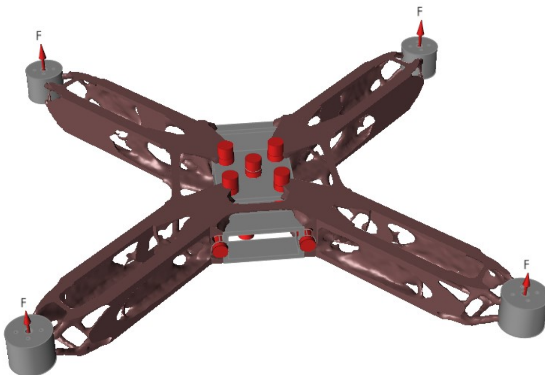
Slika 52. Topološki optimirana jednodijelna konstrukcija drona
