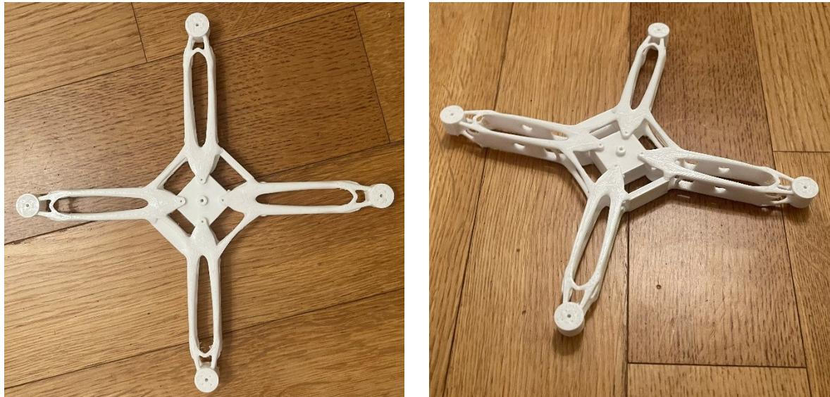
**Slika 54. Umanjeni model jednodijelne topološki optimirane konstrukcije drona**
