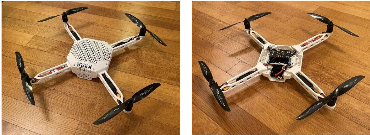
Kompletan sklop nove konstrukcije drona
