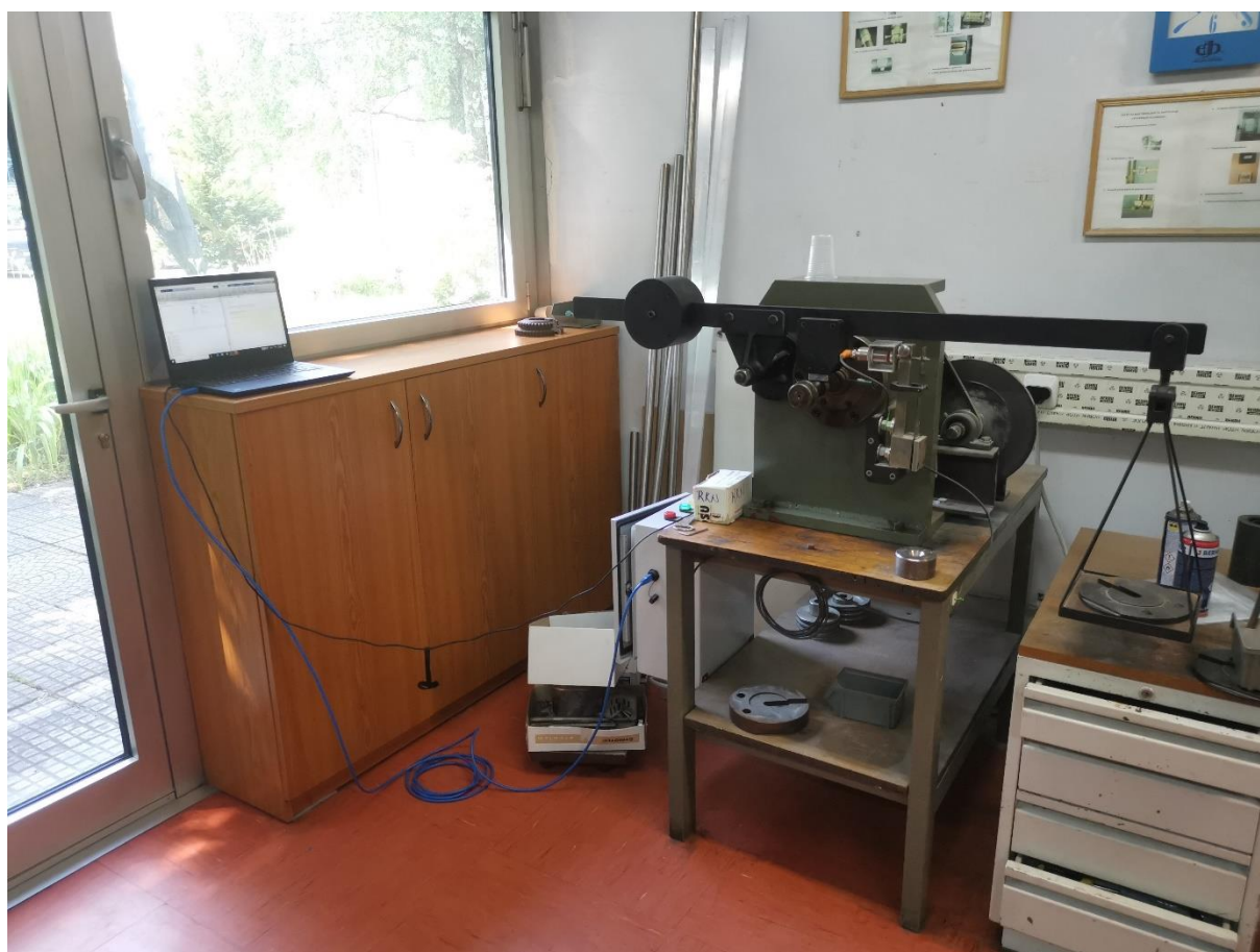
Slika 17. Automatizirani uređaj za ispitivanje „block on ring“
