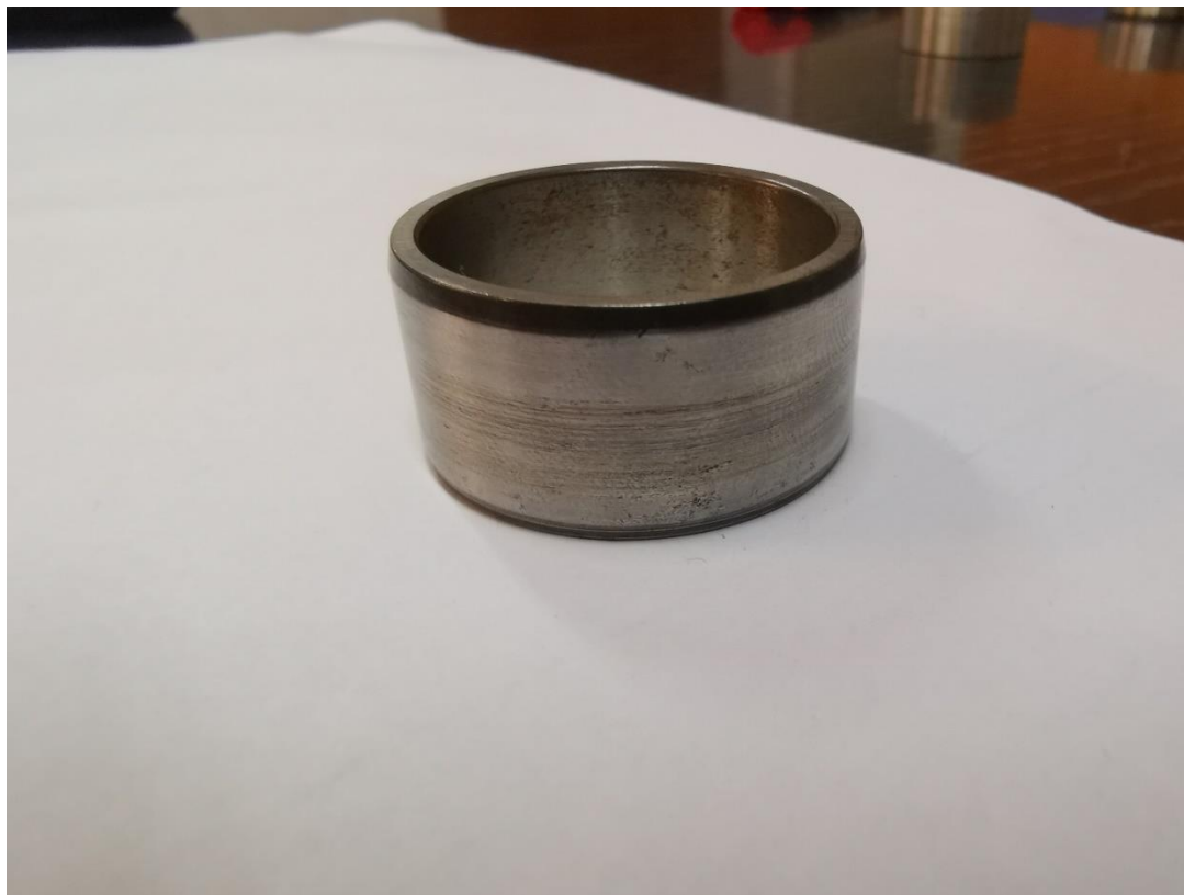
Slika 23. Prsten nakon ispitivanja u suhom stanju
