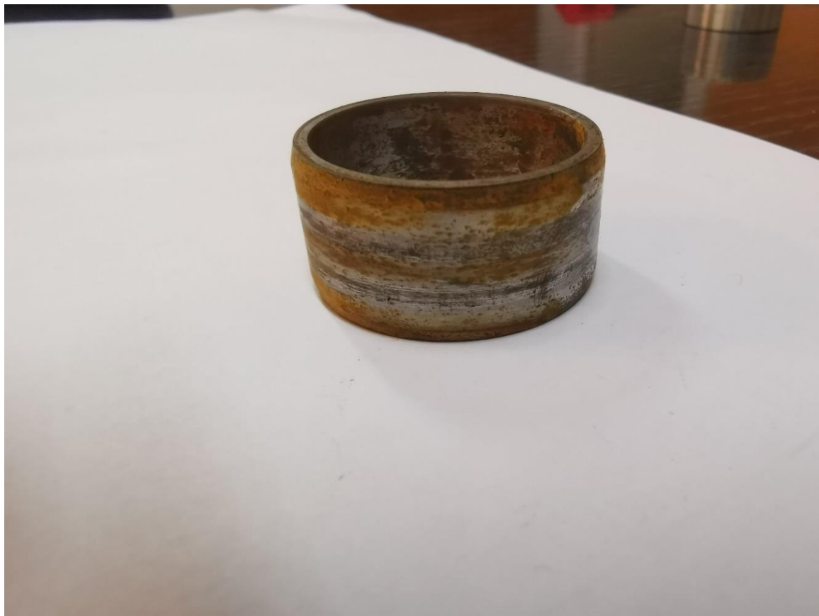
Slika 27. Prsten nakon ispitivanja u vlažnom stanju
