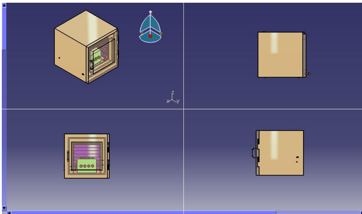
Slika 48. Model komore za umjeravanje u izometriji i 3 osnovna pogleda
