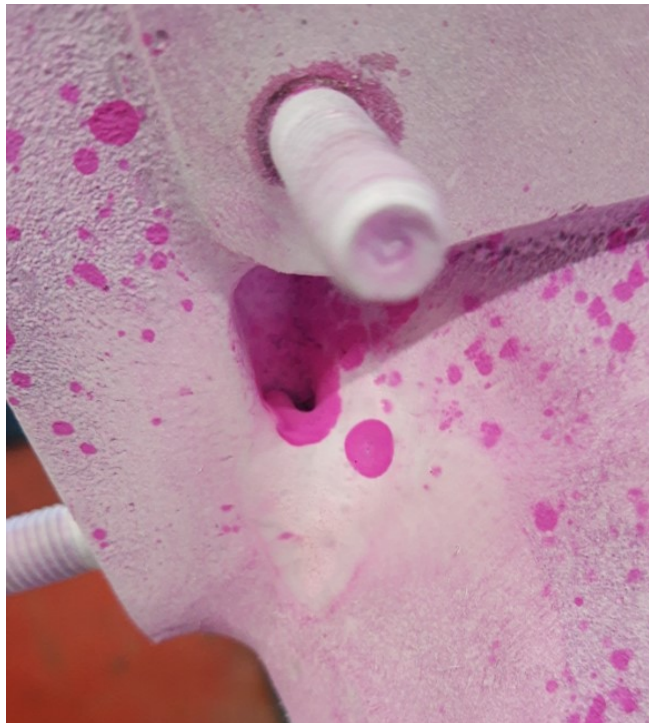
Slika 19. Nestaljen materijal na prijelazu stijenci
