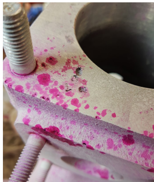
Slika 21. Pore na obrađenom dijelu
