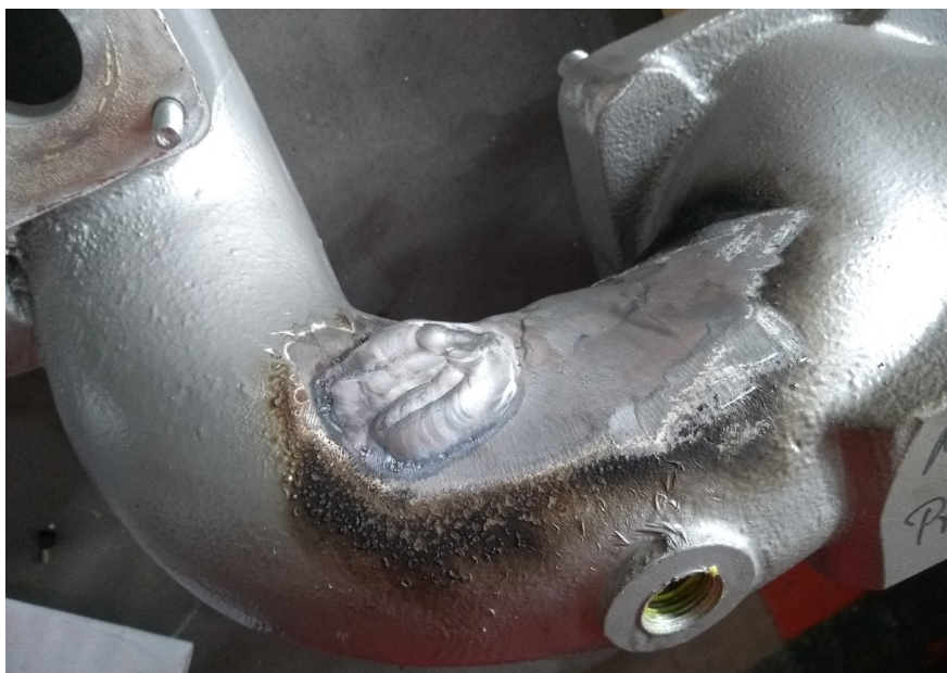
Slika 13. Pokušaj brtvljenja tlačne grane navarivanjem
