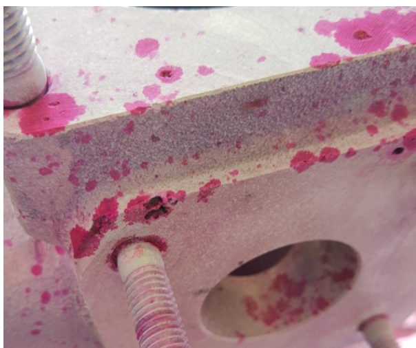
Slika 17. Pore na površini odljevka
