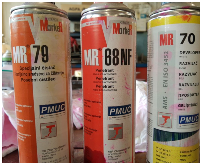
Slika 16. Oprema korištenja pri ispitivanju penetrantom
