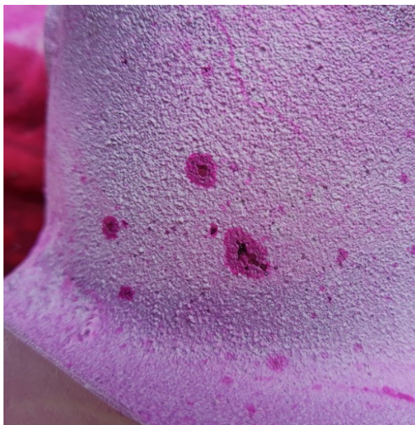
Slika 20. Pore na vanjskoj stijenci
