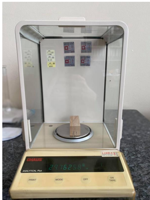
Slika 27. Analitička vaga Ohaus Analytical Plus
