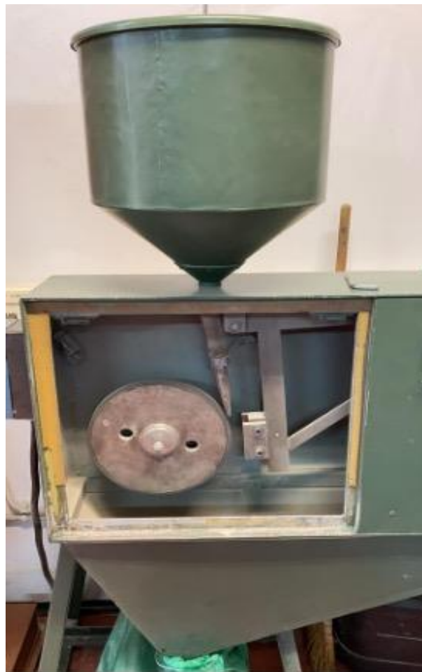
Slika 30. Uređaj za ispitivanje abrazijskog trošenja
