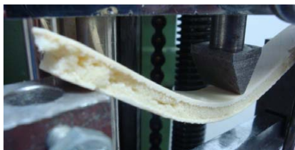
Slika 8.17. Prikaz progiba ispitnog tijela pri ispitivanju savojne čvrstoće
