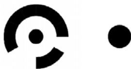
Slika 7.14. Kodirana (lijevo) i nekodirana (desno) mjerna točka
