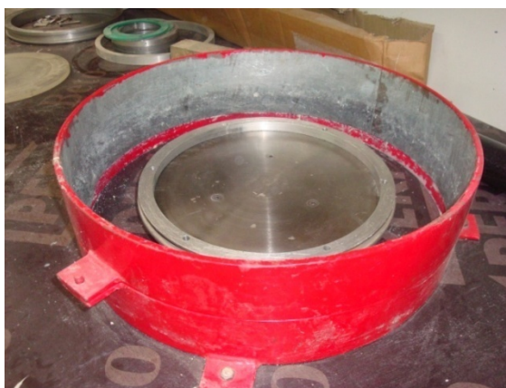
Slika 8.7. Prikaz metalne zaštite uređaja za centrifugalno lijevanje
