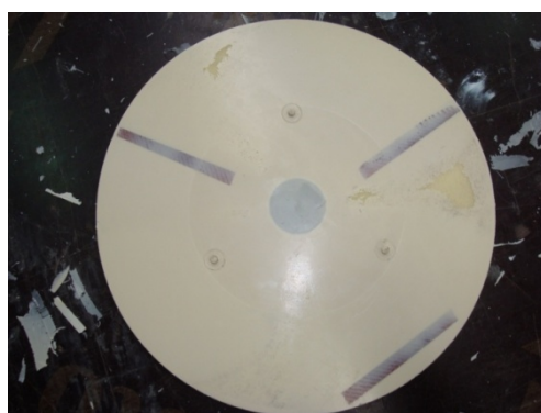
Slika 8.13. Prikaz upotrebe odstoynika pri izradi sendvič ploče
