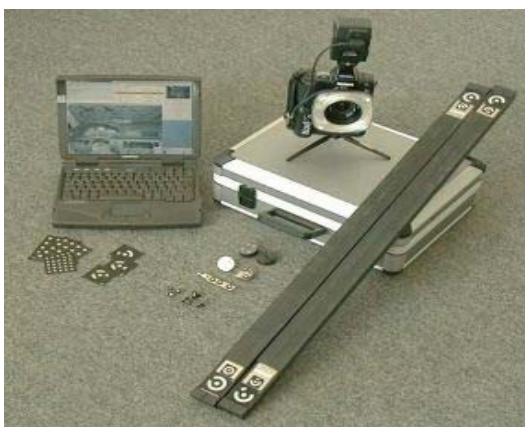
Slika 7.6. Fotogrametrijski sustav TRITOP firme GOM mbH.
