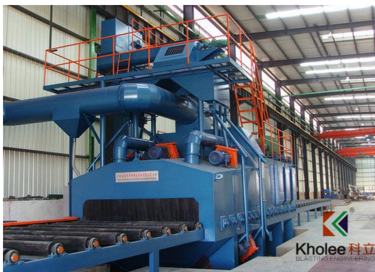
Slika 2. Sačmarenje pomoću automatiziranog stroja u brodogradnjoj industriji[11]
