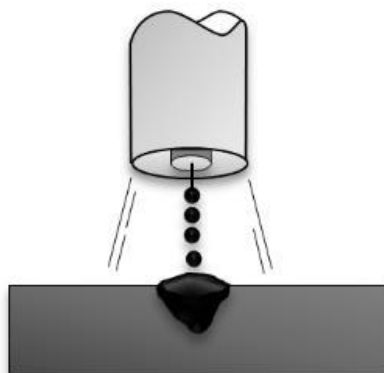
Slika 17. Shematski prikaz prijenosa štrcajućim lukom[21]
