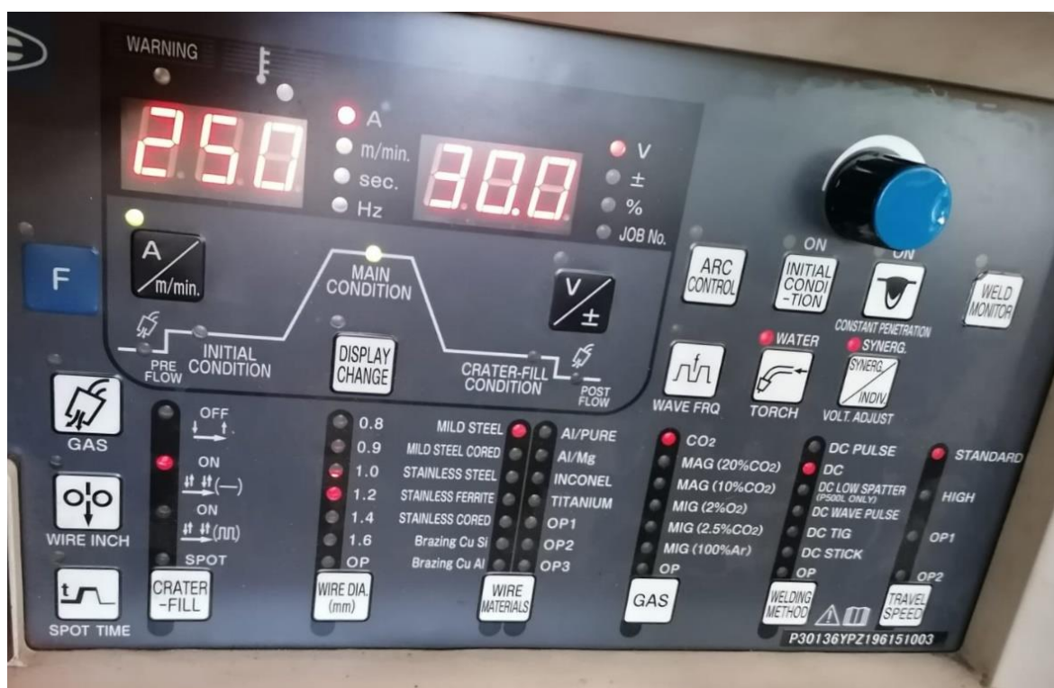
Slika 42. Postavljeni parametri kod MAG zavarivanja
