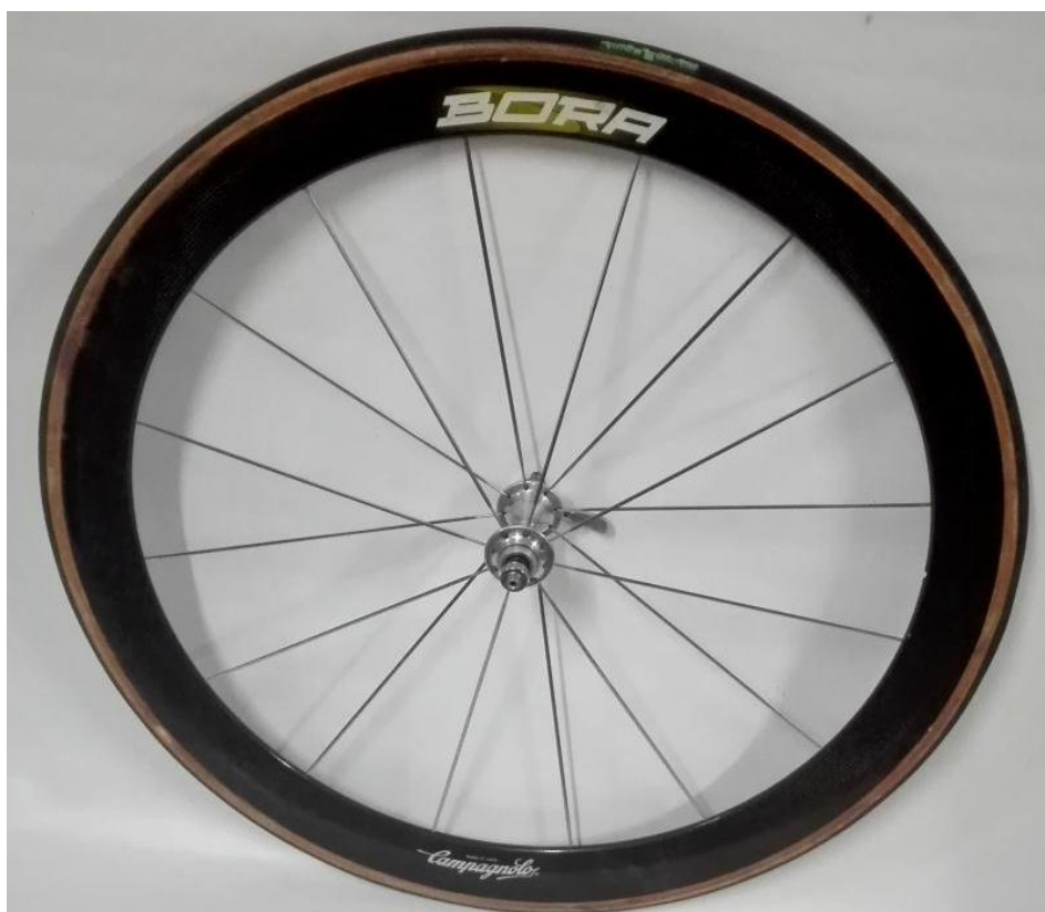
Slika 4. Kotač dubine obruča 50 mm sa 16 žbica iz 1993. godine [3]
