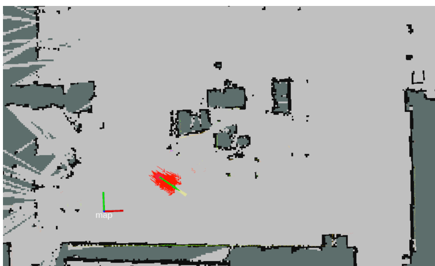
Slika 37. Prikaz zadovoljavajuće konvergencije pozicije i orijentacije robota
