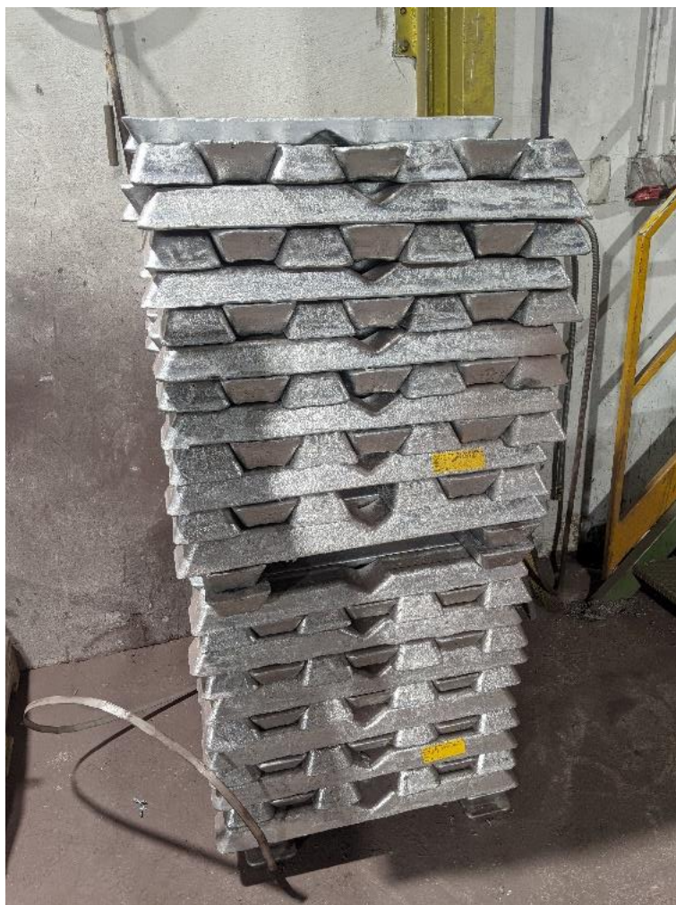
Slika 8. Novi ingoti legure AlSi12
