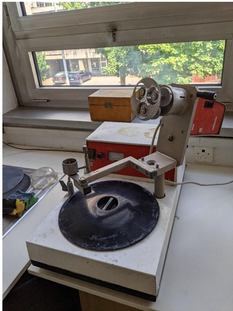
Slika 31. Uređaj za poliranje „Struers DAP-V“
