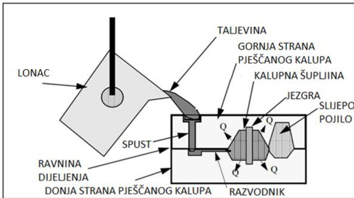
Slika 1. Postupak lijevanja [2]
