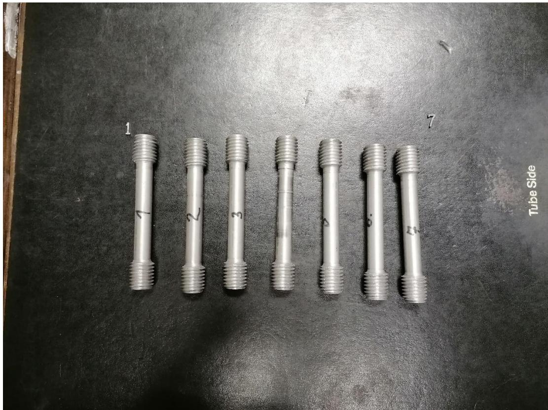
Slika 20. Obrađene epruvete
