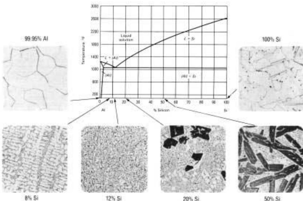
Slika 5. Fazni dijagram binarnog aluminij-silicij sustava [8]
