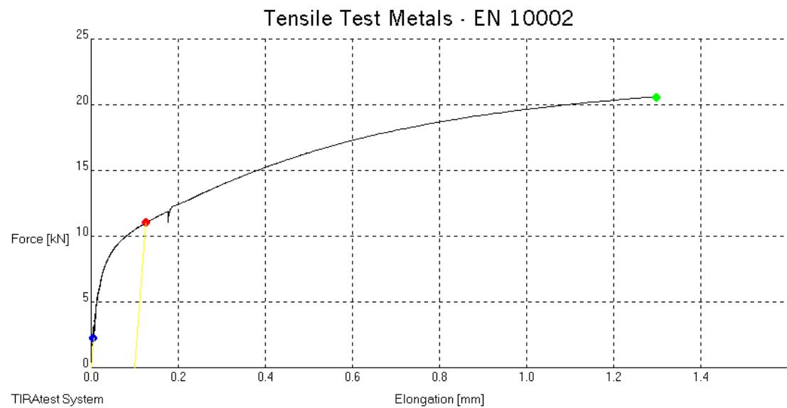
Slika 29. Statičko vlačno ispitivanje šeste modificirane epruvete
