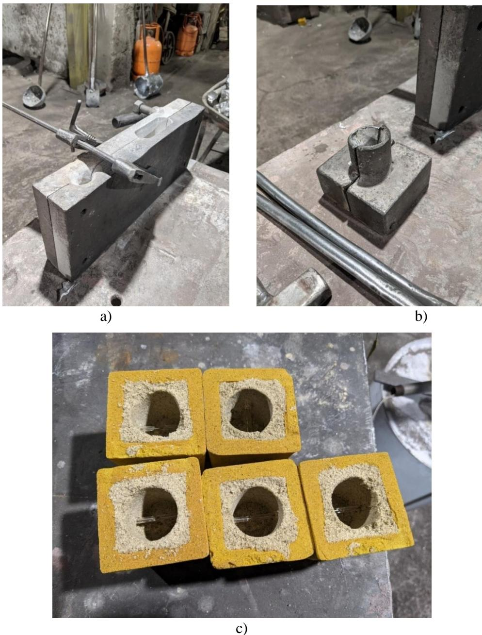
Slika 7. Kalupi a) Kokila za ispitivanje mehaničkih svojstava, b) Kokila za ispitivanje kemijskog sastava, c) Quick-Cup čašica
