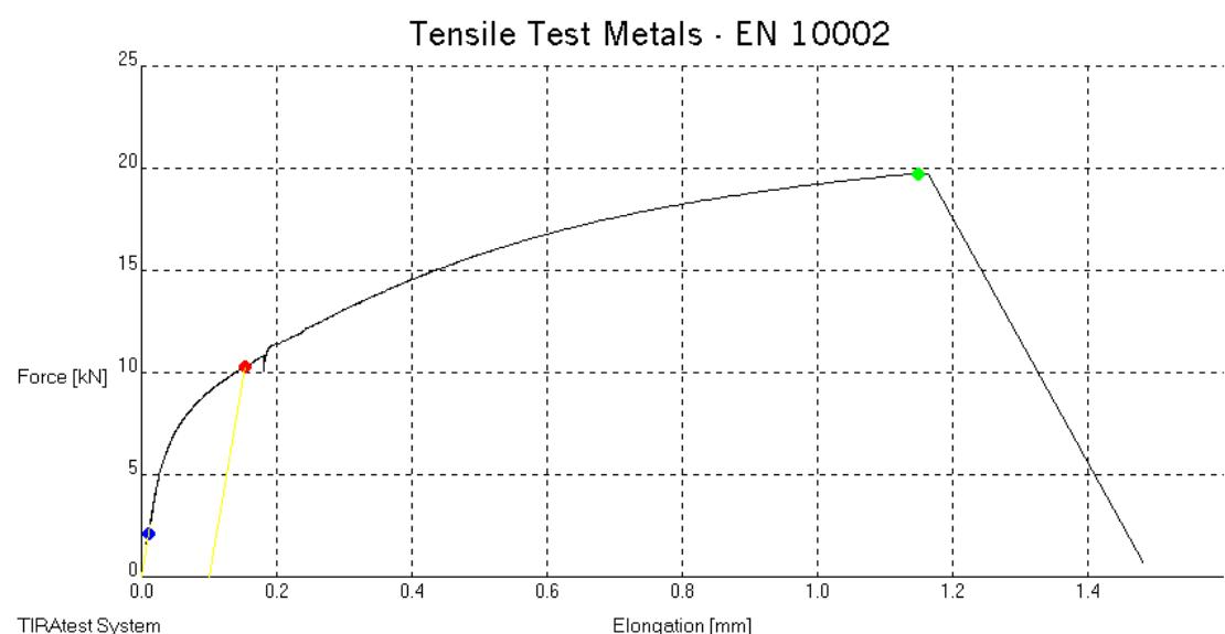
Slika 27. Statičko vlačno ispitivanje pете modificirane epruvete
