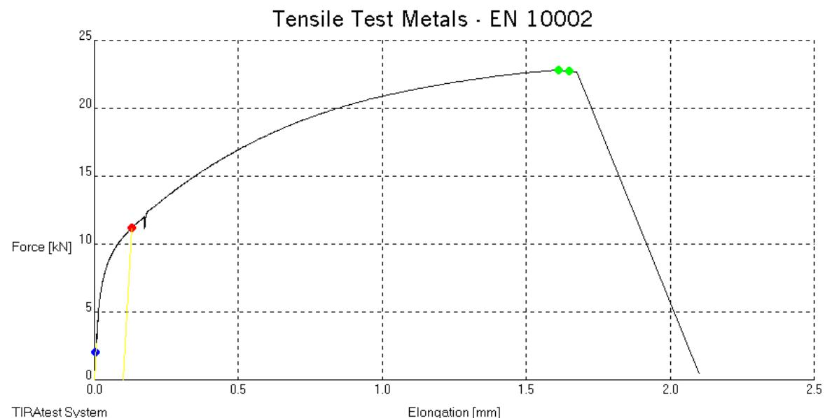
Slika 24. Statičko vlačno ispitivanje prve modificirane epruvete
