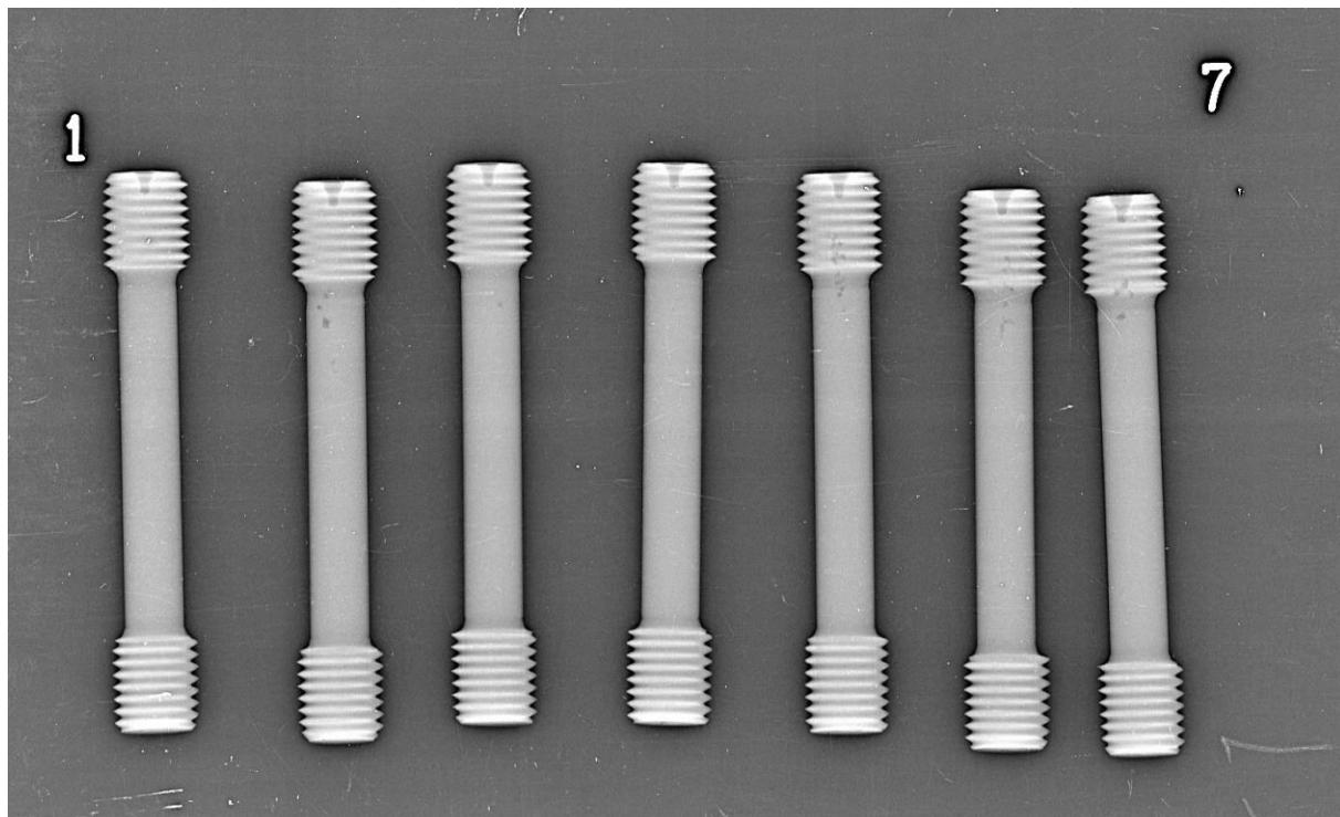
Slika 21. Radiogram epruveta za statičko vlačno ispitivanje
