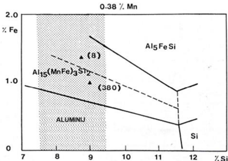
Slika 6. Raspodjela željeznih faza u  $\text{AlSi12}$  leguri u ovisnosti od sadržaja Si i Fe pri 0,38 % Mn [14]
