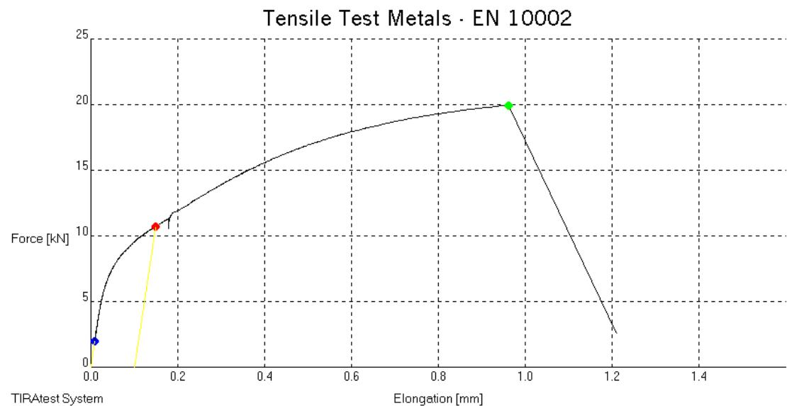
Slika 28. Statičko vlačno ispitivanje četvrte modificirane epruvete
