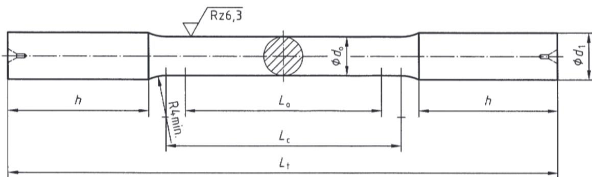
Slika 19. Dimenzije epruveta prema DIN 50125:2009-07 [26]
