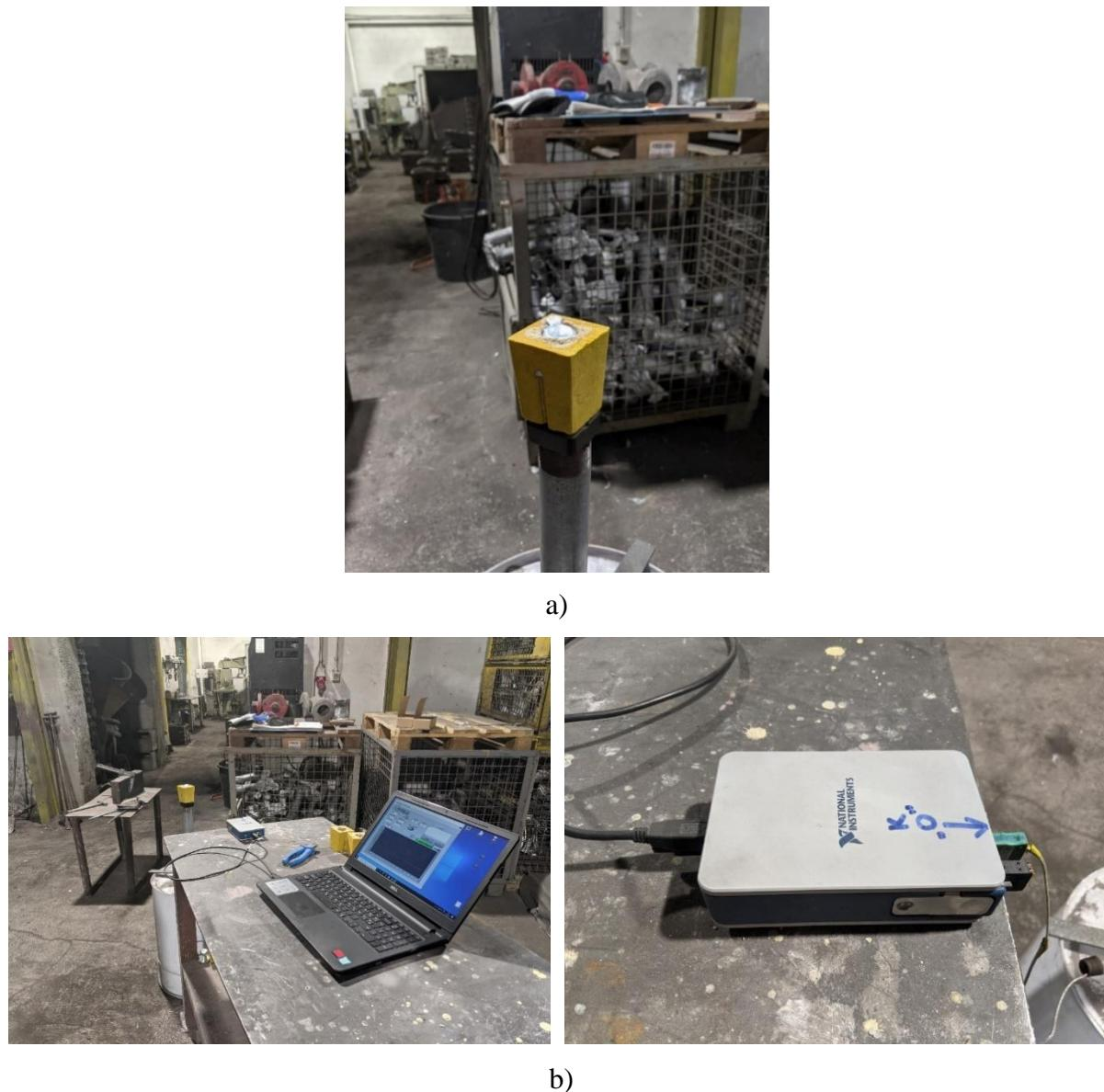
Slika 13. Toplinska analiza, a) Quick-Cup šalica, b) Uređaj za mjerjenje brzine hlađenja
