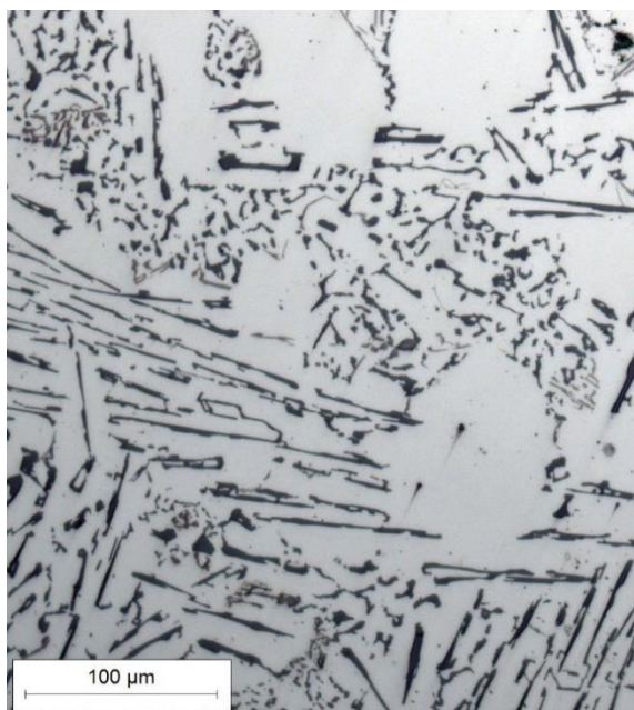
Mikrostruktura pete obrađene AlSi12 legure (polirana) -200x
