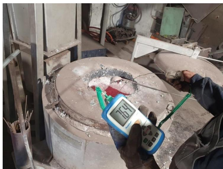
Slika 19. Provjera temperature taline u peći
