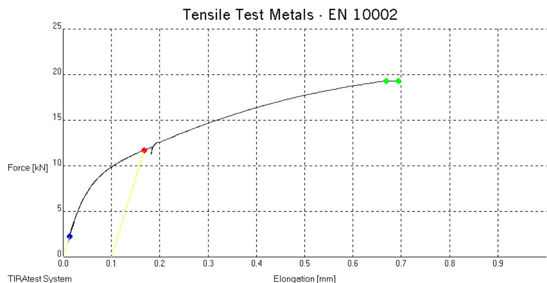
Slika 26. Statičko vlačno ispitivanje treće modificirane epruvete
