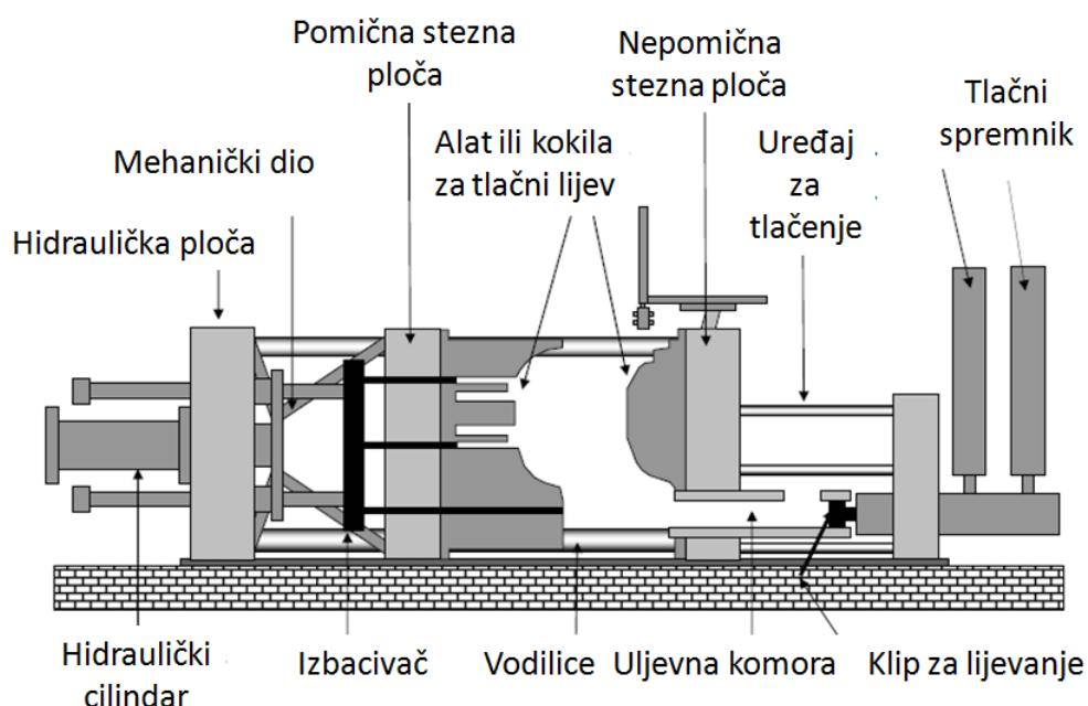
Slika 3. Tlačni lijev [3]
