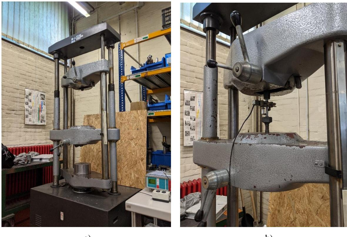
Slika 22. Statičko vlačno ispitivanje, a) Kidalica „EU 40 mod“, b) Senzorsko ticalo
