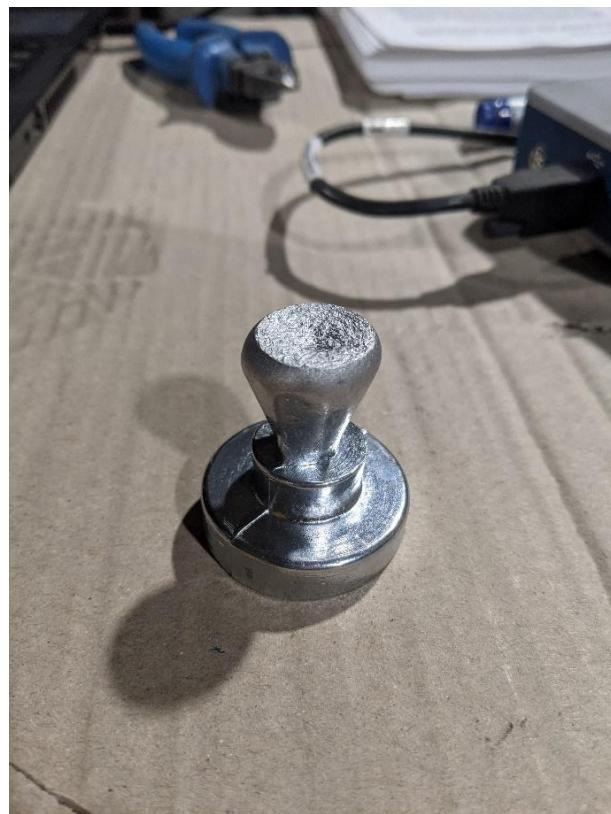
Slika 12. Odljevak za ispitivanje kemijskog sastava
