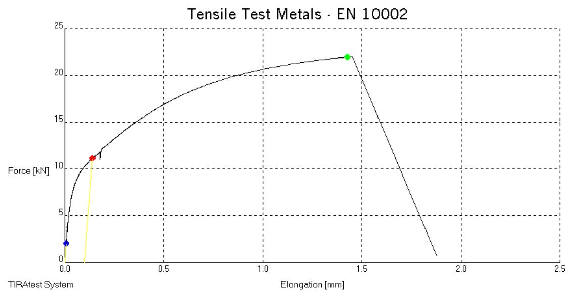
Slika 25. Statičko vlačno ispitivanje druge modificirane epruvete
