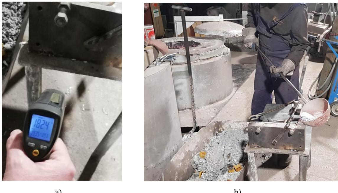
Slika 10. Kokila a) Provjeravanje temperature kokile, b) Postupak lijevanja taline u kokilu
