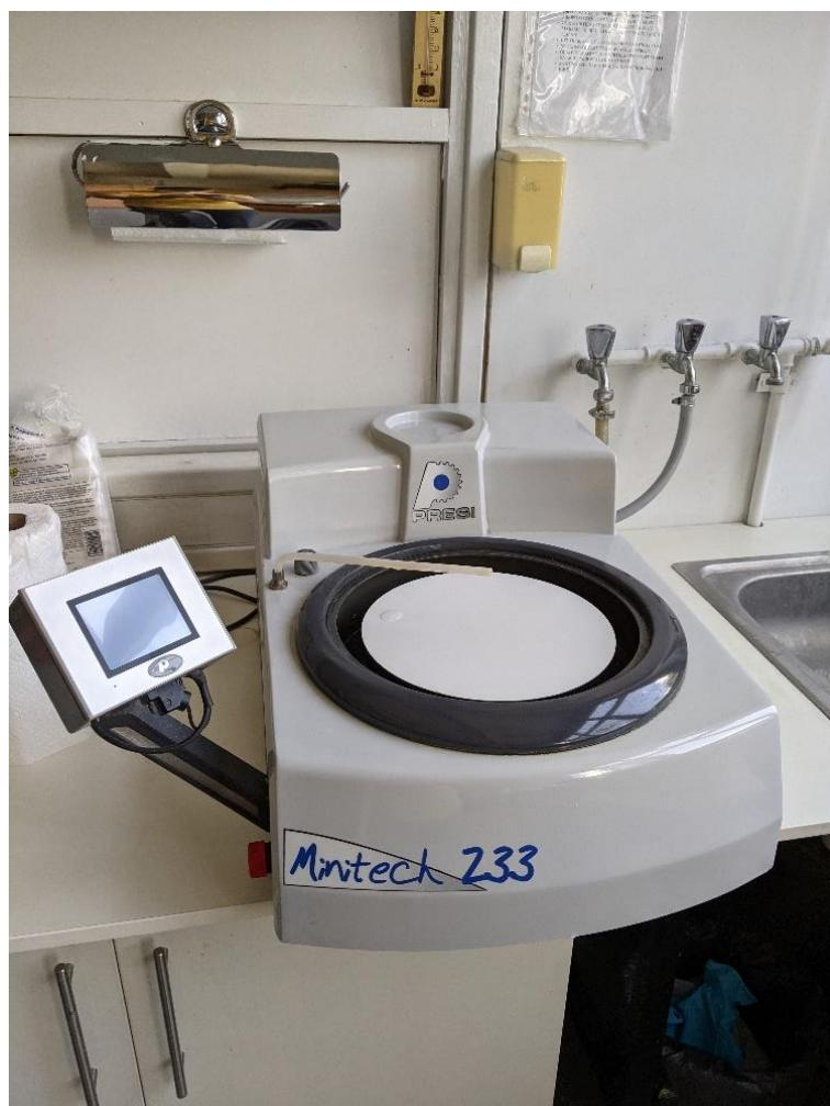
Slika 30. Uređaj za brušenje „Mintech 233“
