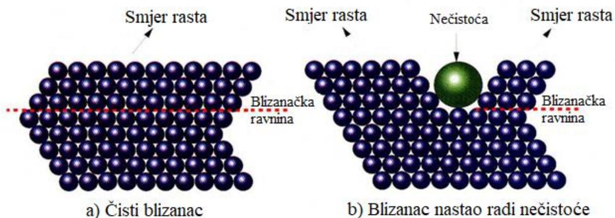
Slika 1. Formacija strukture blizanaca u siliciju [19]
