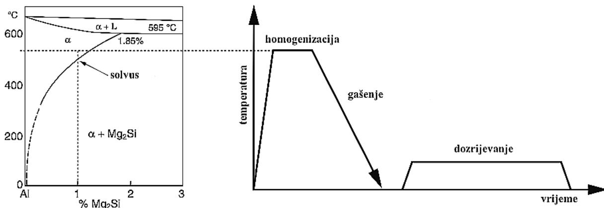
Slika 6. Prikaz postupka precipitacijskog očvršćivanja legure serije 6XXX [12]
