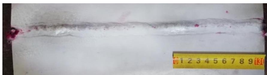
Slika 51. Korijen zavara sa nanesenim penetrantom i razvijačem
