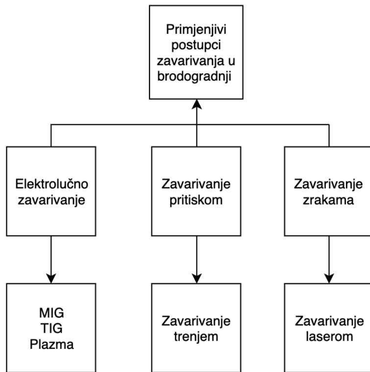
Slika 16. Primjenjivi postupci zavarivanja u brodogradnji [17]
