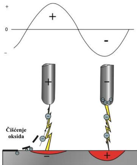
Slika 34. Shematski prikaz izmjeničnog TIG zavarivanja [14]
