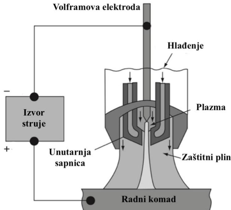
Slika 35. Shematski prikaz elektrolučnog plazma zavarivanja [14]
