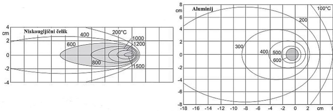
Slika 12. Raspored temperatura prilikom zavarivanja čelika i aluminija [16]
