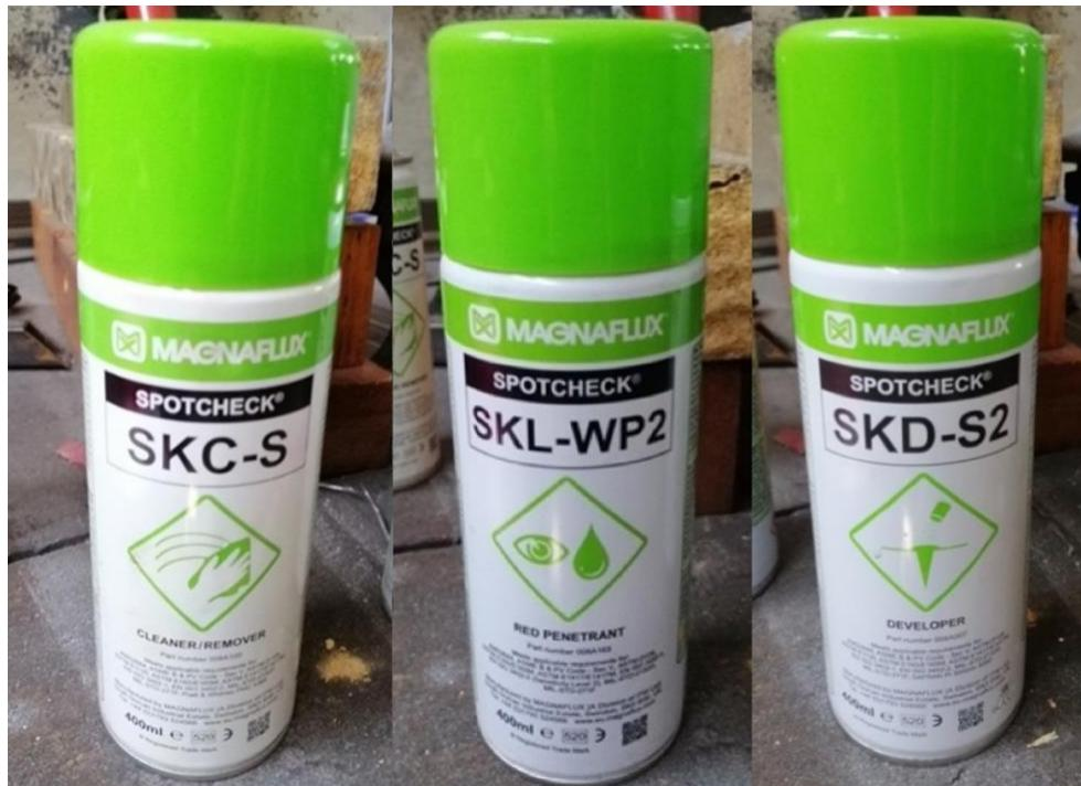
Slika 50. Sredstva korištena za ispitivanje penetrantima
