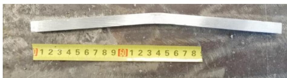
Slika 54. Uzorak za ispitivanje savijanjem
