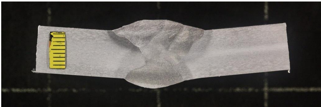
Slika 57. Makroizbrusak nakon postupka nagrivanja
