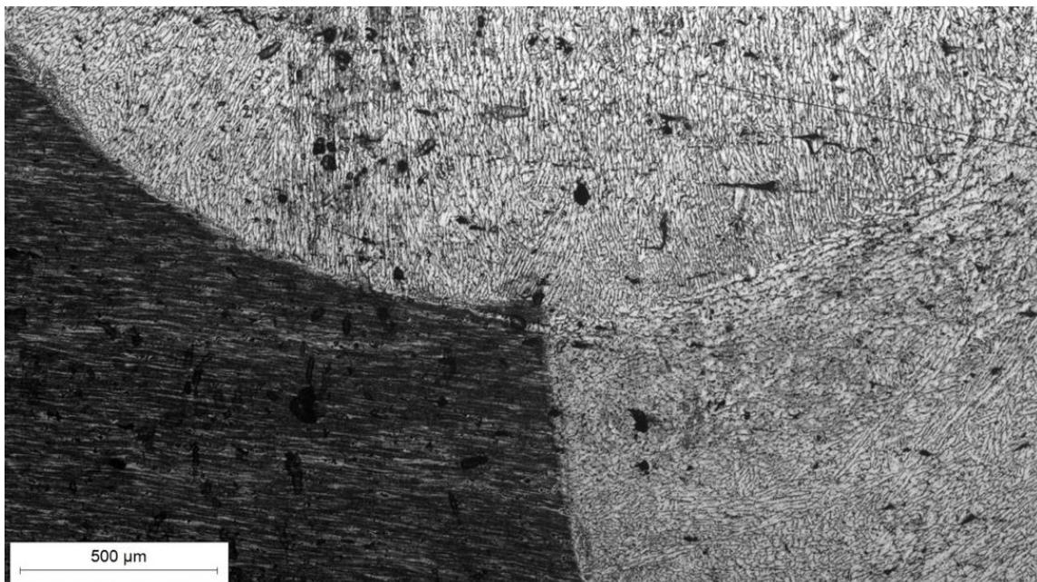
Slika 61. Mikroskopska snimka metala zavara i ZUT-a – lice zavara, lijevo
