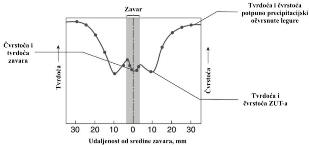
Slika 15. Utjecaj zavarivanja na precipitacijski očvrstnute legure [1]
