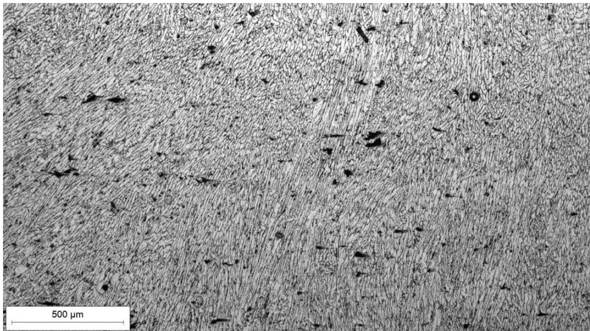
Slika 63. Mikroskopska snimka metala zavara – usmjerenost zrna
