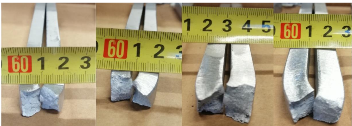
Slika 56. Rezultati bočnog savijanja
