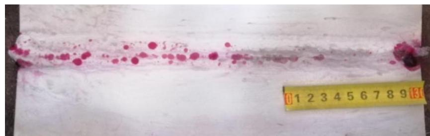
Slika 52. Lice zavara sa nanesenim penetrantom i razvijačem
