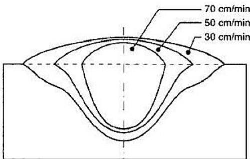
Slika 29. Utjecaj brzine zavarivanja na profil zavara [16]
