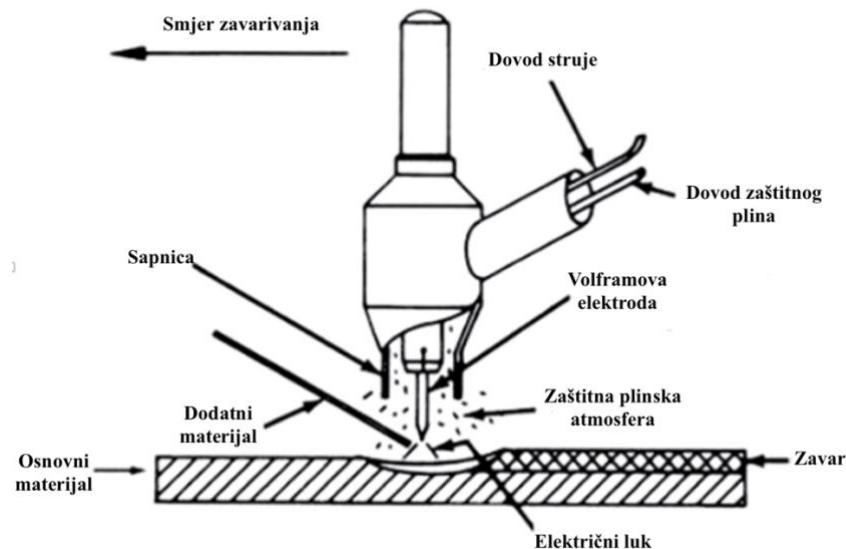
Slika 33. Shematski prikaz TIG postupka zavarivanja [19]
