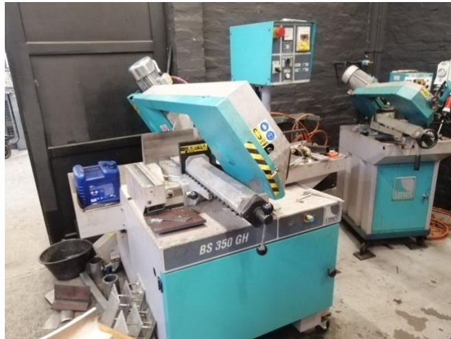
Slika 53. Tračna pila korištena za strojno rezanje ispitnih uzoraka
