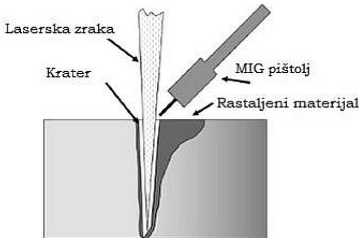
Slika 36. Shematski prikaz hibridnog laser zavarivanja [17]
