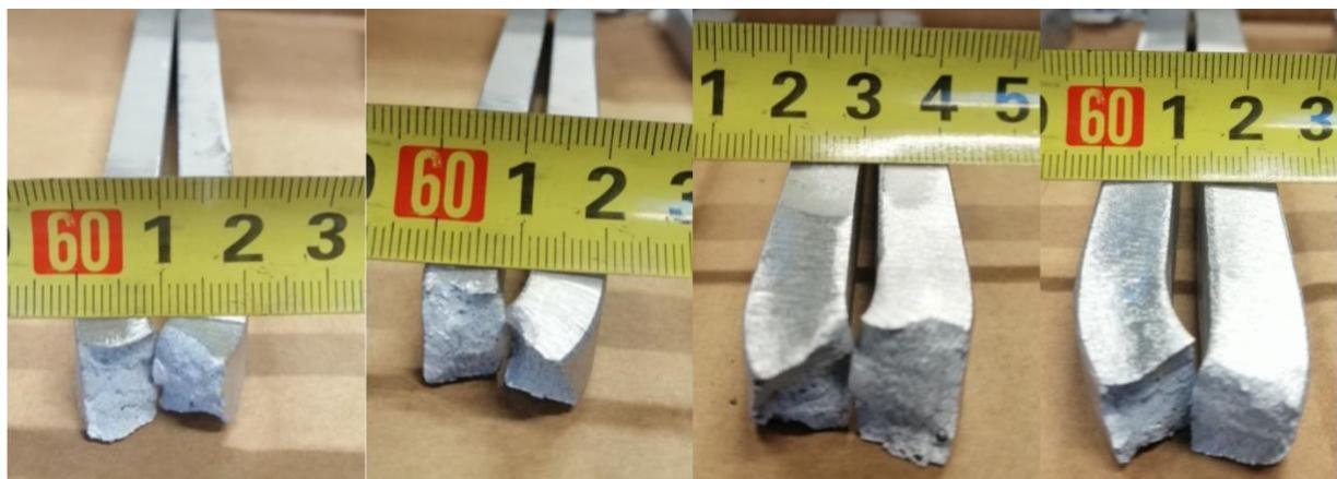
Slika 56. Rezultati bočnog savijanja
