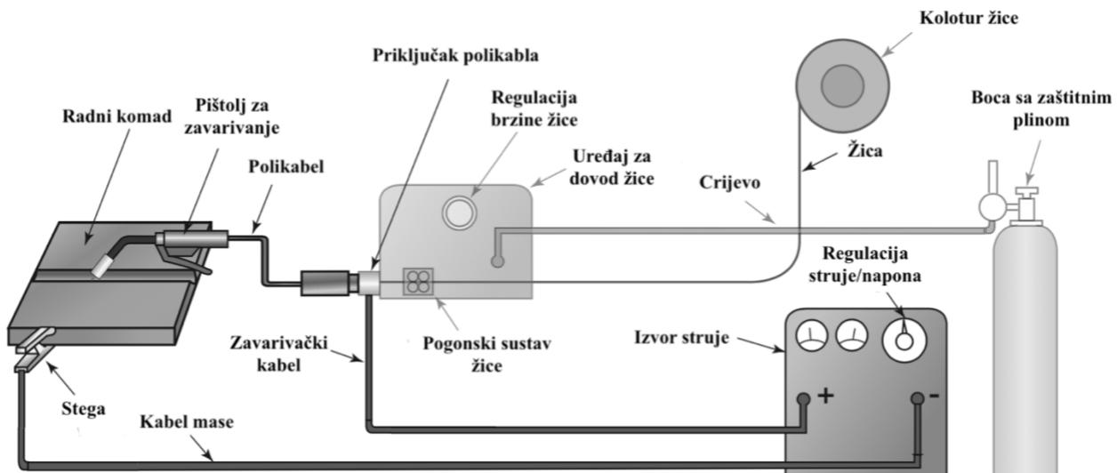
Slika 17. Prikaz opreme za MIG zavarivanje [14]
