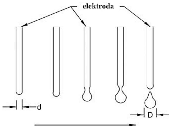
Slika 24. Shematski prikaz prijelaznog načina prijenosa metala [11]
