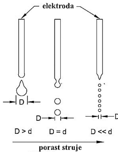
Slika 25. Shematski prikaz štrcajućeg načina prijenosa metala [11]
