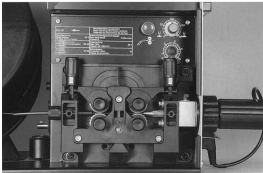
Slika 21. Poprečni presjek Push pogonskog sustava sa 4 valjka [1]
