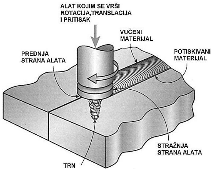
Slika 37. Shematski prikaz friction stir postupak zavarivanja [22]
