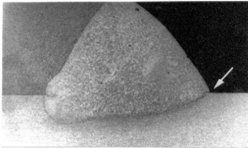
Slika 9. Oksidni film u kutnom zavaru [1]
