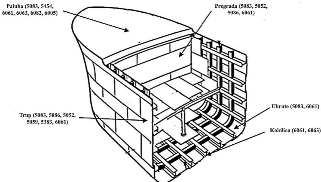
Slika 7. Strukturni dijelovi aluminijskih brodova i pripadajuće Al-legure [13]
