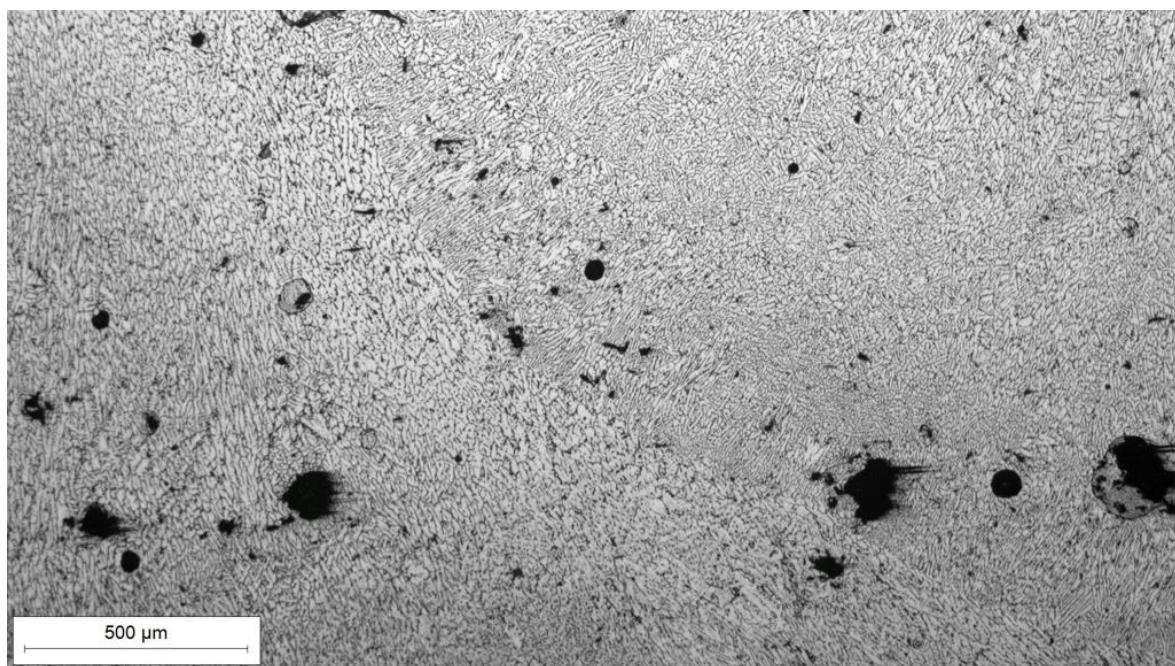
Slika 64. Mikroskopska snimka metala zavara – linija staljivanja
