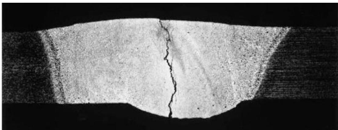
Slika 10. Prikaz tople pukotine nastale prilikom zavarivanja [1]
