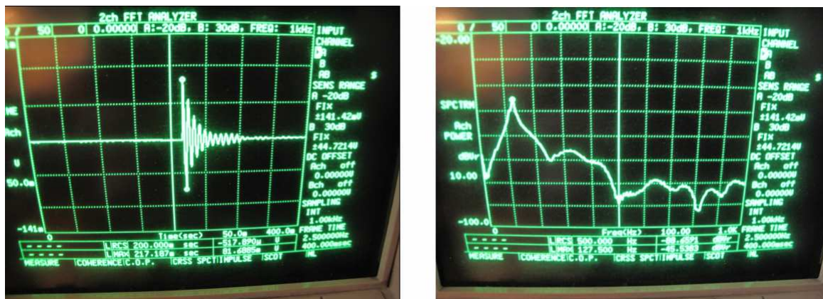
Slika 31. Oblik i spektralna analiza signala dobivenog slobodnim vibriranjem linearnog alternatora
