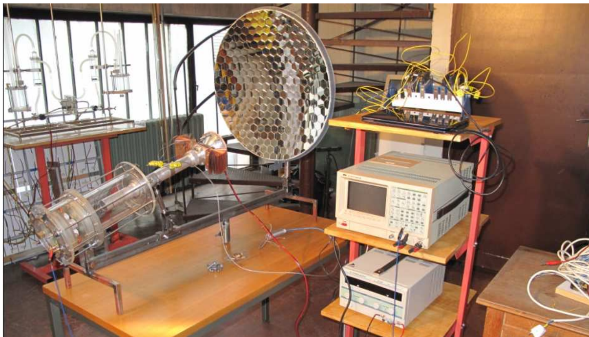
Slika 11b. Termoakustički generator u laboratoriju
