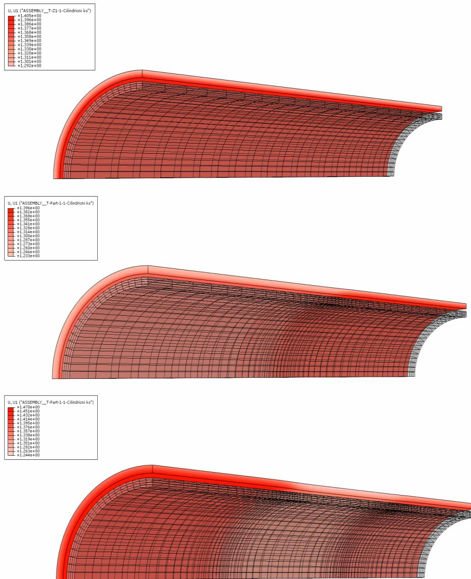
**Slika 29.** Odnos opterećenog i neopterećenog *Holzapfel-Gasser-Ogden* modela bez podjеле (gornja slika), s jednom podjelom (srednja slika) te s dvije podjelom (donja slika)
