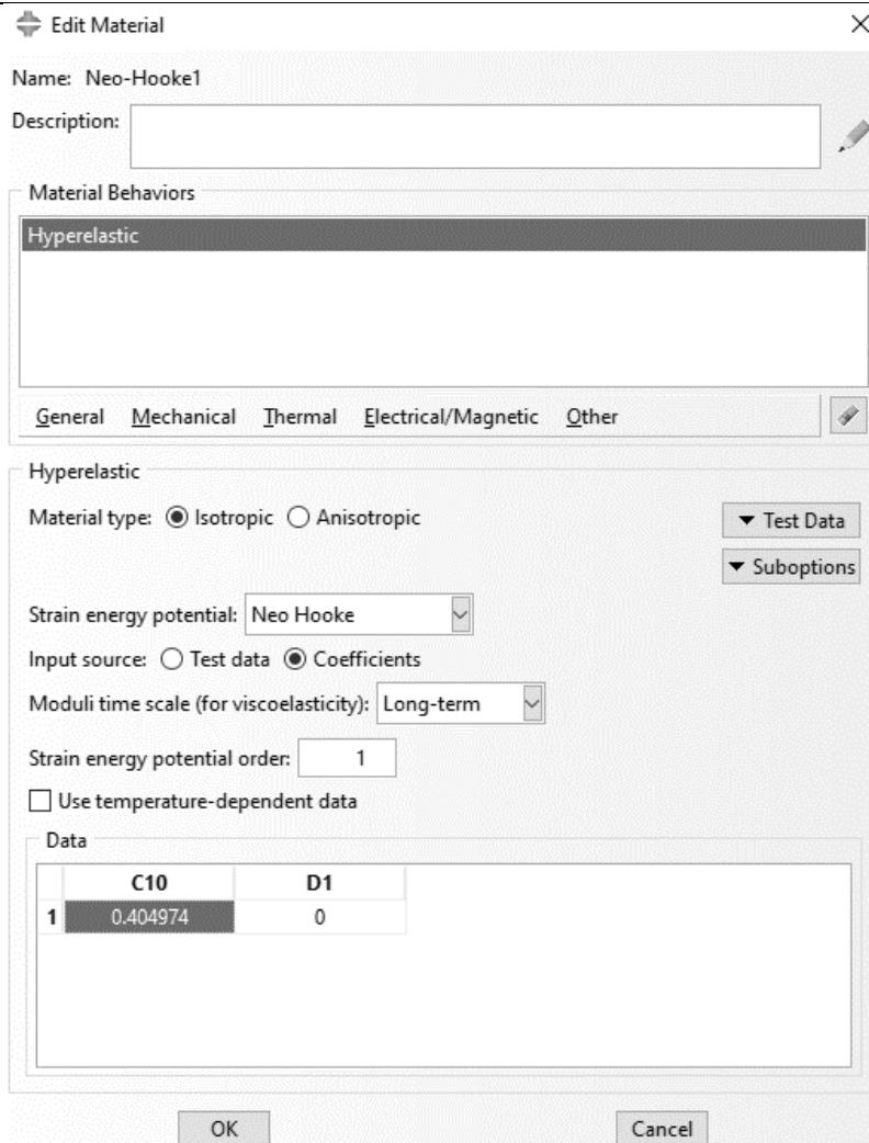
Slika 33. Zadavanje materijalnih parametara za *Neo-Hooke* materijalni model
