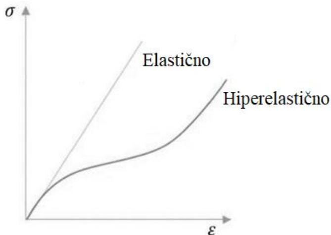
Slika 10. Dijagram naprezanja-deformacije za elastične i hiperelastične materijale
