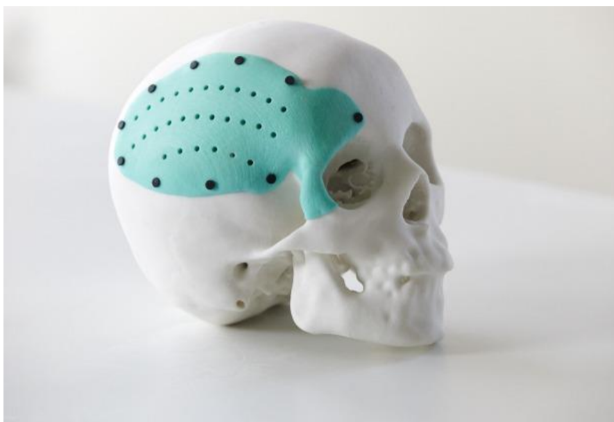
Slika 7. Dio lubanje izrađen AM tehnologijom
