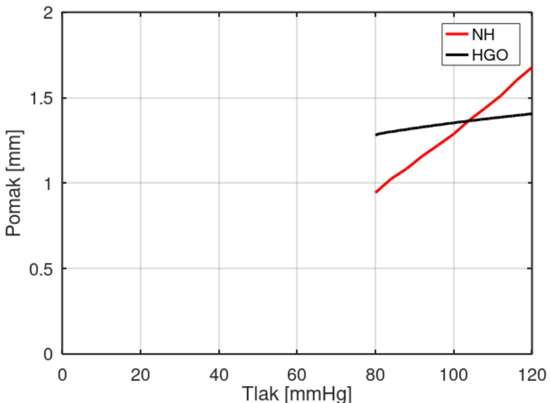
**Slika 40.** Dijagrami *Neo-Hookeov* i *Holzapfel-Gasser-Ogden* modela bez podjela za unutarnji
