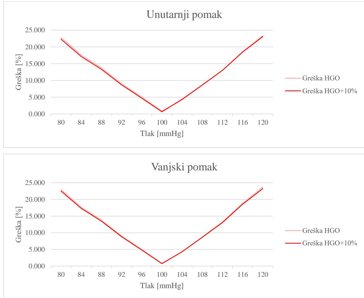
**Slika 38. Relativna greška fitanja za *Holzapfel-Gasser-Ogden* s jednom podjelom na unutarnjem radijusu (gornja slika) i vanjskom radijusu (donja slika)**
