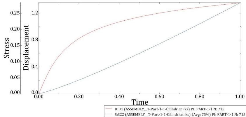
Slika 24. Prikaz ovisnosti naprezanja i pomaka o koraku u čvoru konačnog elementa
