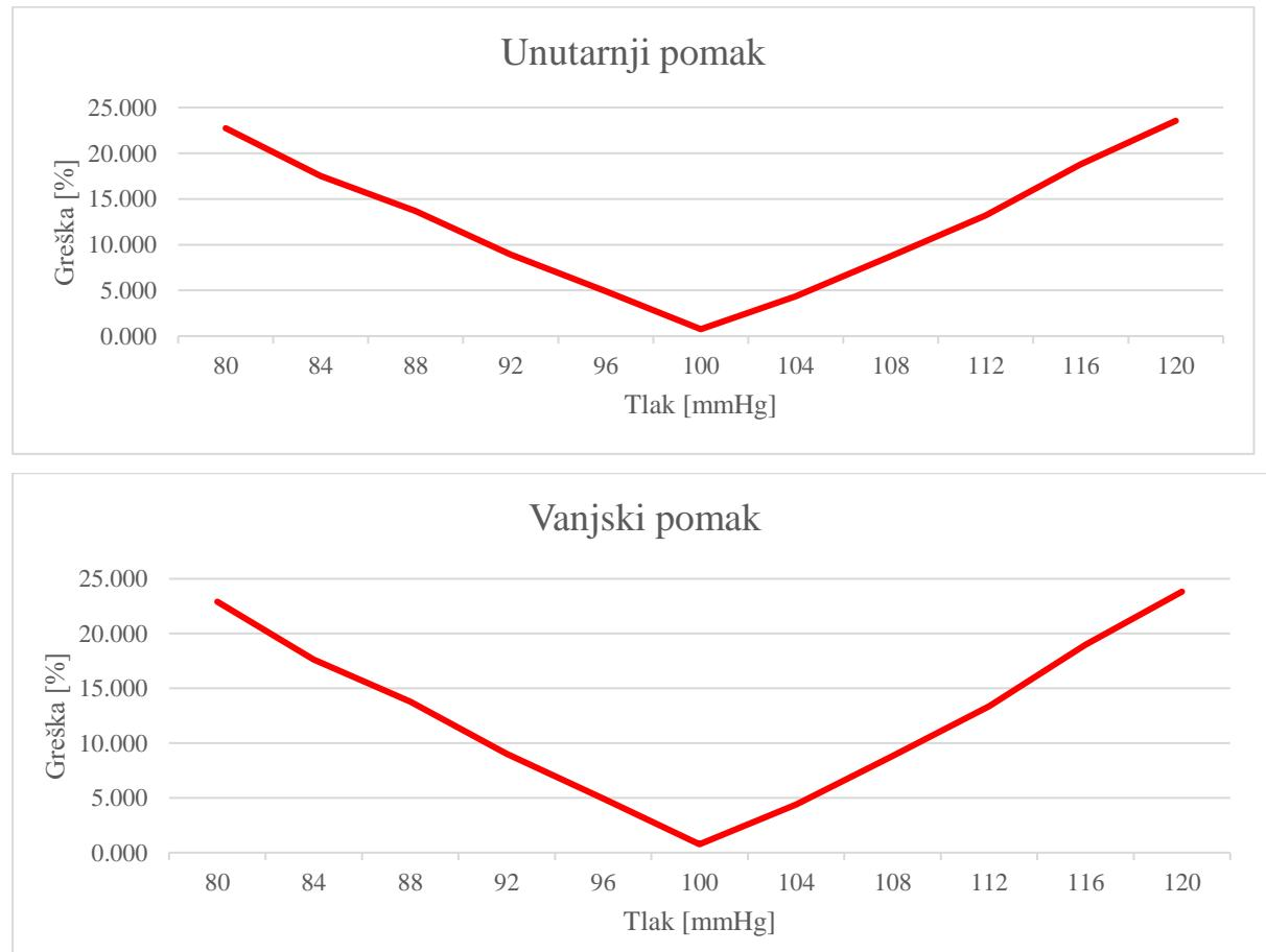
**Slika 37. Relativna greška fitanja za *Holzapfel-Gasser-Ogden* bez podjele na unutarnjem radijusu (gornja slika) i vanjskom radijusu (donja slika)**
