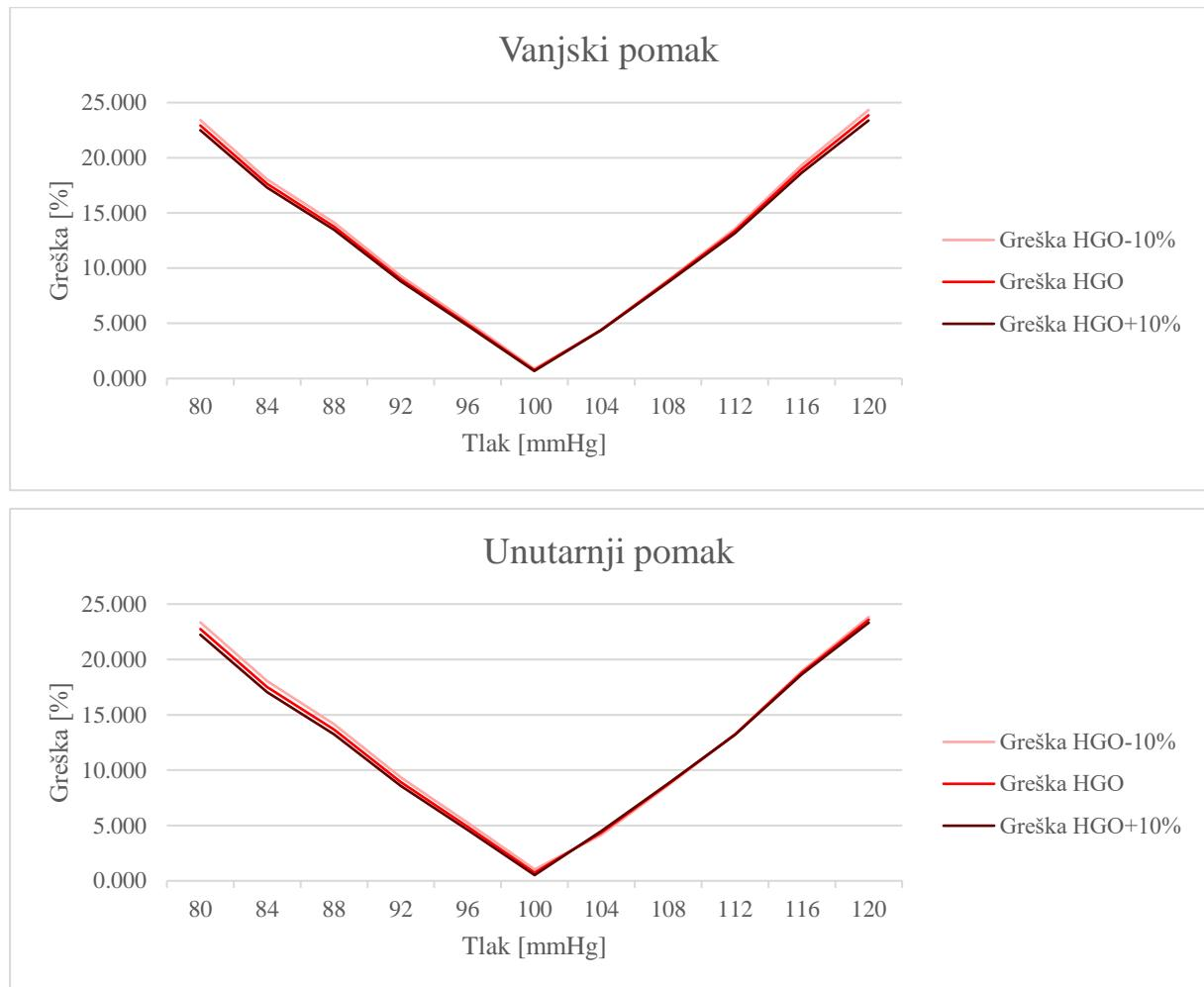
**Slika 39.** Relativna greška fitanja za *Holzapfel-Gasser-Ogden* s dvije podjele na unutarnjem radijusu (gornja slika) i vanjskom radijusu (donja slika)
