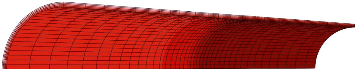
**Slika 31.** Područje prijelaza homogenosti pomaka materijala za *Holzapfel-Gasser-Ogden* materijalni model s jednom podjelom
