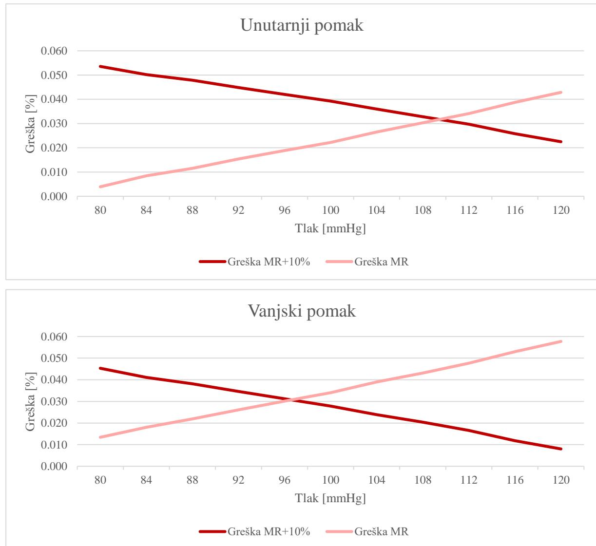
**Slika 35. Relativna greška fitanja za *Mooney-Rivlin* s jednom podjelom na unutarnjem radijusu (gornja slika) i vanjskom radijusu (donja slika)**
