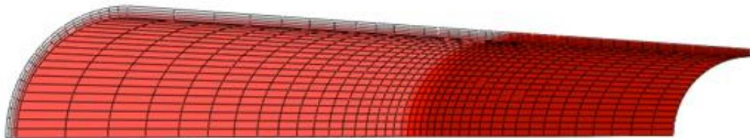
**Slika 27. Područje prijelaza homogenosti materijala za *Mooney-Rivlin* materijalni model s jednom podjelom**
