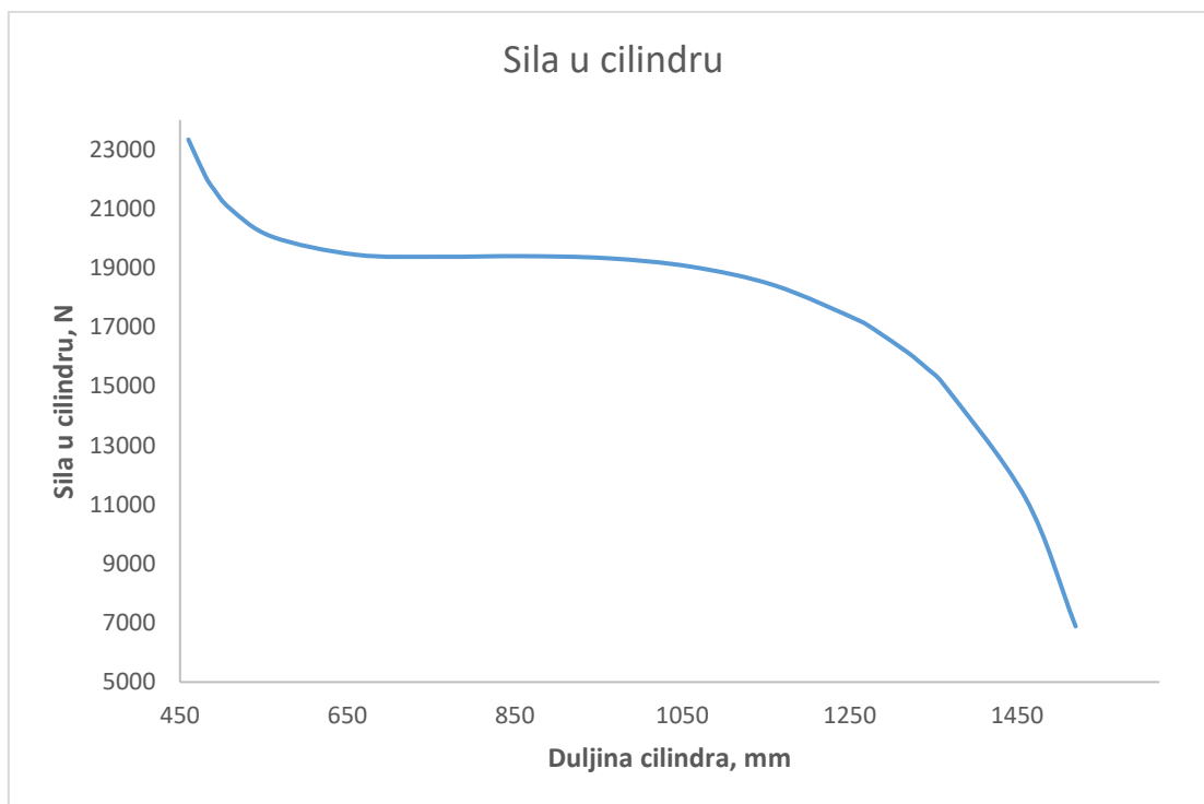
Slika 103. Grafički prikaz ovisnosti sile u cilindru o duljini cilindra
