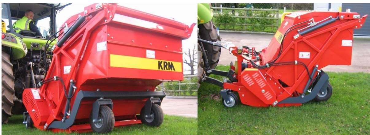
Slika 55. Stražnja konstrukcija s kotačima [32]
