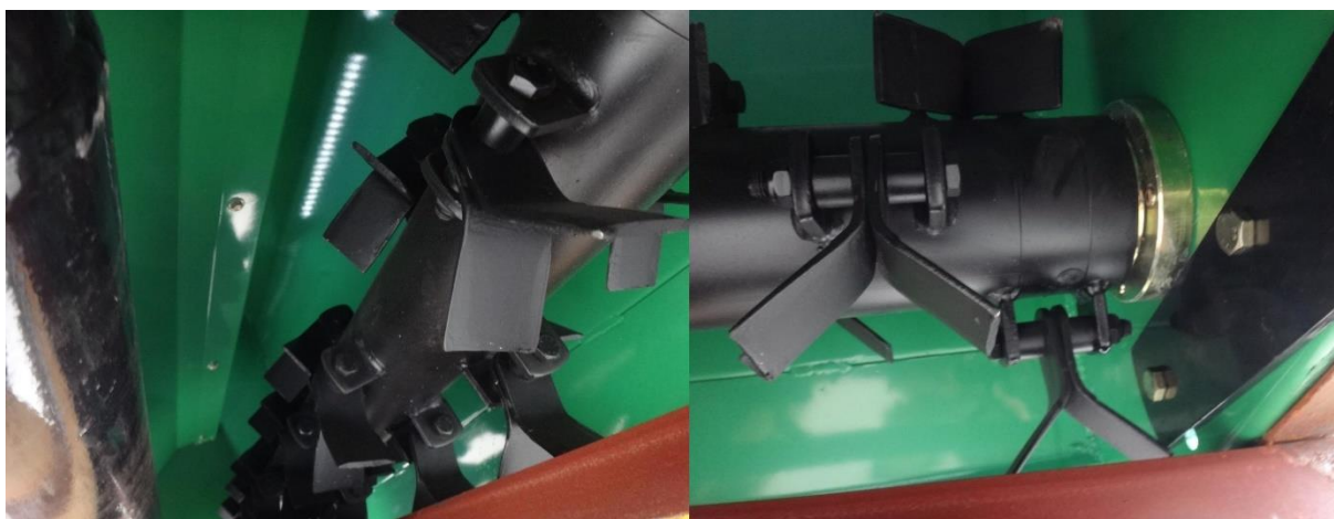
Slika 57. Rotor s Y-noževima [33]
