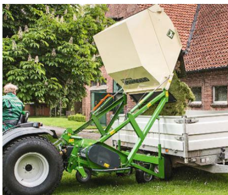
Slika 35. Istresanje biomase sa visine [24]
