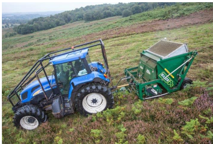
Slika 66. Traktorska kosilica s funkcijom prikupljanja MAJOR MJ2000 [36]
