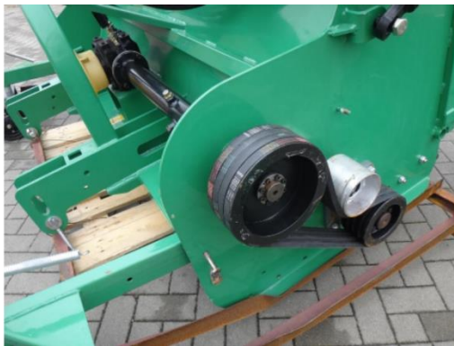
Slika 60. Remenski prijenos na modelu FLP 180 [34]
