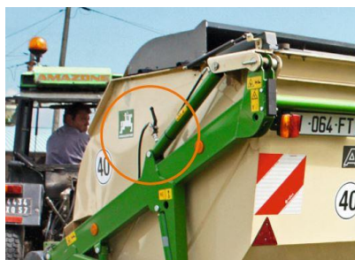
Slika 34. Sigurnosna hidraulična brava [24]
