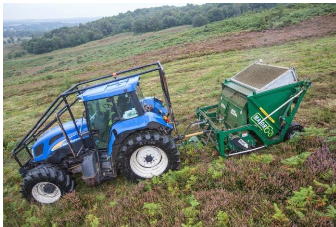
Slika 66. Traktorska kosilica s funkcijom prikupljanja MAJOR MJ2000 [36]
