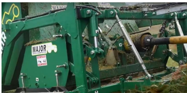
Slika 67. Hidraulički cilindar za regulaciju visine rezanja 37
