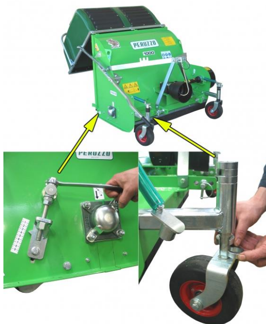
Slika 18. Sustav regulacije visine [18]
