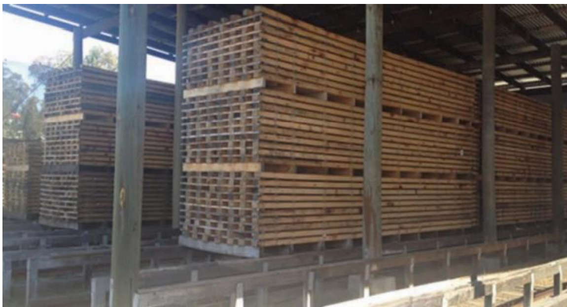
Slika 10. Primjer slaganja u pravilan složaj za prirodno sušenje u natkrivenom prostoru. [3]
