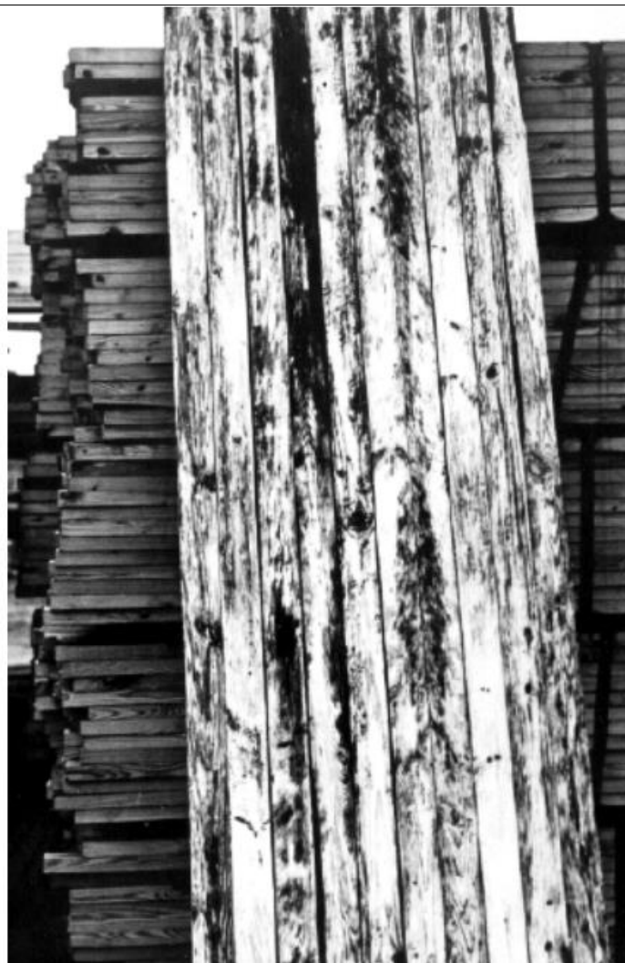
Slika 9. Obojenje piljenica uslijed djelovanja gljivica tijekom sušenja [4]
