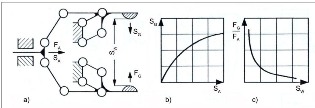
Slika 20. Ovisnost sile stezna kod polužnog prijenosnika [1]
