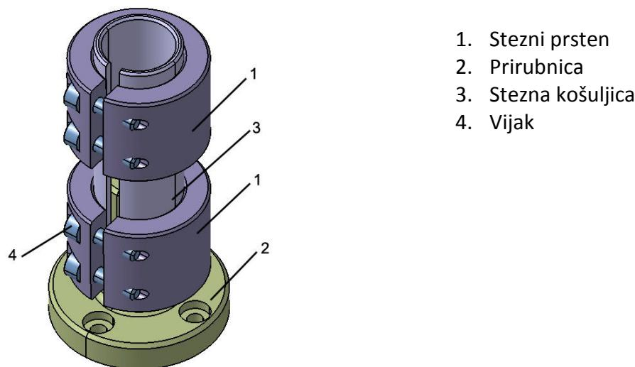
Slika 37. Spoj prirubnice hvataljke i osovine manipulatora
