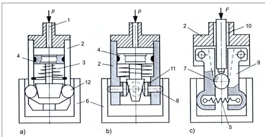
Slika 28. Primjeri steznih hvataljki za hvatalje predmeta rada na unutarnjoj plohi [1]
