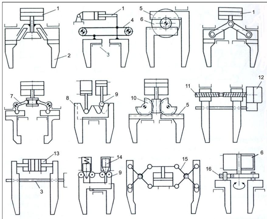
Slika 21. Shematski prikaz kinematskih modela translatornih steznih hvataljki [1]
