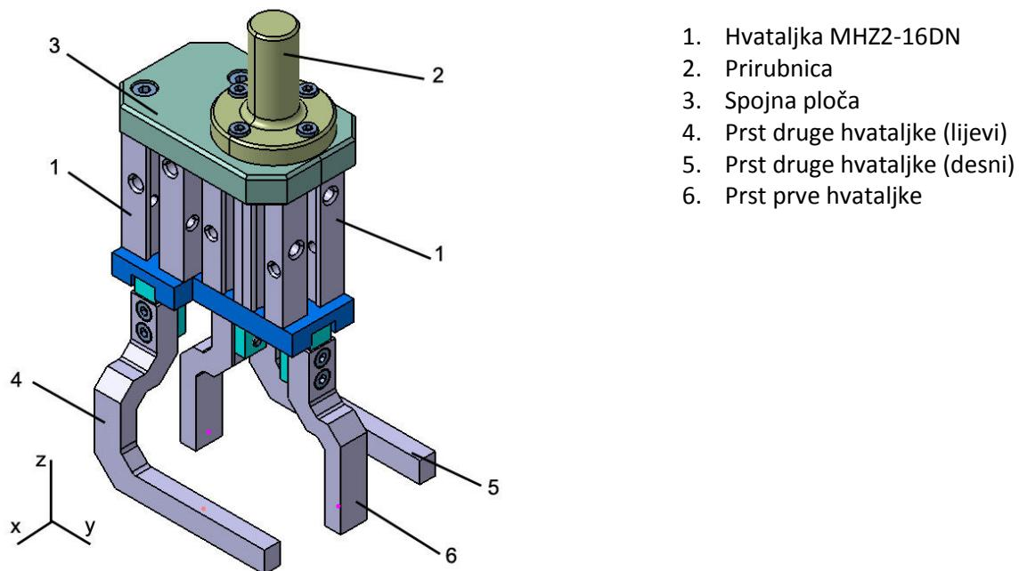
Slika 36. Četveroprstna hvataljka s efektom centriranja predmeta rada.
