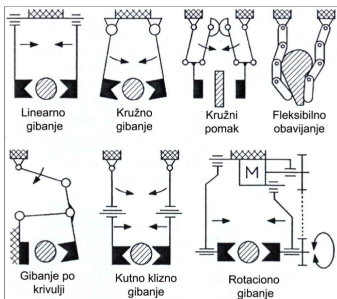
Slika 18. Shema kinematskih modela steznih hvataljki [1]
