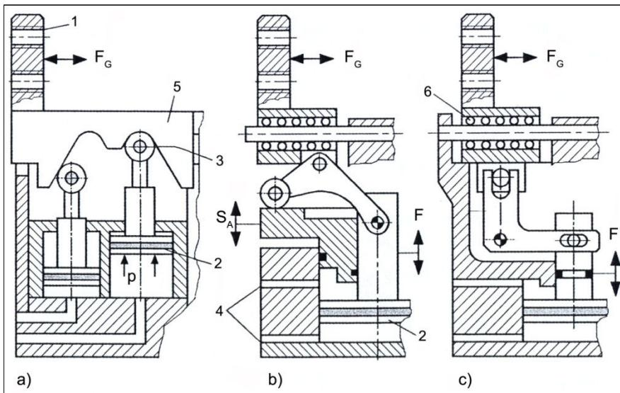
Slika 22. Prikaz konstrukcijskog rješenja transtaltnih steznih hvataljki [1]
