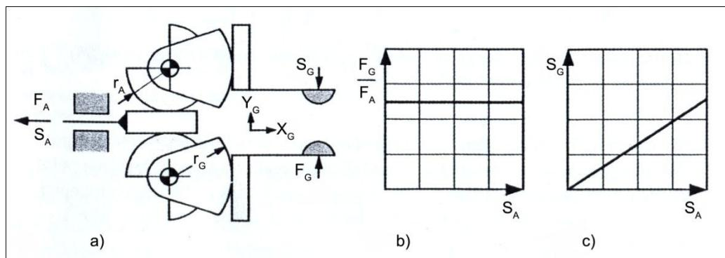
Slika 19. Ovisnost sile stezanja kod zupčastog prijenosnika [1]
