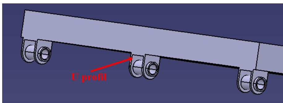
Slika 35. U profili za spajanje osovine s okvirom
