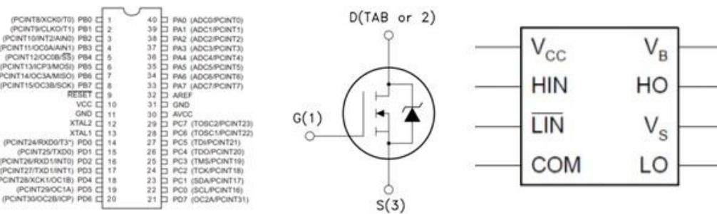
**Slika 16.** ATmega1284P (lijevo), STP75NF75 (sredina), IR2103(S)PBF (desno) [18, 19, 20]
