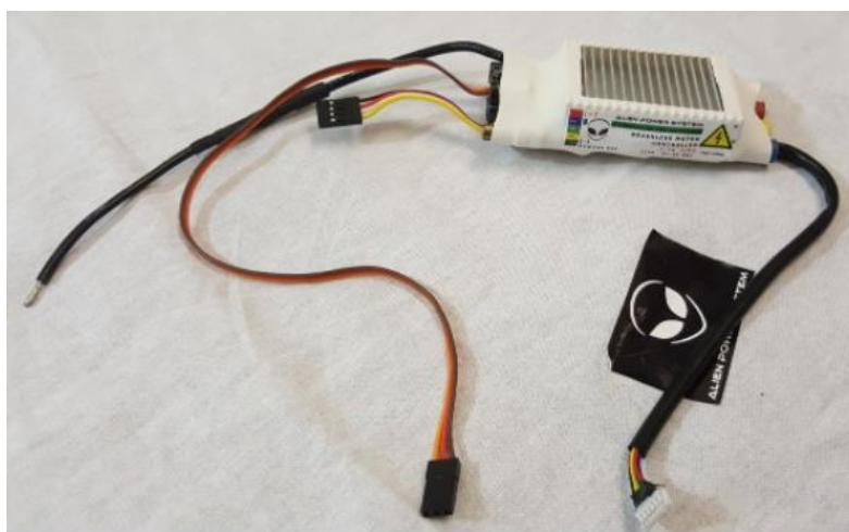
**Slika 19.** ESC kontroler istosmjernog motora bez četkica sa senzorima [22]
