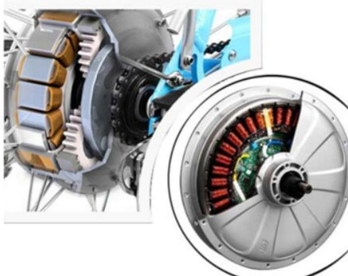
**Slika 11. Motor unutar kotača s direktnim prijenosom (desno) i s prijenosom preko zupčanika (lijevo) [10]**
