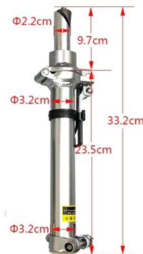
**Slika 30.** Nastavak za spajanje vilice s upravljačem [27]
