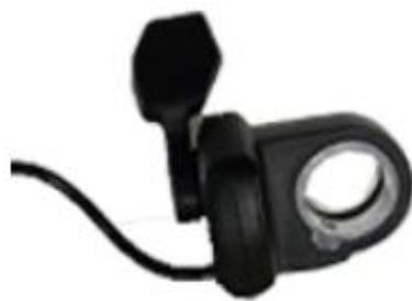
**Slika 22. Ručica za upravljanje elektroničkim kočenjem [24]**
