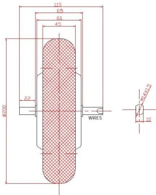
Slika 27. Dimenziije izabranog kotača s motorom [13]
