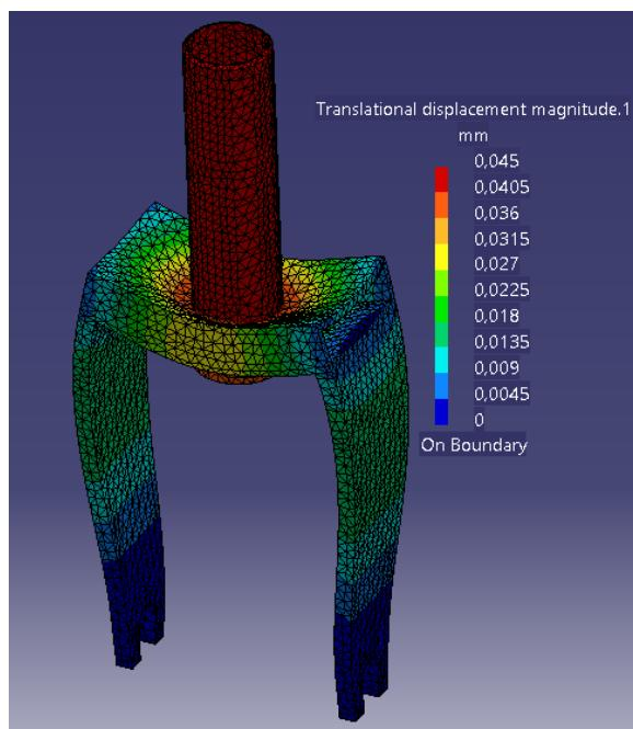
**Slika 42.** Deformacija vilice pod utjecajem opterećenja
