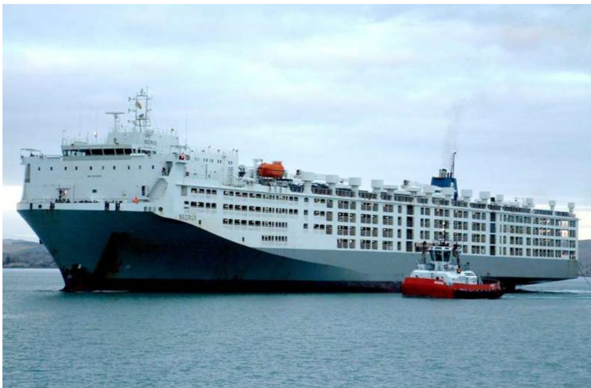
Slika 1. Otvoreni tip broda za prijevoz žive stoke "MV Becrux" [2]
