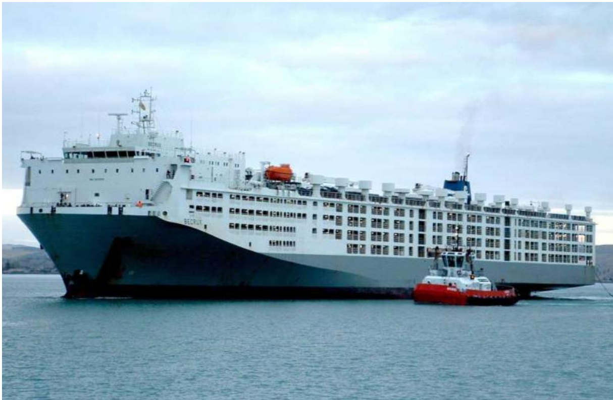
Slika 1. Otvoreni tip broda za prijevoz žive stoke "MV Becrux" [2]
