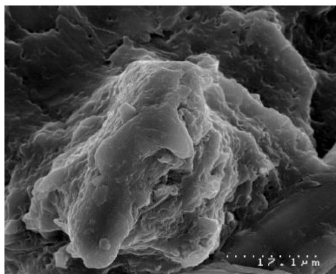
**Slika 21. Prikaz strukture vlakna konoplje nakon kombinacije alkalanog tretiranja te gljivičnog tretiranja [40]**
