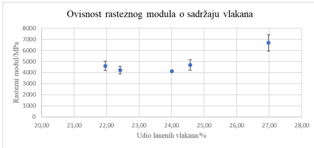
**Slika 64. Ovisnost rasteznog modula o sadržaju vlakana**
