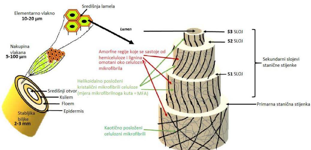
Slika 10. Detaljni prikaz građe lignoceluloznog vlakna [22]
