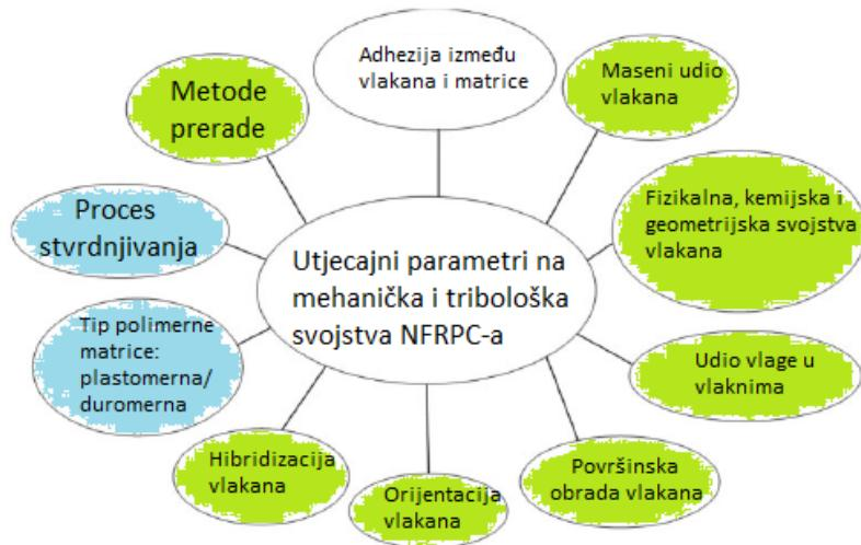
Slika 3. Utjecajni parametri na svojstva NFRP kompozita [11]
