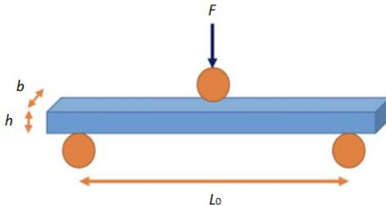
Slika 22. Shema provođenja savojnoga ispitivanja u tri točke [45]
