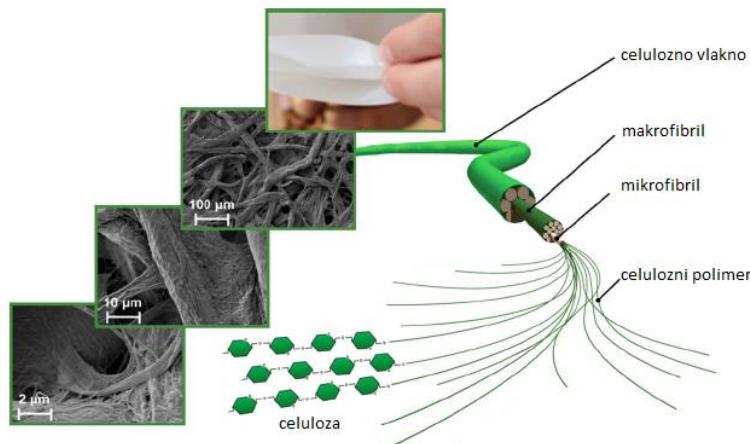
**Slika 13. Mikrostruktura i model celuloznog vlakna [11]**
