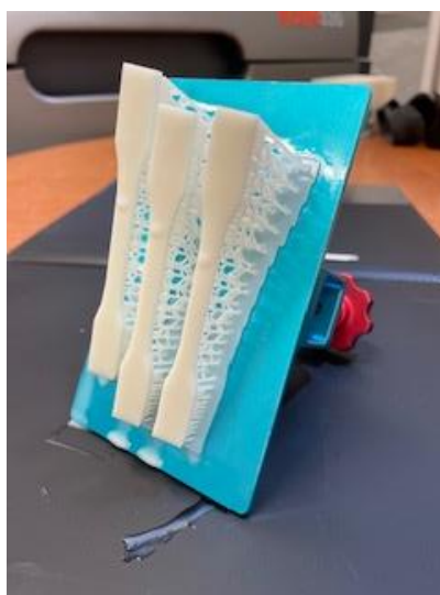
Slika 5.5. Radna podloga pisača s 3 proizvedena ispitna tijela
