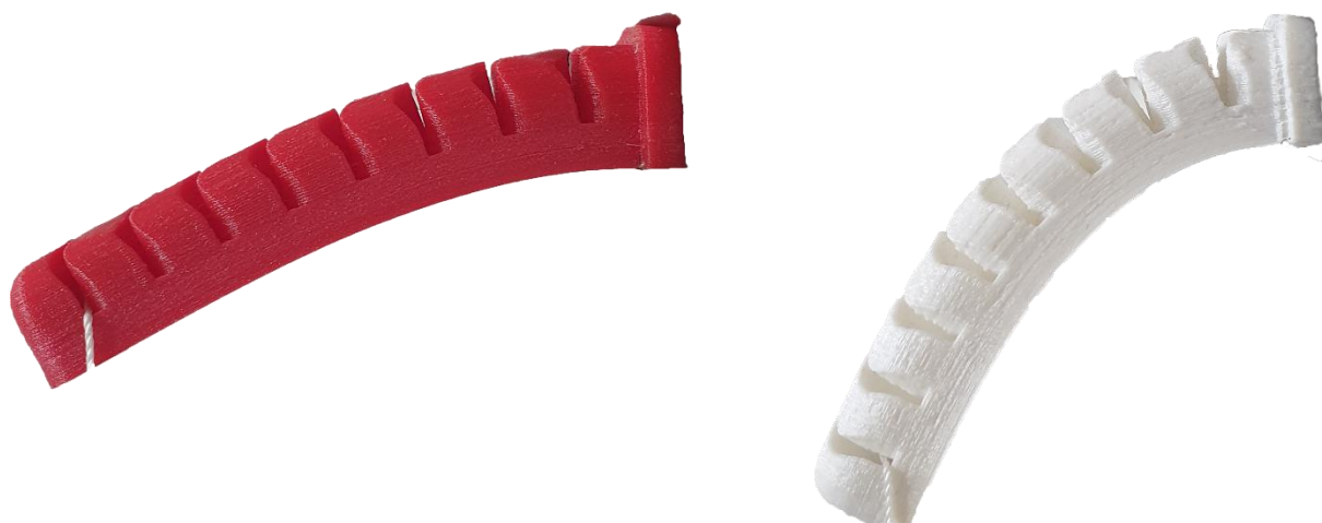
Slika 45. Usporedba fleksije NinjaFlex (lijevo) i Filaflex (desno)
