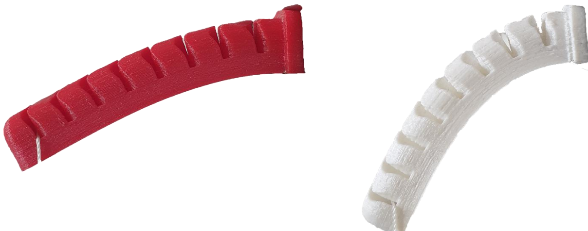
Slika 45. Usporedba fleksije NinjaFlex (lijevo) i Filaflex (desno)
