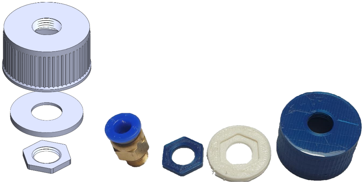
Slika 57. 3D model čepa (lijevo), isprintani dijelovi (desno)
