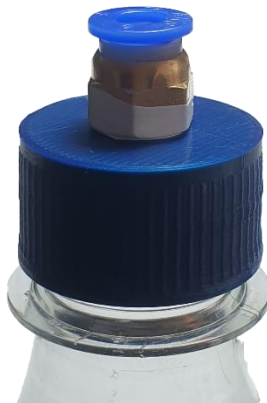
Slika 58. Gotov čep s pneumatskim priključkom
