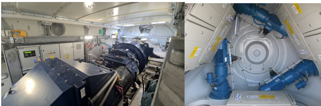
Slika 2.7. Unutrašnjost gondole (lijevo) [9] i glave rotora (desno) [10]
