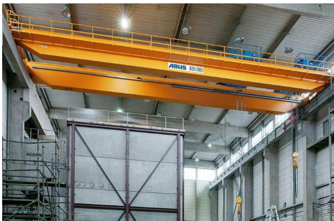
Slika 1 Primjer mosnog granika u industrijskom pogonu [1]
