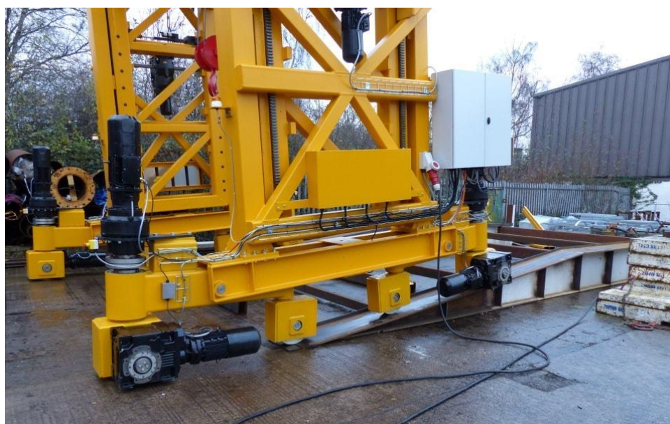
Slika 9 Samohodni portalni granik s mehanizmom za skretanje [5]
