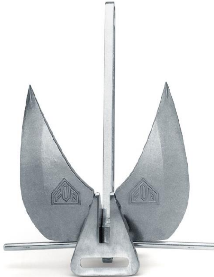
Slika 2. Ribarsko sidro nastalo gravitacijskim lijevanjem AlSi7Mg legure u pješčani kalup [7]
