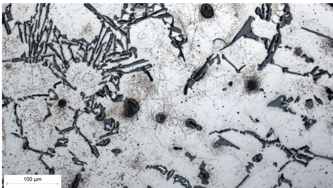
Slika 50. Nagrižena mikrostruktura prvog baznog uzorka
