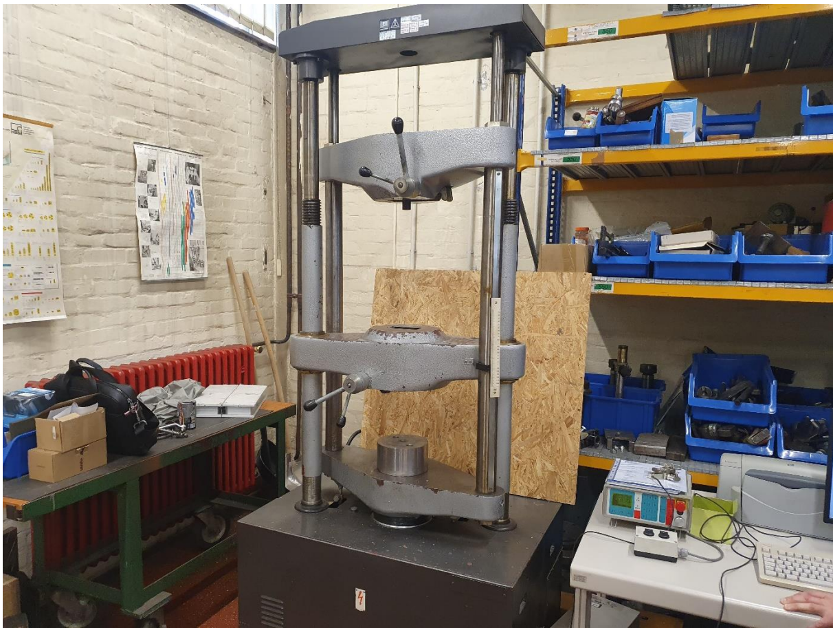
Slika 38. Kidalica Werkstoffprufmaschinen EU 40 mod
