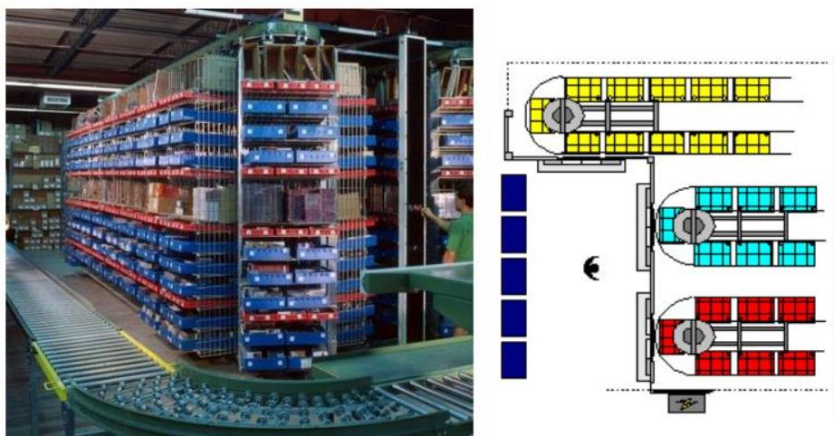
**Slika 35. Komisioniranje prema principu „roba čovjeku“ [29]**
