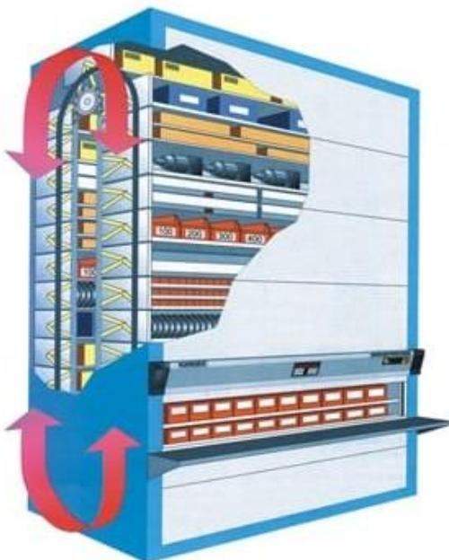
Slika 39. Vertikalni karusel [33]
