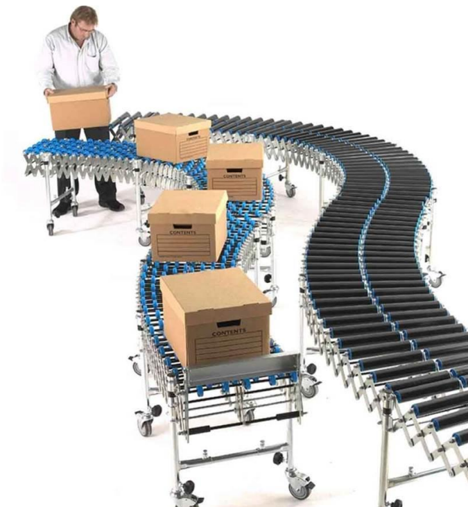
Slika 46. Fleksibilni konvejer za lakše prilagođavanje radnom mjestu [19]
