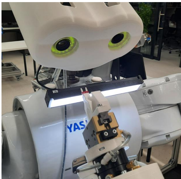
Slika 106. Vizijska inspekcija osigurača
