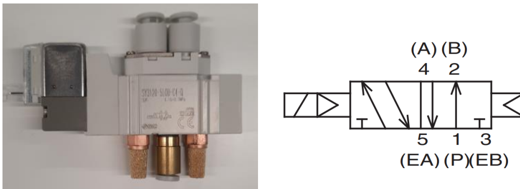
Slika 32. Elektrorazvodnik 5/2 monostabil (lijevo) i njegov simbol (desno)
