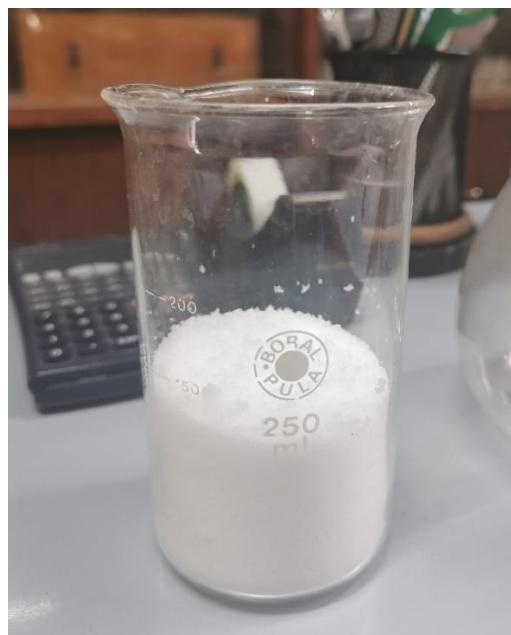
**Slika 10. Granule natrijevog hidroksida prije otapanja u destiliranoj vodi.**
