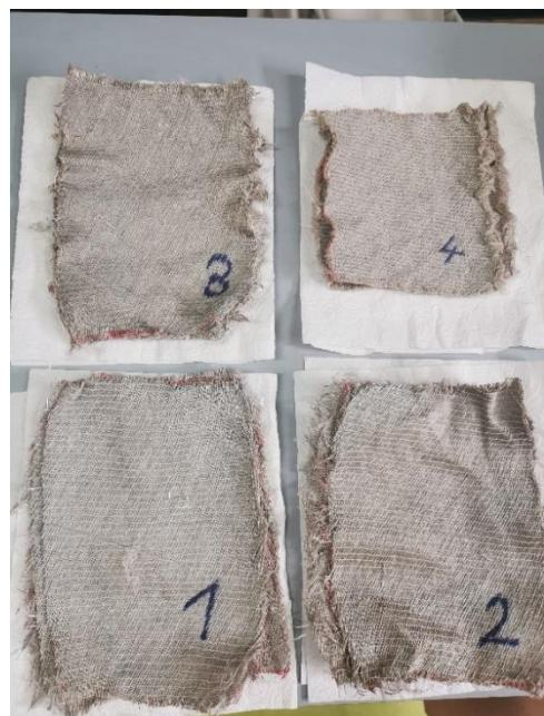
**Slika 12.** Lanena vlakna nakon alkalne obrade i sušenja u peći.
