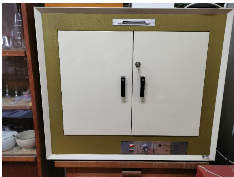
Slika 9. Peć za sušenje lanenih vlakana proizvođača Instrumentaria d.d..
