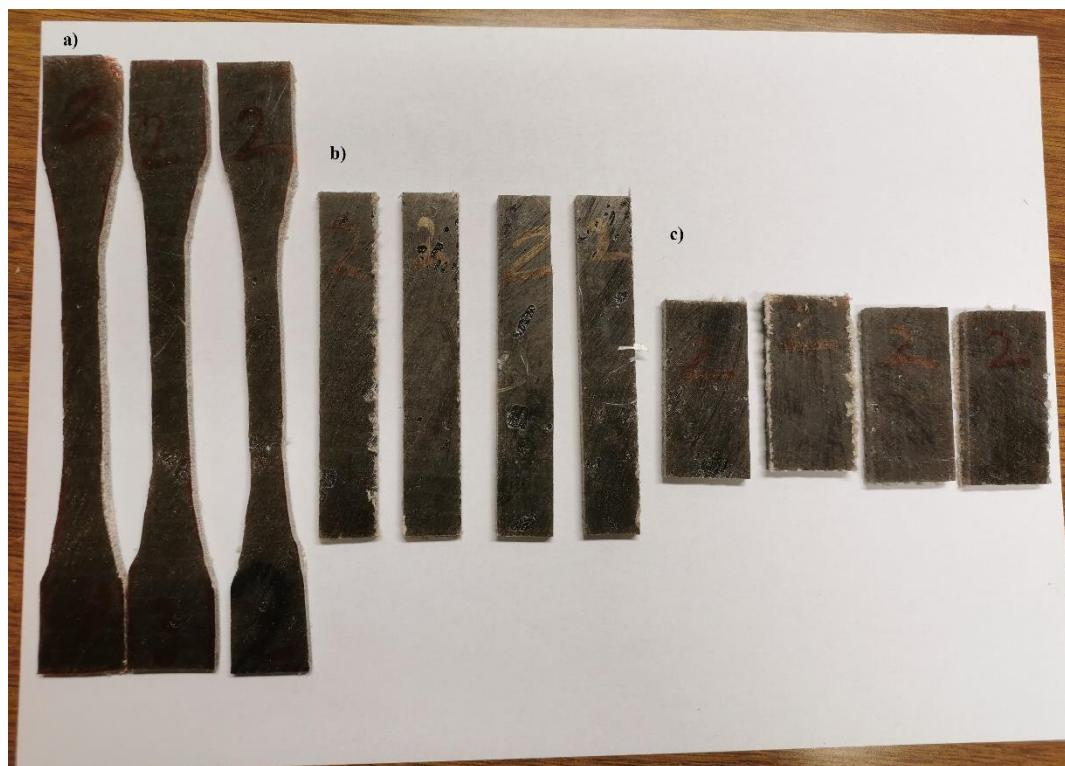
Slika 15. Pripremljeni ispitna tijela; a) epruvete za statičko rastezno ispitivanje, b) epruvete za savojno ispitivanje, c) epruvete za ispitivanje prividne međuslojne smične čvrstoće.
