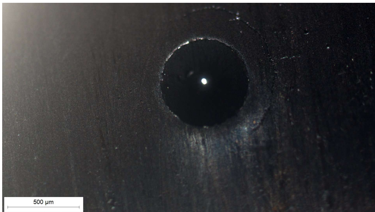
Slika 32. Mjesto ispitivanja prionjivosti prevlake na prstenu P4
