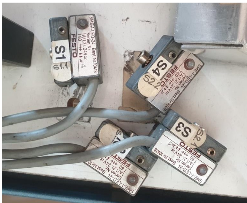
Slika 13. Induktivni senzori za poziciju klipa SME-1-LED-24
