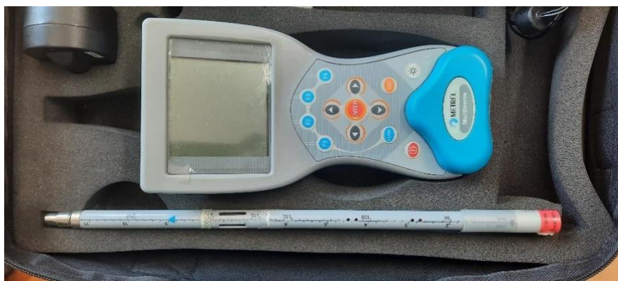
Slika 10. Metrel MI 6201 sa mjernom sondom
