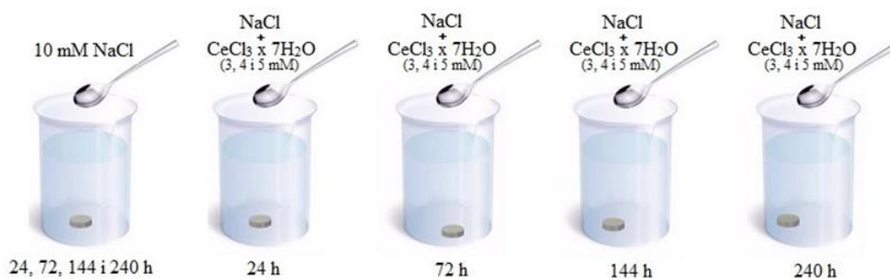
Slika 63. Prikaz ispitnih uzoraka uronjenih u odgovarajuće ispitne otopine
