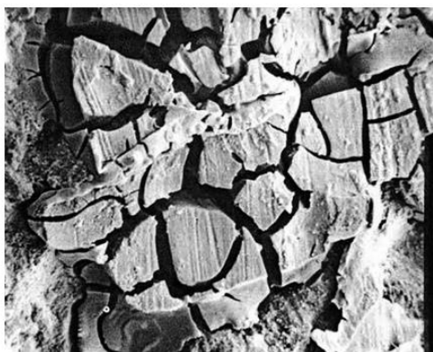
Slika 26. Izgled korodirane aluminijske površine u slanoj vodi pri sobnoj temperaturi ( \text{AlOHCl} , \text{AlOHCl}_2 ) [35]
