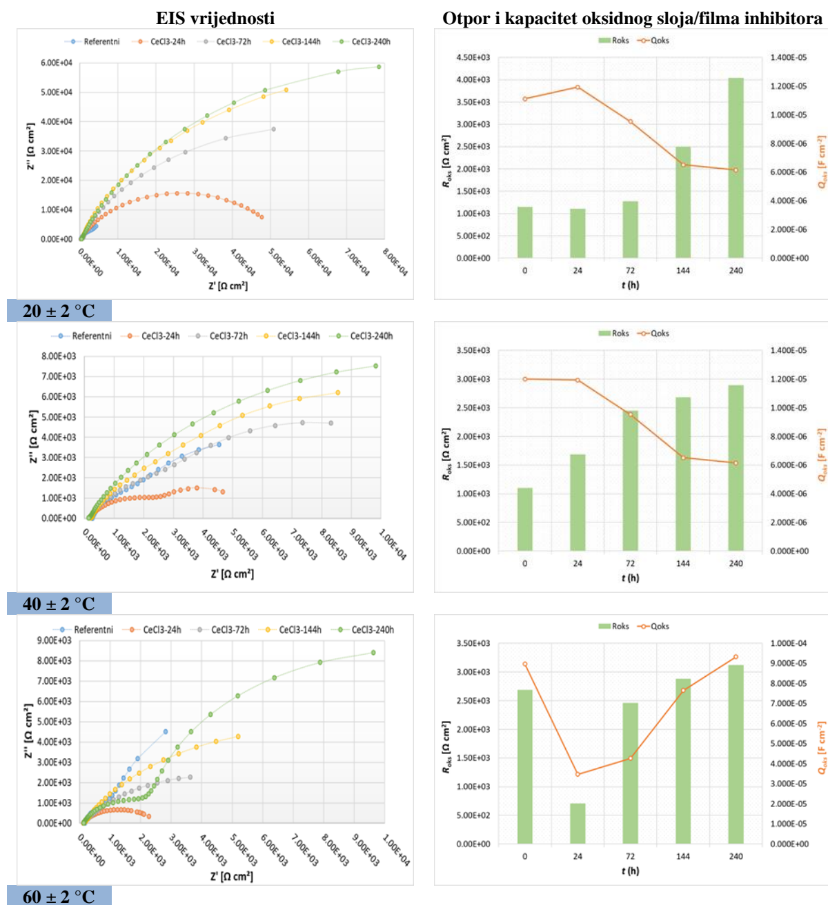
Slika 94. Nyquistov prikaz EIS eksperimentalnih vrijednosti inhibiranih i neinhibiranih uzoraka (lijevo); numeričke vrijednosti oksidnog sloja/filma inhibitora, otpora oksidnog sloja/filma inhibitora i kapaciteta električnog dvosloja (desno) nakon uranjanja u aeriranu 10 mM vodenu otopinu bez inhibitora i s inhibitorom (3 mM)
