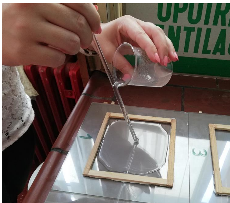
Slika 5.5 Lijevanje otopine u stakleni kalup
