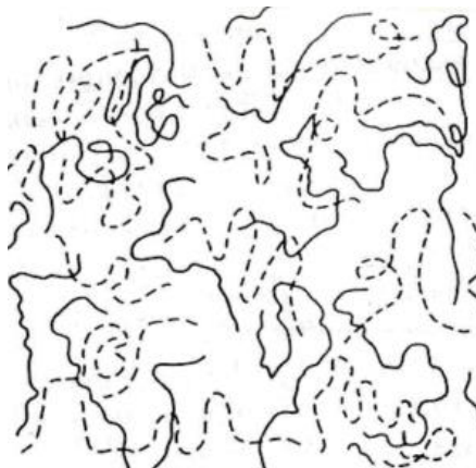
Slika 3.2 Potpuno mješljiva polimerna mješavina (polimer A – puna linija; polimer B – isprekidana linija) [128]
