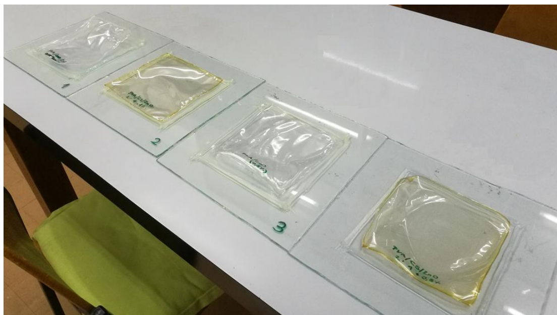
Slika 5.3 Polimerni filmovi dobiveni na staklenom kalupu sa silikonskim okvirom
