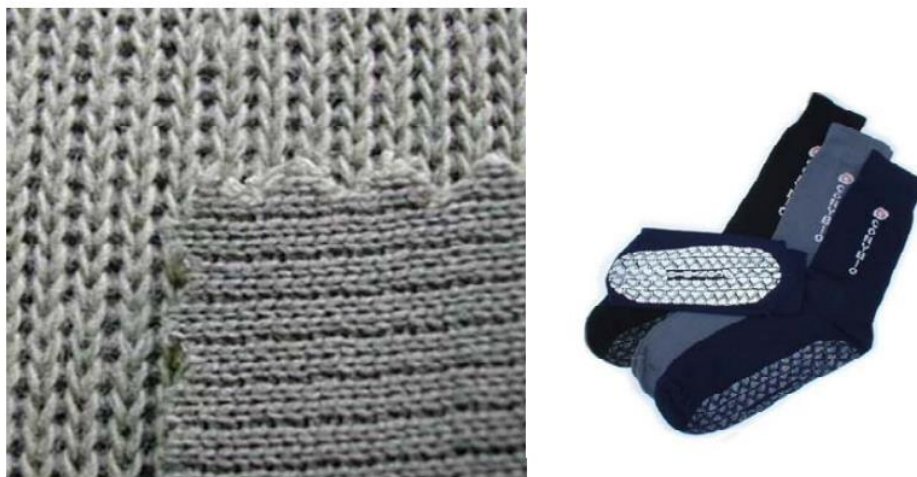
Slika 2.17 Hitozan vlakna i čarape napravljene od tih vlakana [63]
