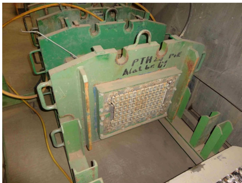
Slika 36. Kompletan alat za ekstrudiranje opekarskih proizvoda
