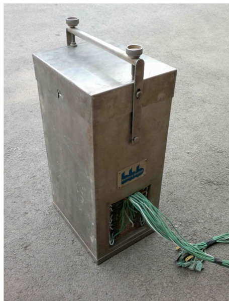
Slika 47. Zaštitno kućište Bacher&Schmidt
