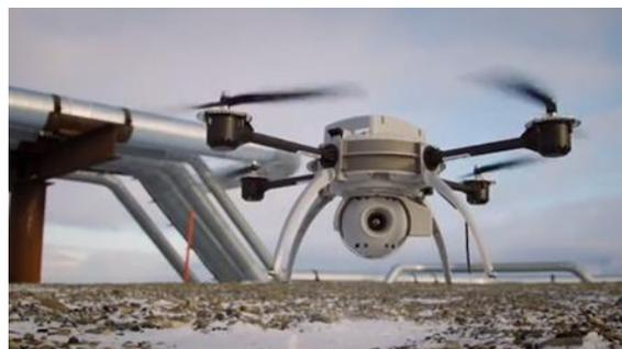
**Slika 10.9 Dron s instaliranom kamerom i GPS sustavom navođenja [45]**
