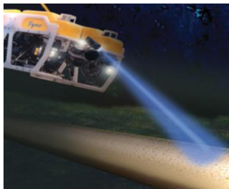
Slika 10.15 Daljinski upravljana podmornica sa ugrađenim flourometrom [45]
