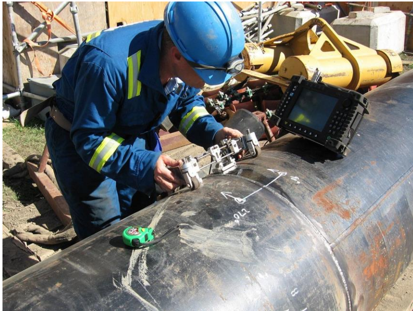
Slika 6.9 Uređaj za ultrazvučnu kontrolu zavara s magnetnim kotačićima [75]
