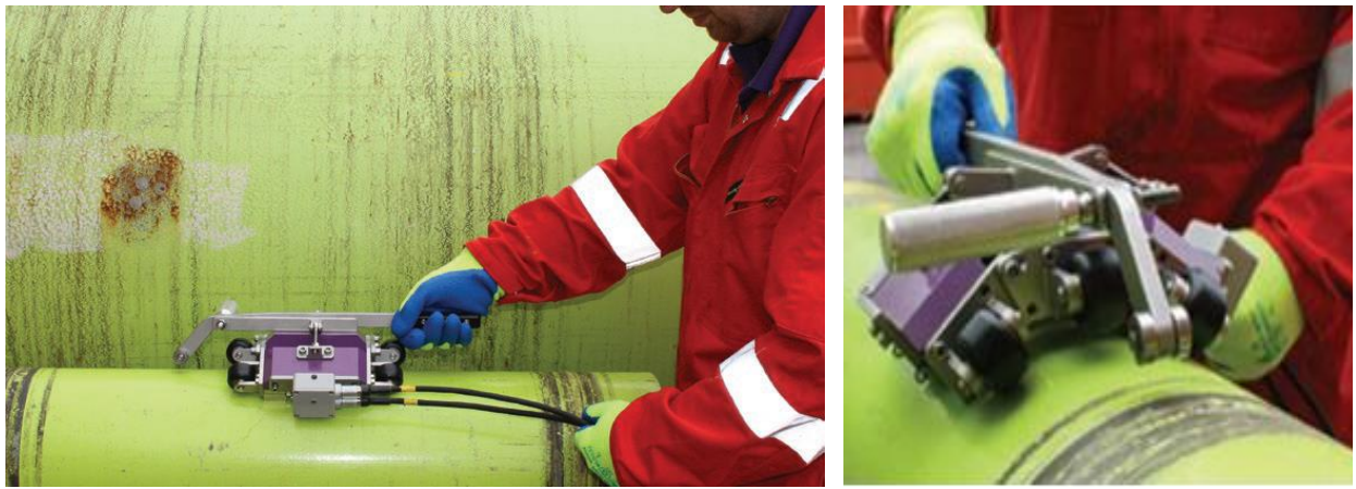
Slika 6.10 Ispitivanje MFL metodom [76]
