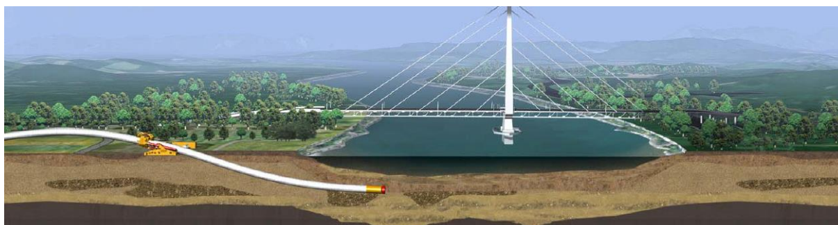
Slika 3.13 Horizontalno usmjereno bušenje [67]
