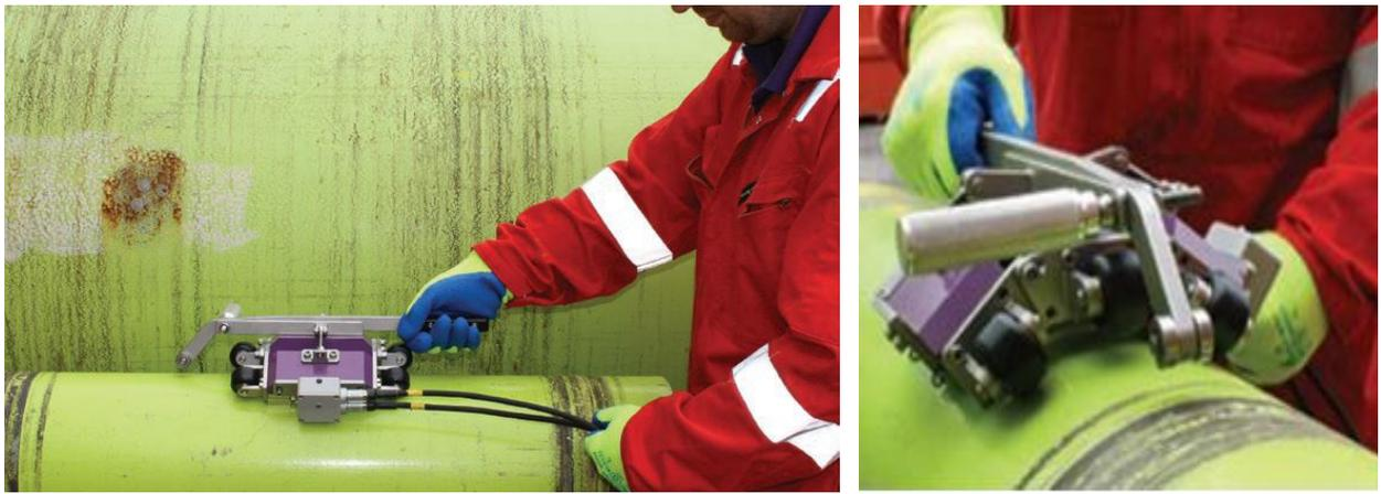
Slika 6.10 Ispitivanje MFL metodom [76]
