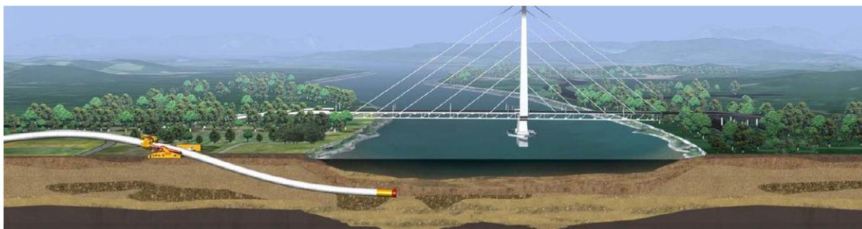
**Slika 3.13 Horizontalno usmjereno bušenje [67]**
