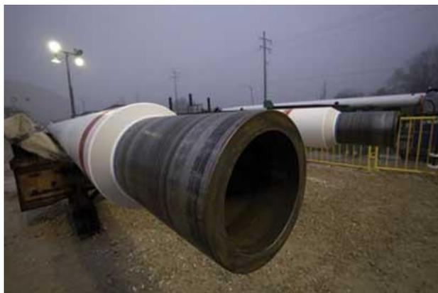
**Slika 4.8 Kraj cijevi otežane betonskim prstenom [68]**
