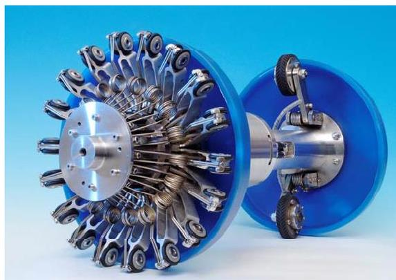
Slika 6.11 "In-line" uređaj za mjerenje geometrije [46]
