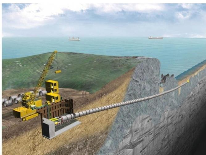
**Slika 3.16 Profil horizontalno usmjerenog bušenja [67]**
