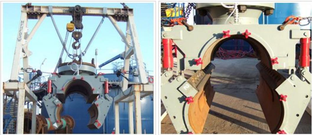
Slika 7.15 Primjer podvodne ESR obujmice prije ugradnje [59]
