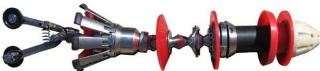
Slika 6.15 Elektro – mehanički uređaj za detekciju promjene geometrije [78]
