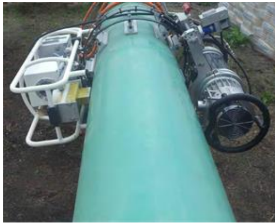
Slika 6.3 Uredaj za radiografsko ispitivanje [73]
