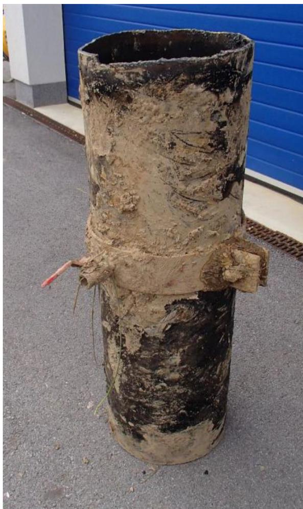
**Slika 10.18** Odstranjen komad cijevi s ilegalno montiranim priključkom FG [33]
