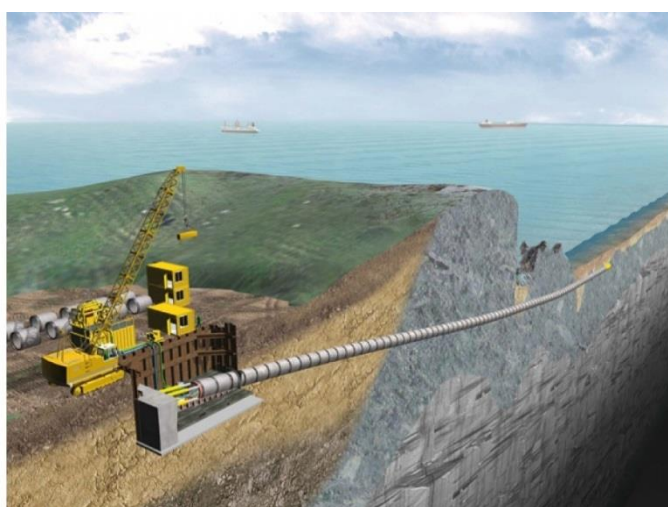
Slika 3.16 Profil horizontalno usmjerenog bušenja [67]
