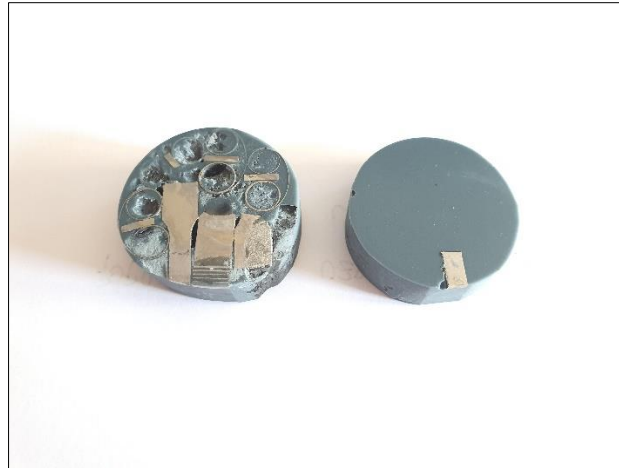
Slika 27. Prikaz ispitnih uzoraka ulivenih u polimernu masu
