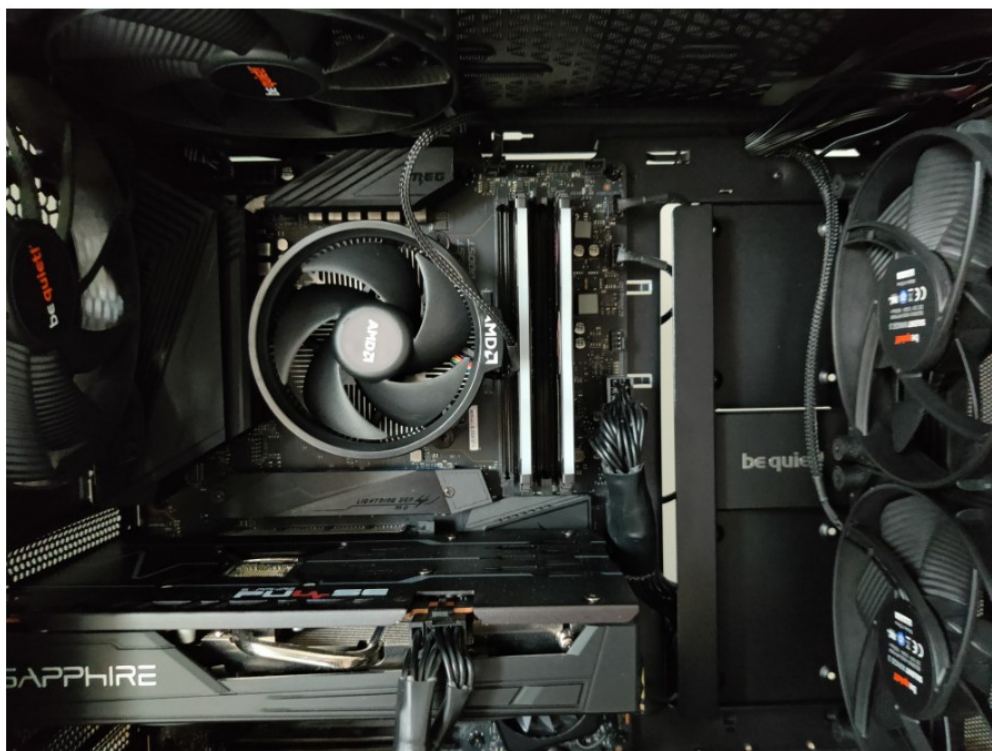
Slika 78. Položaj hladnjaka Wraith u kućištu
