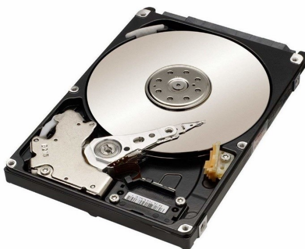
Slika 20. Tvrđi disk bez kućišta [14]
