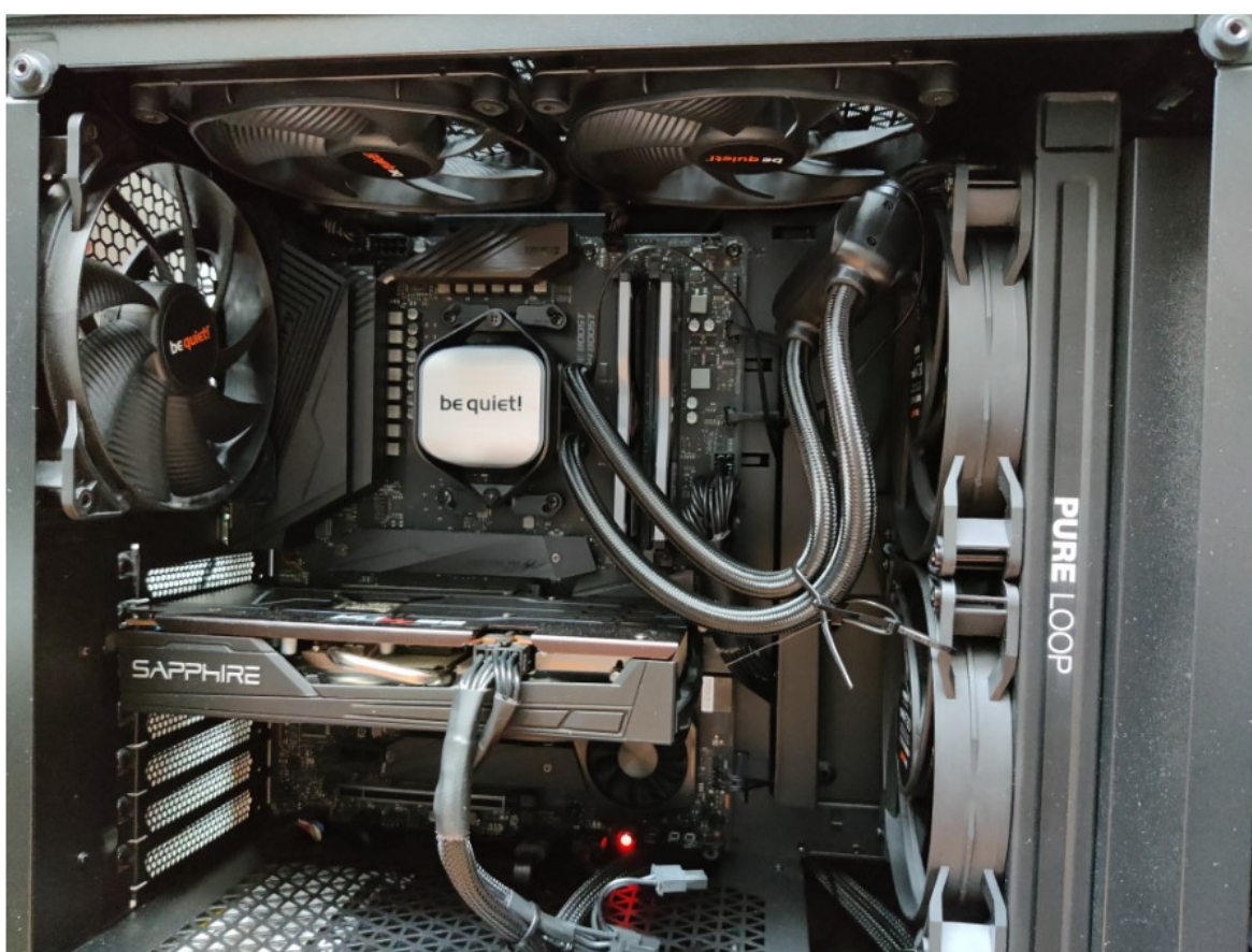
Slika 84. Položaj Pure Loop hladnjaka u kućištu
