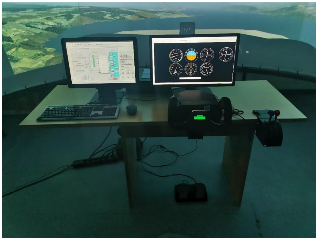
Slika 33. Upravljačke komande sa pilotskim(desno) i instruktorskim zaslonom(lijevo)
