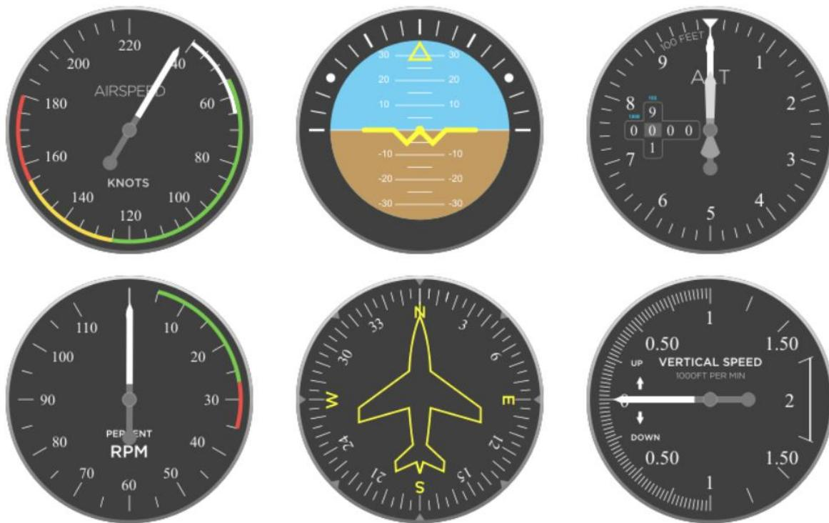
Slika 37. Prikaz instrumenata na zaslonu ispred pilota
