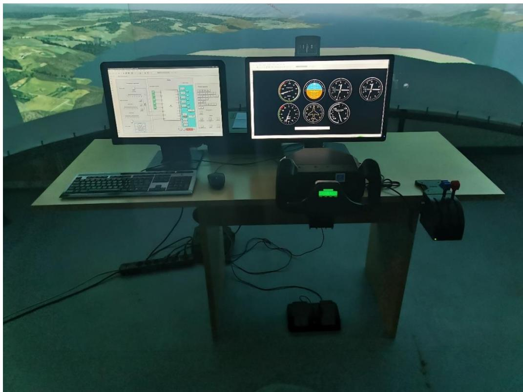
**Slika 33. Upravljačke komande sa pilotskim(desno) i instruktorskim zaslonom(lijevo)**
