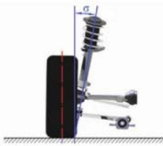
**Slika 4.1 Bočni nagiba osi zakreta kotača [1]**
