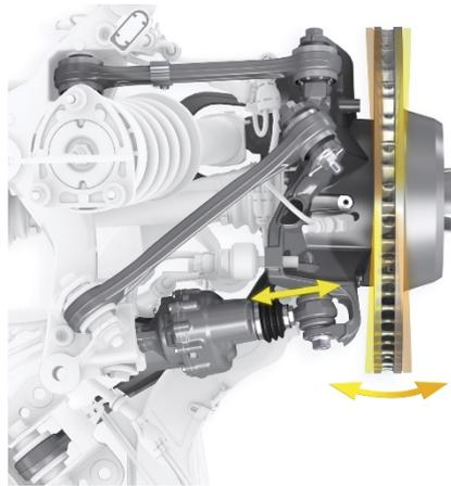
**Slika 4.10** Izvedba mehanizma s neovisnim zakretom stražnjih kotača [11]
