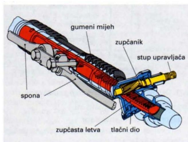
Slika 4.5 Sklop zupčaste letve i zupčanika [1]
