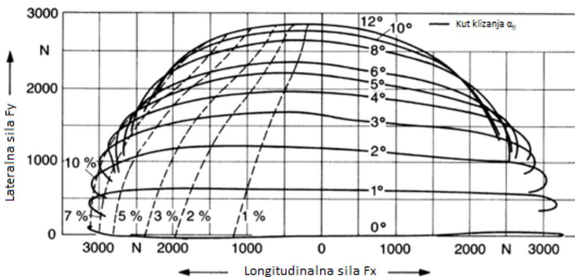
Slika 2.15 Elipsa trenja za trkači pneumatik [2]
