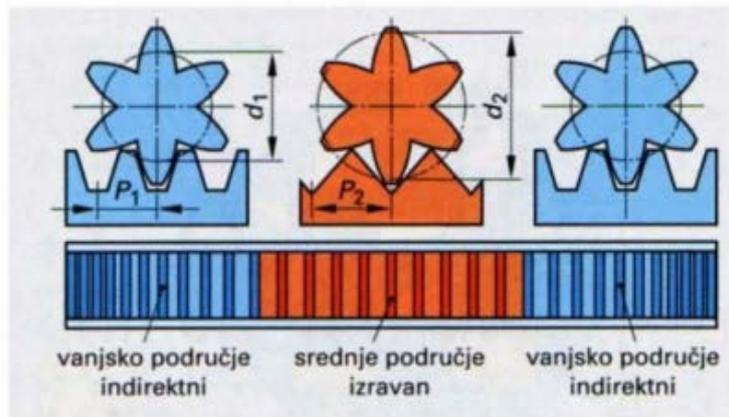
Slika 4.6 Zupčasta letva s promjenjivim omjerom [1]
