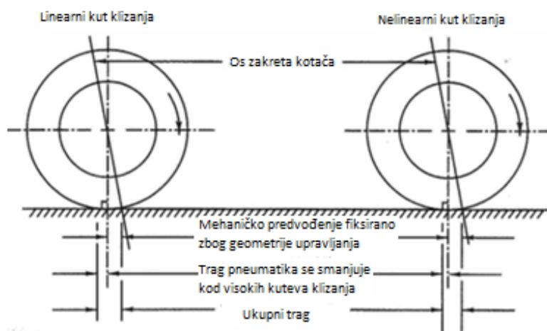
Slika 2.13 Prikaz mehaničkog predvođenja te traga pneumatika [3]
