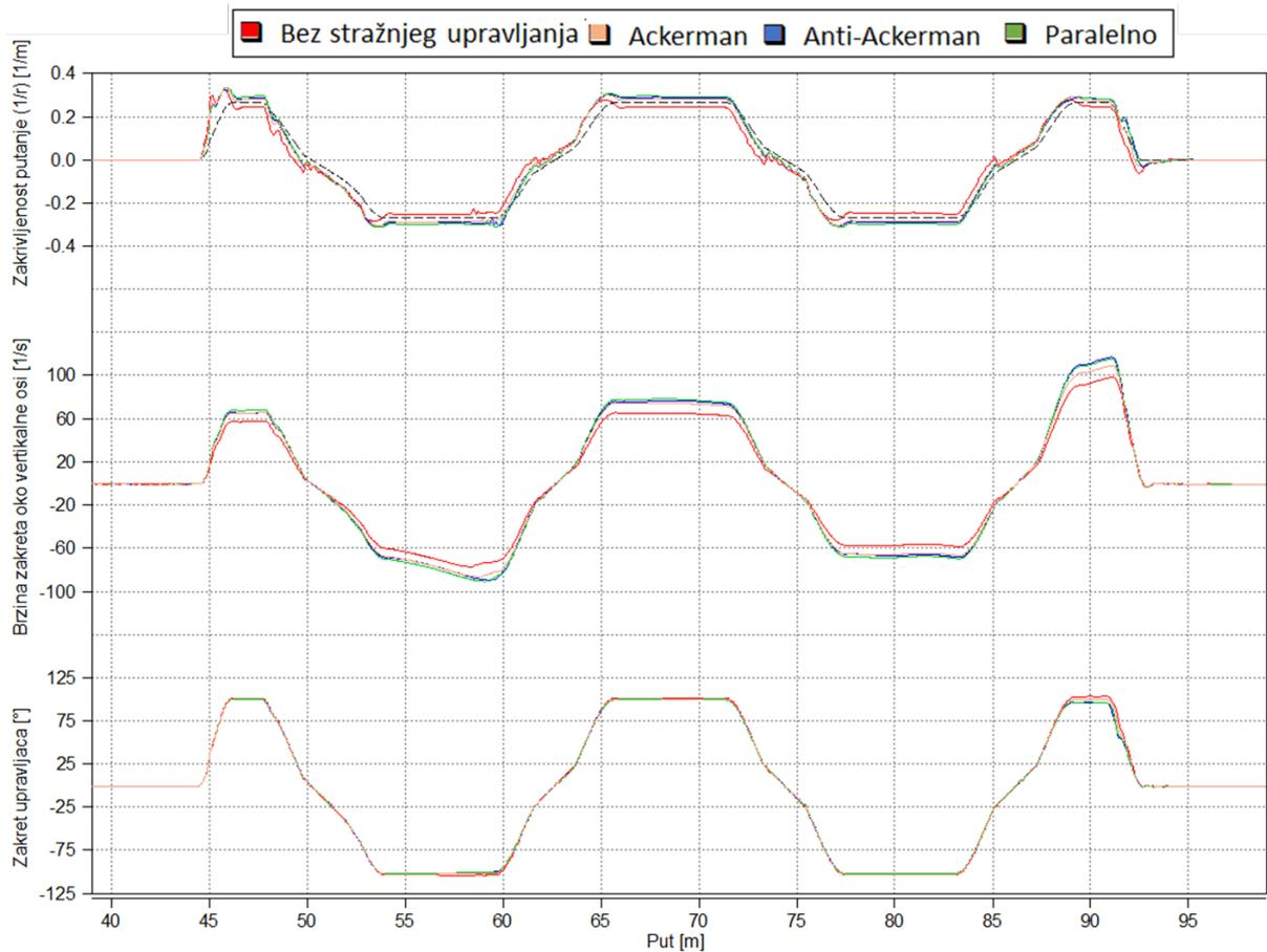
**Slika 9.7 Rezultati procedure Slalom s minimalnim razmakom čunjeva**
