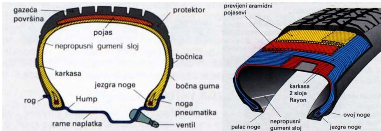
Slika 2.2 Konstrukcija modernog radijalnog pneumatika [1]
