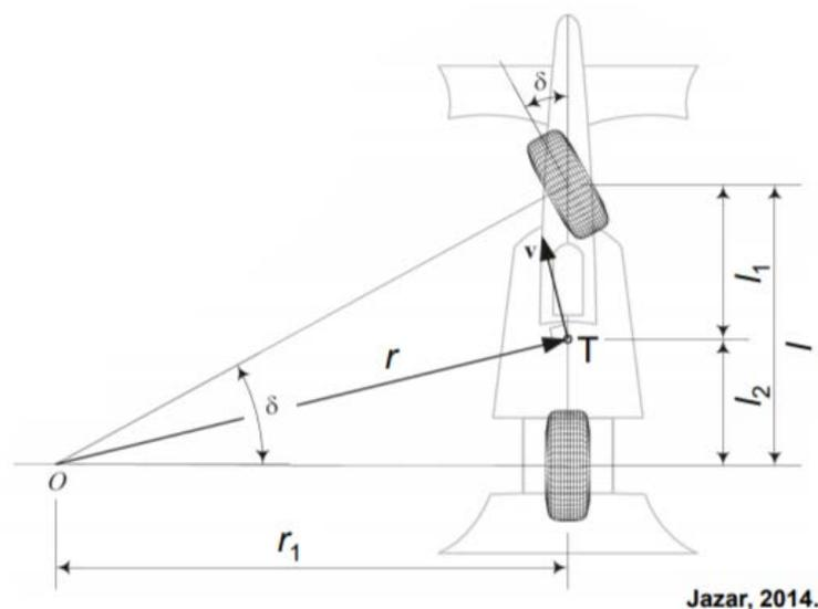
Slika 3.1 Model vozila s jednim tragom kotača [5]
