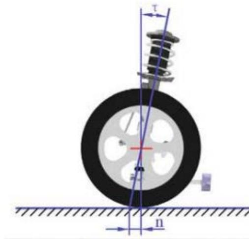
**Slika 4.2 Uzdužni nagib osi zakretanja kotača [1]**
