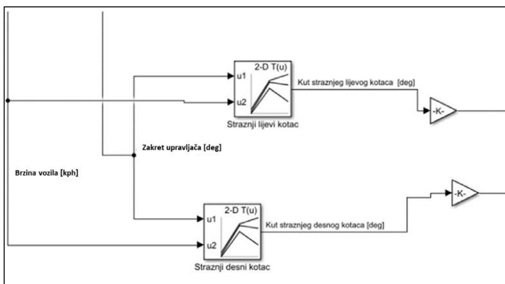
**Slika 9.2 Simulink model za upravljanje sa stražnjim kotačima**
