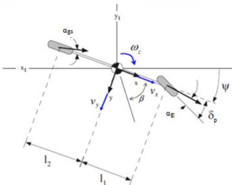
**Slika 3.2 Model vozila s jednim tragom kotača kod djelovanja lateralne sile [6]**
