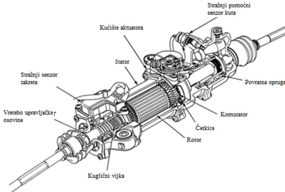
**Slika 4.9 Elektromehanički aktuator za upravljanje zakretom stražnjih kotača [8]**
