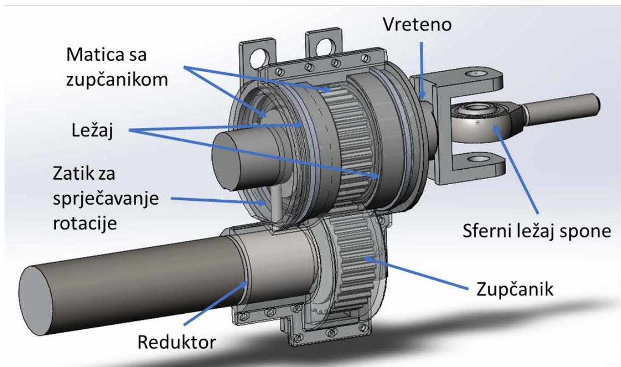
**Slika 6.8 Lateralni koncept 1 s prozirnim kućištem**
