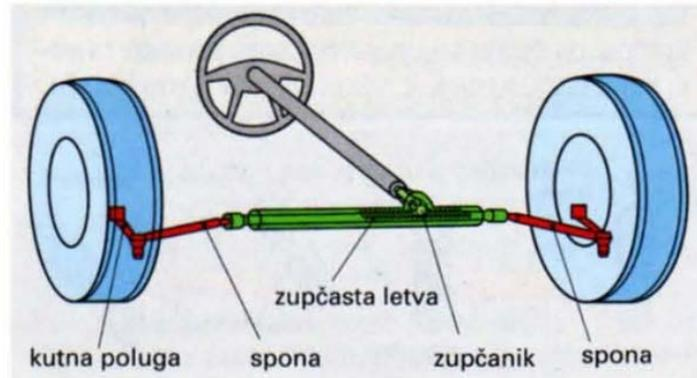
Slika 4.4 Upravljački sustav sa zupčastom letvom [1]
