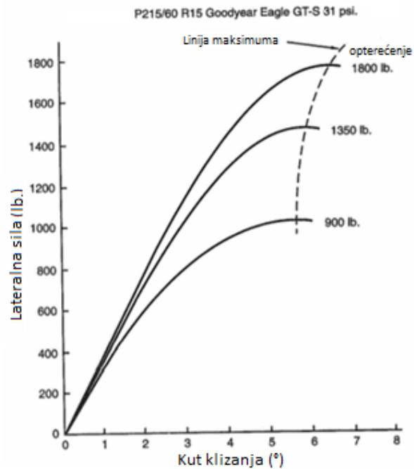
**Slika 2.9 Odnos lateralne sile i kuta bočnog klizanja s obzirom na vertikalno opterećenje [3]**
