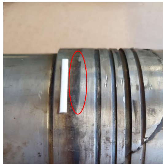
Slika 29. Segment B, sektor A, blago oštećena površina
