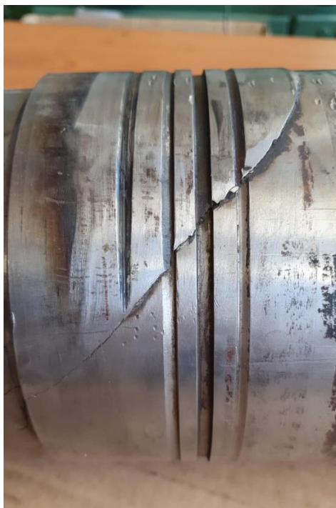
Slika 18. Urezi po opsegu vratila
