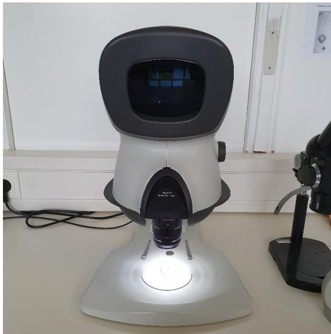
Slika 52. Stereomikroskop Mantis Elite
