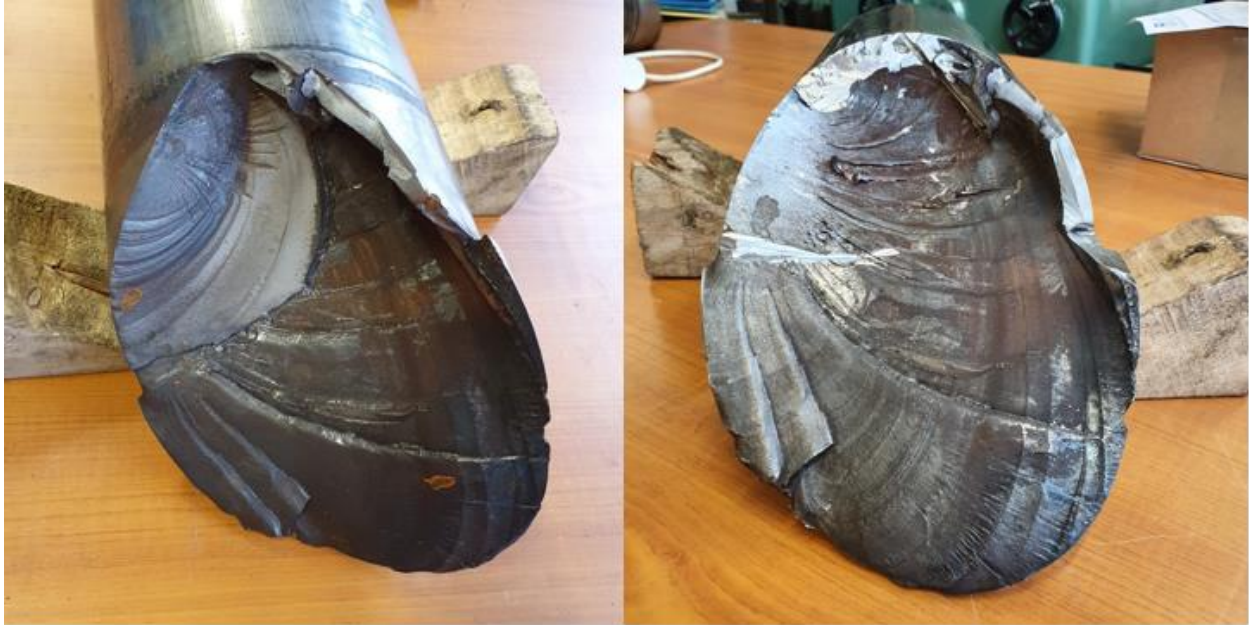
Slika 45. Prijelomna površina segmenta A prije i poslje rezanja
