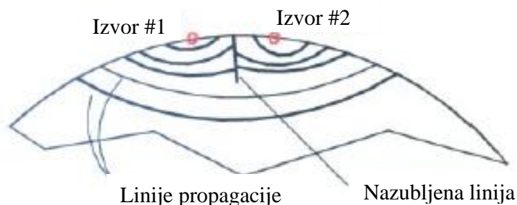
Slika 8. Nazubljena linija između dva izvora pukotine [3]
