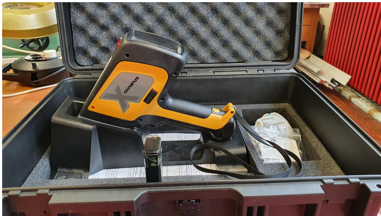
Slika 38. Olympus XRF analizator
