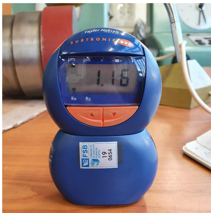
Slika 22. Prijenosni mjerač hrapavosti Taylor Hobson Surtronic DUO
