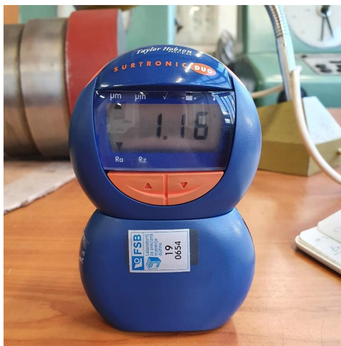
Slika 22. Prijenosni mjerač hrapavosti Taylor Hobson Surtronic DUO
