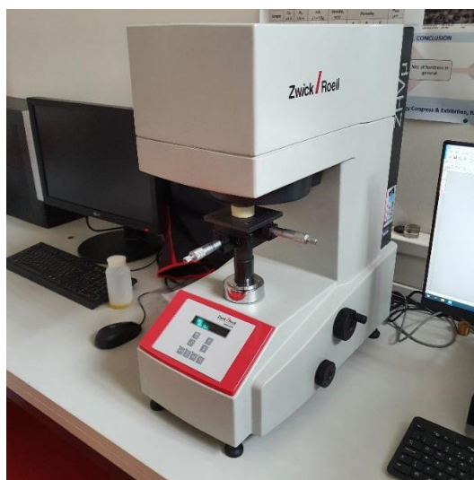
Slika 69. Zwick/Roell ZHV \mu tvrdomjer
