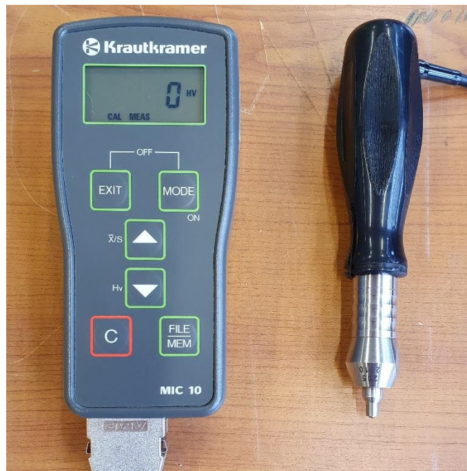
Slika 32. Prijenosni tvrdomjer Krautkramer
