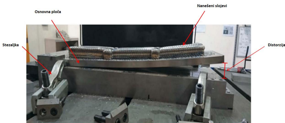
Slika 9. Deformacija uslijed velikog unosa topline [11]
