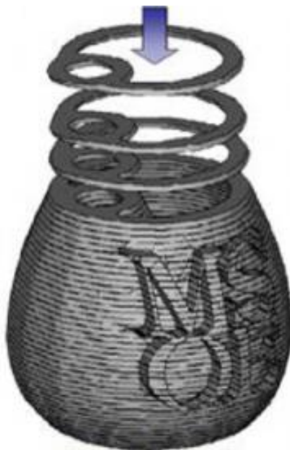
Slika 1. CAD model proizvoda izrađenog aditivnom proizvodnjom [2]
