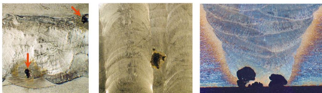
Slika 19. Primjeri rupičaste korozije TIG zavarenog spoja [21]
