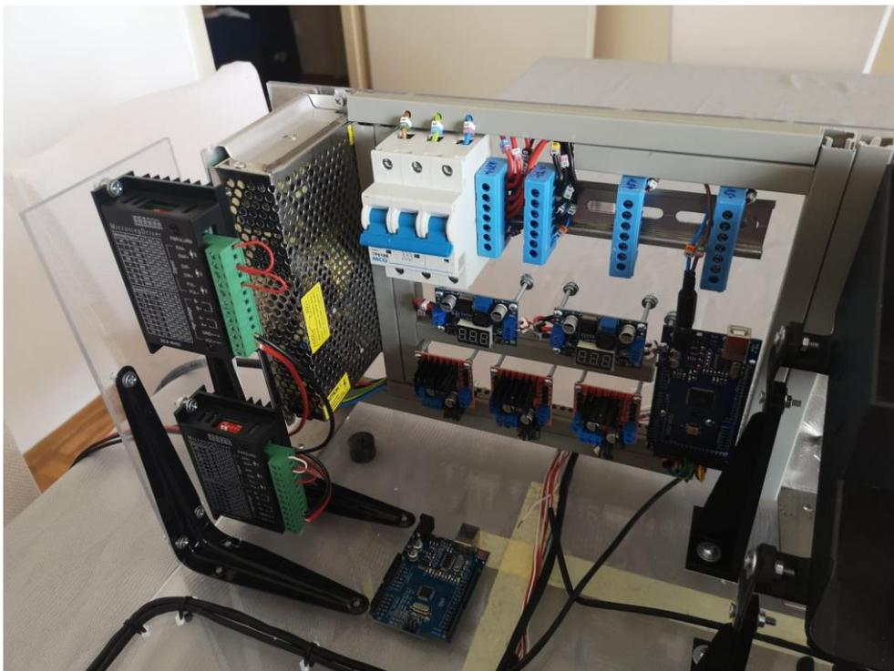
**Slika 47. Upravljački ormar pri postavljanju drugog mikrokontrolera**
