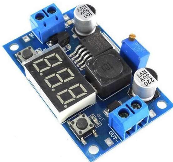
Slika 40. Pretvarač istosmjernog napona [14]
