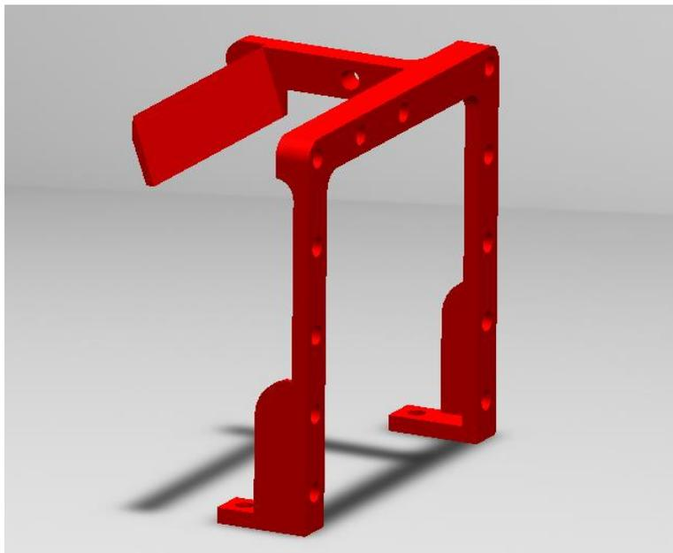
**Slika 29. Kostrukcija ograde za pozicioniranje obradka na transportnoj traci**
