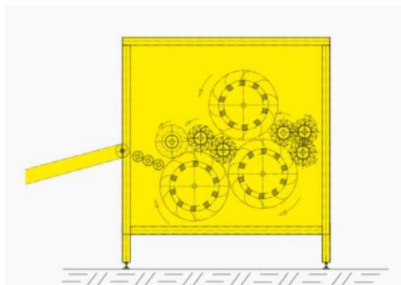
Slika 21. Prikaz poprečnog presjeka Bunch-Picking SZ uredja [42]
