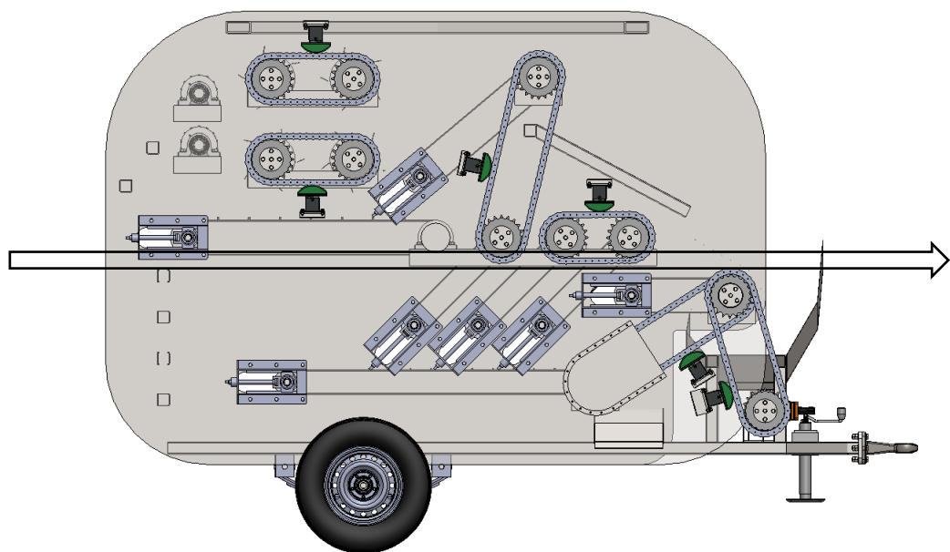
**Slika 78. Slijed montaže uređaja [46]**
