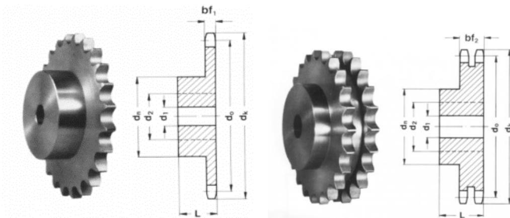
**Slika 43. Lančanik 24B-1 (lijevo), lančanik 24B-2 (desno); DIN 8187 [12]**
