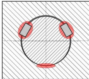
**Slika 49. Ekscentrično sjedanje glavine i vratila nakon uklanjanja s dodirom u tri točke**
