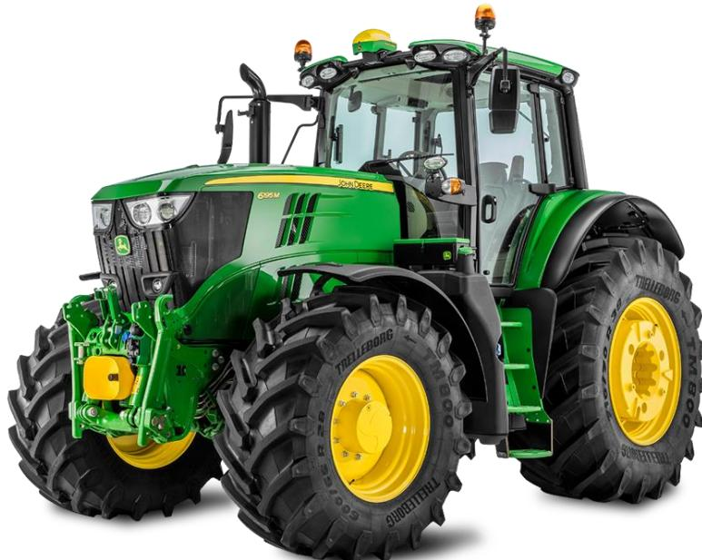
Slika 6. Dvoosovinski traktor s pogonom na sva četiri kotača [25]
