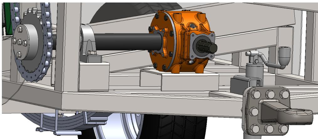
**Slika 72.** Prijenosnik uređaja za obradu hmelja [46]
