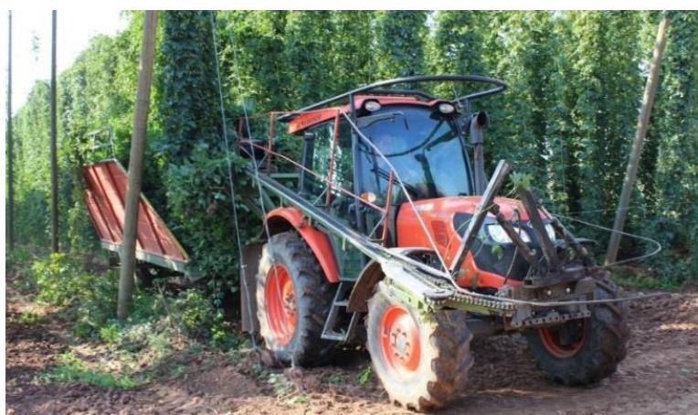
Slika 4. Rezanje stabljičke traktorom u Češkoj [26]
