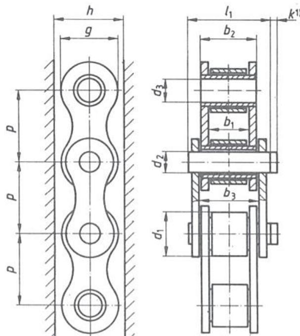
Slika 42. Prikaz lanca prema DIN 8187 [12]
