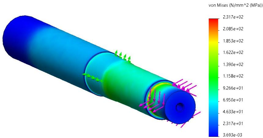
Slika 46. Analiza vratila metodom konačnih elemenata [46]
