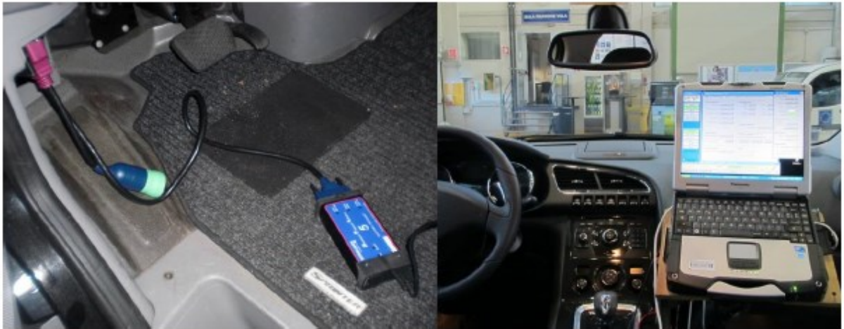
Slika 53. Spoj upravljačke jedinice(ECU) vozila (lijevo) i osigurani laptop koji se spaja na ECU (desno) [23]
