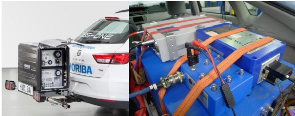
Slika 49. Osigurane glavne jedinice PEMS-a na kuki vozila (lijevo) i unutar vozila (desno) [23]
