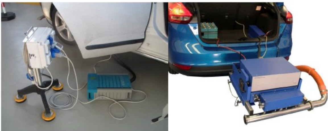
Slika 54. Punjenje baterije (lijevo) i sigurno smještena baterija u prtljažniku vozila (desno) [23]
