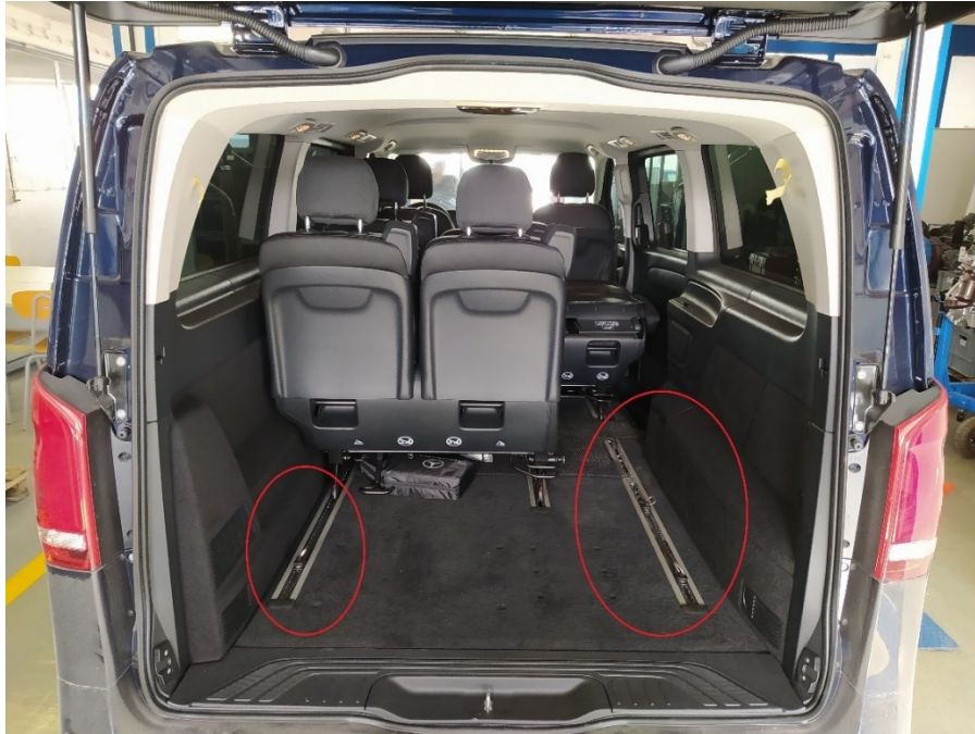
Slika 125. Pogled kroz stražnja vrata Mercedes-Benz Vito Tourer -a i položaj vodilica na podu vozilu
